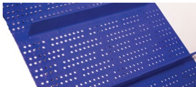
Las bandas Flat Top perforadas de orificio redondo de la serie 800 tienen un área abierta del 14 %.
