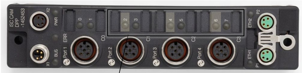
LED 2-7: 在 ARB S7000/7050 的技术应用中, LED 2, 4, 6 被使用.
