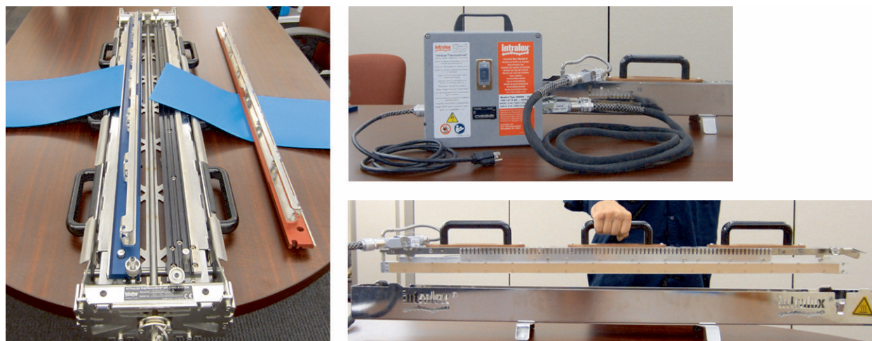
Figura 19: Sistema di giunzione ThermoDrive V2 e componenti
