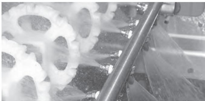
**Figura 120:** El diseño del pulverizador se ha ideado para limpiar la parte inferior de la banda, los engranajes y el eje.
