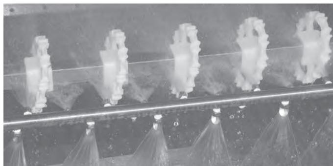
Figura 119: Sistema de limpieza incorporado (CIP) EZ Clean™
