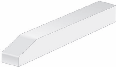
Şekil 35: Aşınma şeridi ucu pahı
