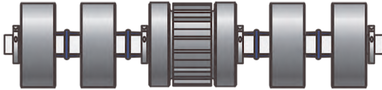
Şekil 1: Aralıklı dişli/destek disk (6 inç geniş kare-göbekli dişli)
