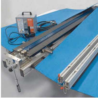
Şekil 23: ThermoDrive® Streamline Yapıştırma Seti ve bileşenleri
