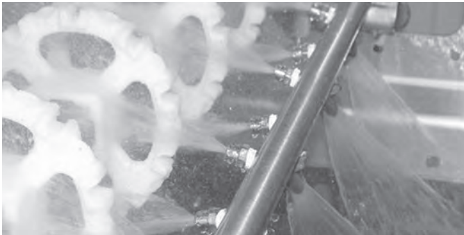
Şekil 120: Püskürtme yapısı, bandın alt tarafının, dişlilerin ve milin temizliğini sağlayacak şekilde tasarlanmıştır
