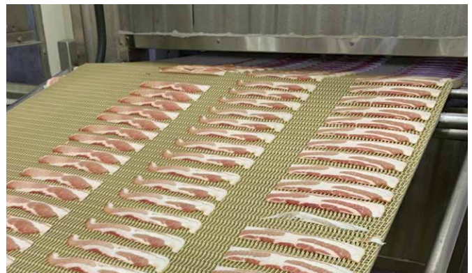
Esteira S900 Raised Rib com Borda para serviços pesados da Intralox
