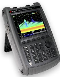
Keysight N9952B | FieldFox 微波组合分析仪; 300 kHz到 50 GHz
