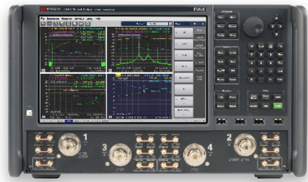
Keysight N5245B | PNA-X 微波网络分析仪， 900 Hz/10 MHz 到 50 GHz
