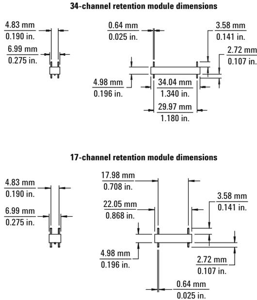
Figure 5.7. Retention module dimensions
