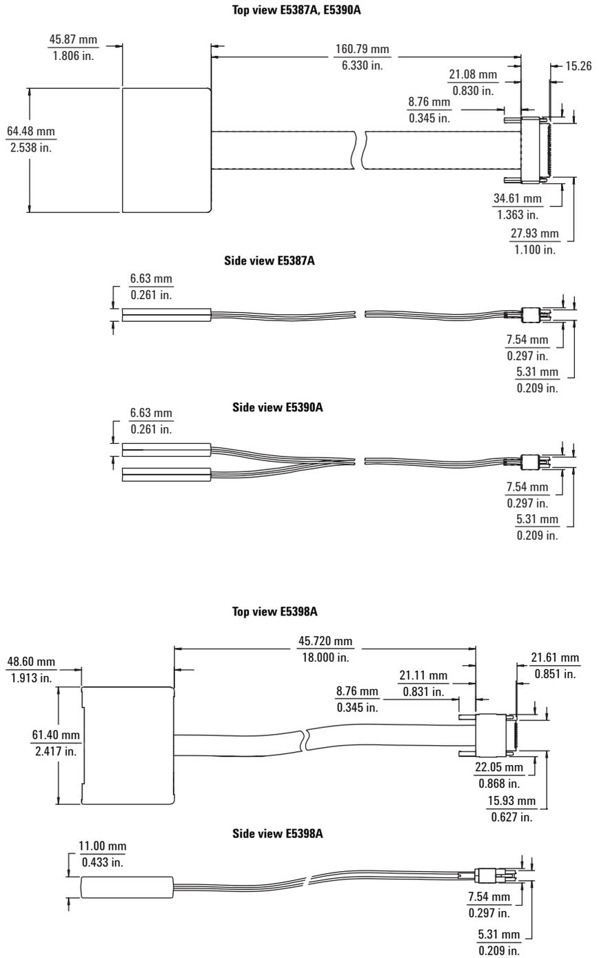
Figure 8.10. Probe dimensions
