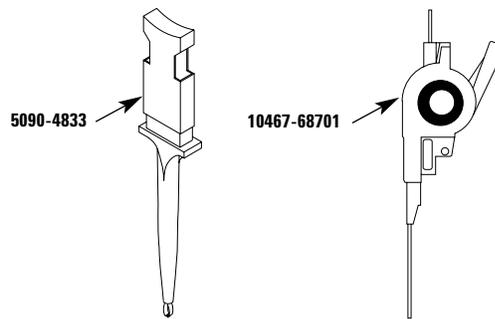
Figure 4.5. SMD IC clip and 0.5 mm IC clip
