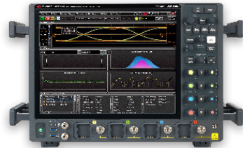
Keysight UXR0594B | Infiniium UXR系列示波器；59 GHz 4通道 256 GSa/s 实时采集
