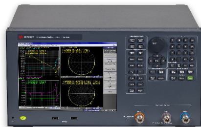
Keysight E4991B | 阻抗分析儀；1 MHz至3 GHz
