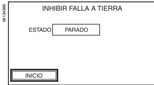
Figura 51: Pantalla de desactivación “Inhibir falla a tierra”
