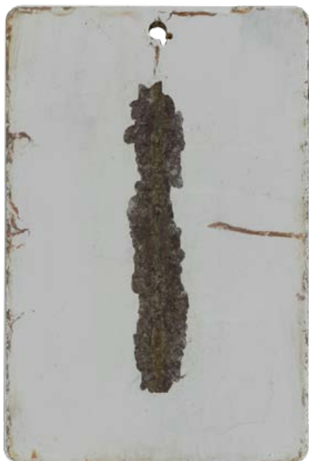
1-kerrosmaali 720 tunnin jälkeen (Neutraali suolasumu testi)
