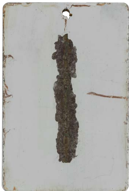
System jednowarstwowej farby nawierzchniowej po 720 godz. testu w obojętnej mgłę solnej
