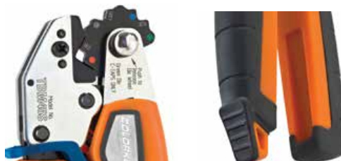
L'appendice Crimp-Assist™ assure la stabilité quand un effet de levier est désiré pour comprimer les plus gros connecteurs.
