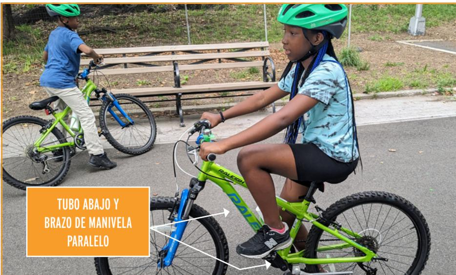
Idealmente, la biela debería estar paralela al tubo inferior de la bicicleta, o aproximadamente a las dos en punto. Esto se llama posición del pedal de potencia porque le da al ciclista la máxima propulsión hacia adelante desde un punto muerto.
