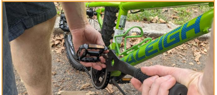
**Nota:** El pedal izquierdo tiene una rosca inversa y se atornilla en dirección opuesta al pedal derecho. Dicho esto, lo siguiente se aplica a ambos pedales: cuando mires el pedal desde arriba, gira hacia atrás para aflojar y hacia adelante para apretar.
