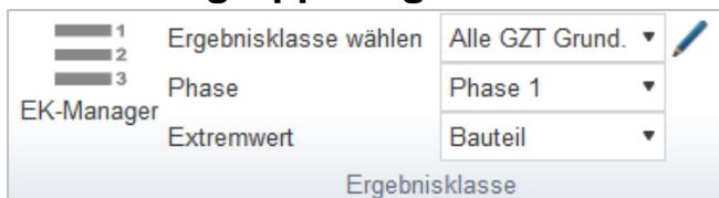
Einstellen der aktuellen Ergebnisklasse und der Bauphase zur Auswertung der Ergebnisse für das aktuelle Bemessungsbauteil:
