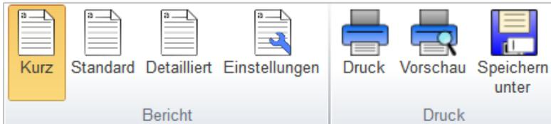
Ein Bericht für alle Bemessungsbauteile kann im Navigator unter **Projektdaten > Bemessungsbauteile** erstellt werden. Verwenden Sie zum Arbeiten mit Berichten die Untergruppen **Bericht** und **Druck**.
