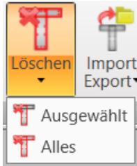
Einstellungsmöglichkeiten in der Untergruppe **Löschen** zum Löschen von Bewehrung aus Querschnitten:
