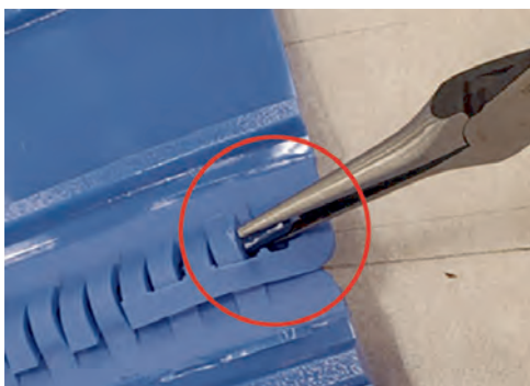
図 15: ロッドエンドとキャプティブリンクの間にプライヤーを入れてからロッドを引っ張ることも可能
