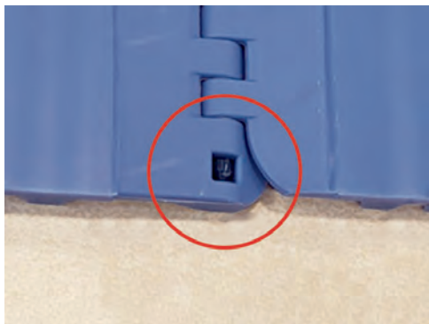
図 7: ロッドエンドが両方の覗き窓から見えることを確認
