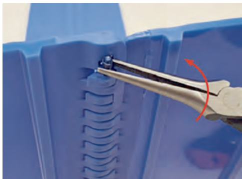
図 12: 圧力を保持したままプライヤーを反時計回りにひねる
