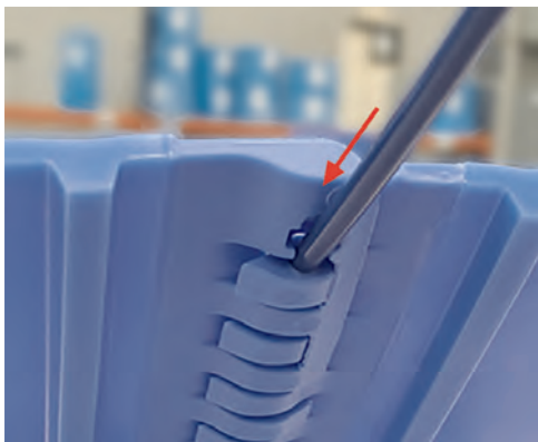
図 3: ロッドを隙間に挿入
