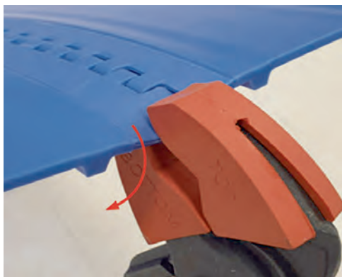
図 6: ベルトエッジを下向きに曲げてロッドエンドを収める
