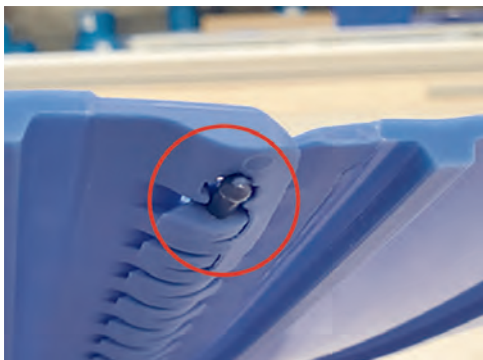
図 4: ロッドエンドがベルトエッジから 0.125 インチで止まっていることを確認
