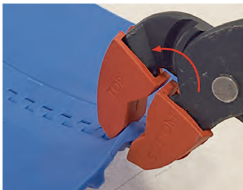
図 9: ベルトエッジを上向きに曲げてロッドエンドを捕らえる
