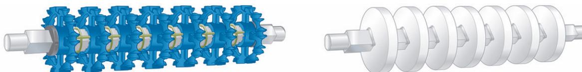
**Figura 25:** Ejes con componentes bloqueados
