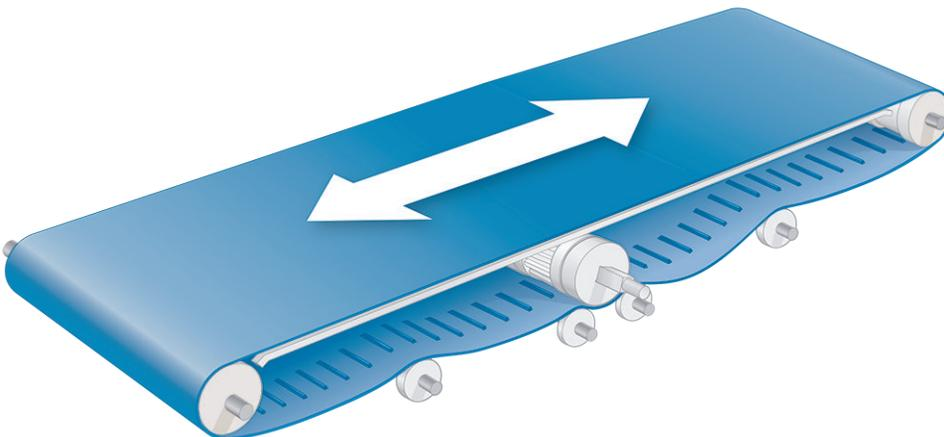
**Figura 70:** Ubicaciones del engranaje motriz central y del limitador de posición
