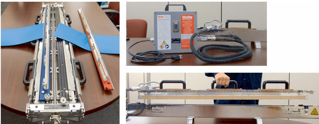
Figura 19: Sistema de uniones térmicas ThermoDrive V2 y componentes
