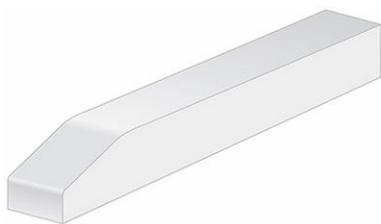
**Figura 64:** Bisel del extremo de la guía de desgaste
