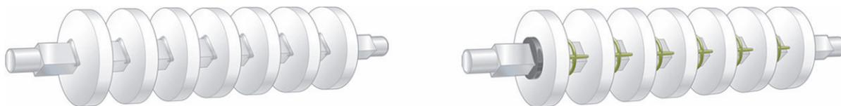
Figura 57: Anillos de retención y separadores de engranajes
