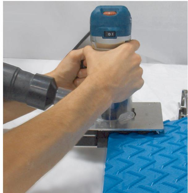
**Figura 22:** Conjunto de herramientas para desbarbar los extremos de las bandas
