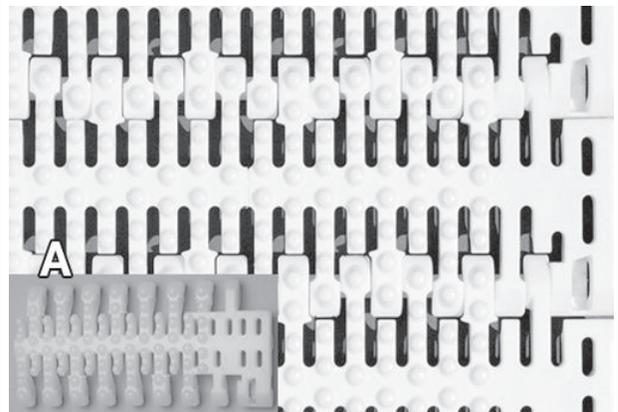
A Einsatz: Kantenmodul aus Polyethylen
