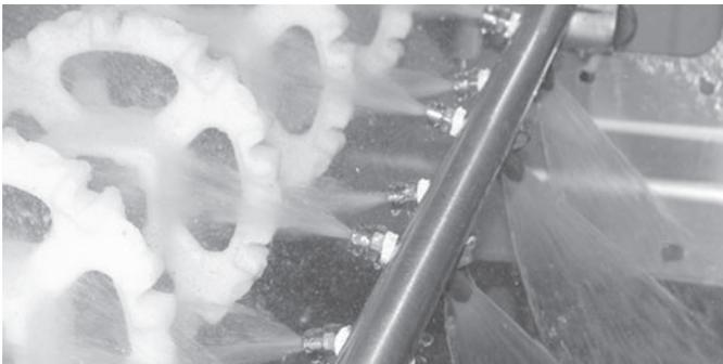
**Abbildung 112:** Spritzbildkonstruktion zur gründlichen Reinigung der Bandunterseite, der Zahnräder und der Welle
