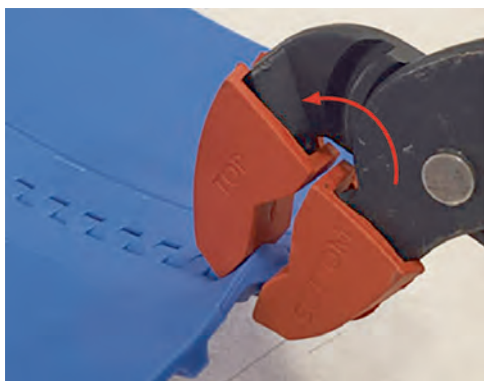
Figura 9: Doble el borde de la banda hacia arriba para capturar el extremo de la varilla
