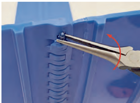
Figura 12: Gire los alicates en el sentido contrario a las agujas del reloj mientras mantiene la presión
