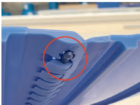
Figura 4: Asegúrese de que el extremo de la varilla se detiene a 0,125 pulg. del borde de la banda
