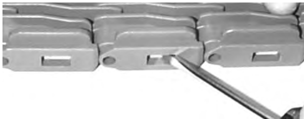
Figuur 48: De Slidelox sluiten
