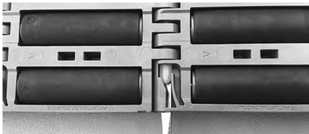
Figuur 242: Duw de scharnieren tot in de scharnierenborging
