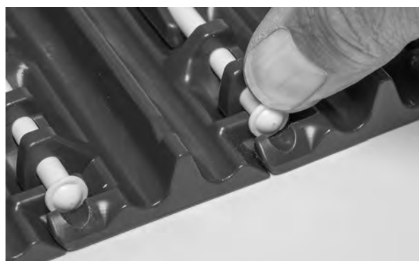
Figuur 94: Scharnierpen tot in scharnierpenborging duwen
