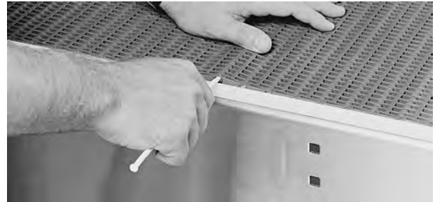
Figuur 21: Scharnierpen plaatsen
