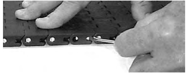
Figuur 166: De Slidelox sluiten
