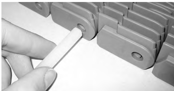
Figuur 216: De scharnierpen in de scharnieren steken
