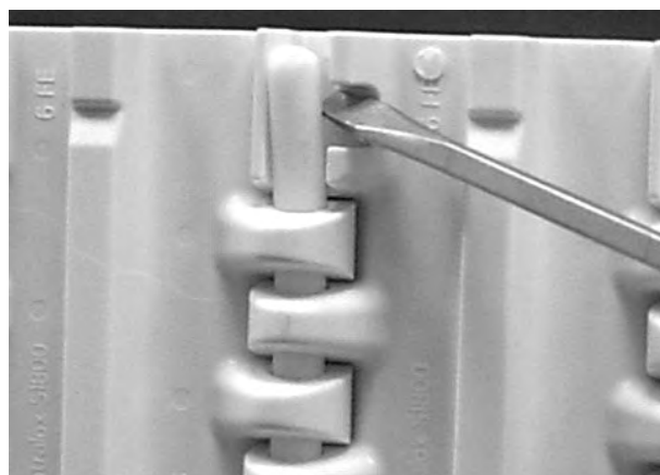
Figuur 207: Scharnierpen uit scharnierpenborging verwijderen
