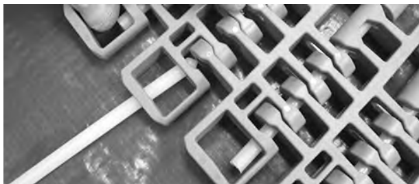
Figuur 342: De scharnierpen in de scharnieren steken
