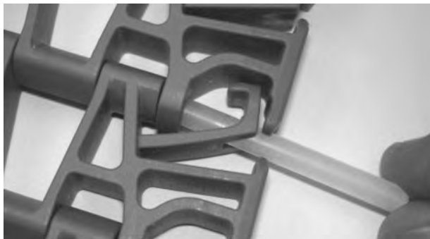
Figuur 251: De scharnierpen in de scharnieren steken
