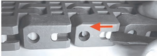
Figuur 159: De Slidelox sluiten
