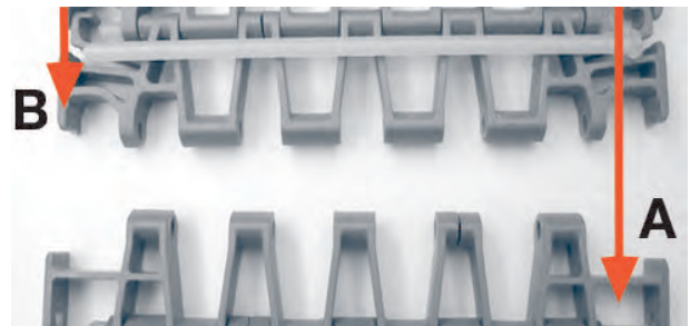
Figuur 259: Nieuwe sectie (B) koppelen met originele sectie (A)
