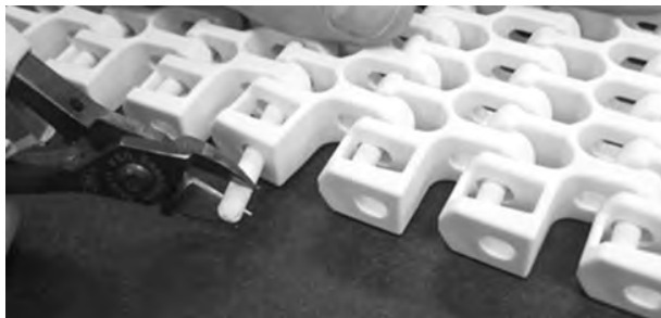
Figuur 296: Scharnierpen uit band trekken
