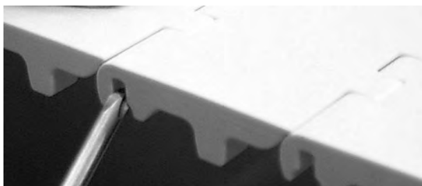
Figuur 205: De scharnierpen tot in de scharnierpenborging duwen
