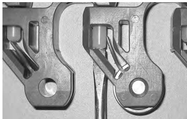
Figuur 305: Duw de scharnierpen tot in de scharnierpenborging
