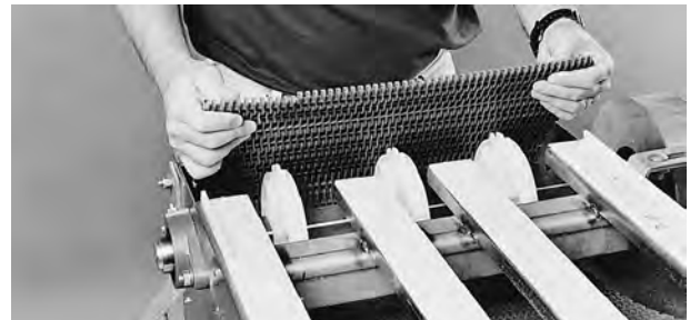
Figuur 17: De band langs het retourpad voeren
