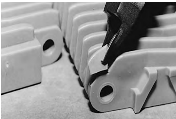
Figuur 53: Buitenste ribbel knippen
