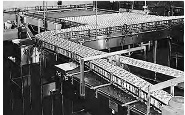
Figuur 23: De steunen over de breedte van de band plaatsen
