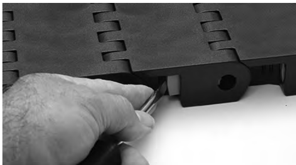
Figuur 261: De Slidelox sluiten
