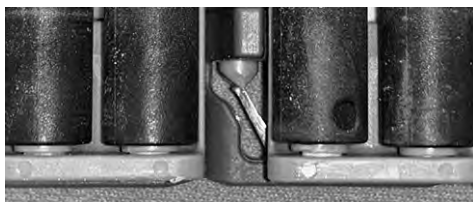
Figuur 249: Controleren of de scharnierpen in de scharnierpenborging zit
