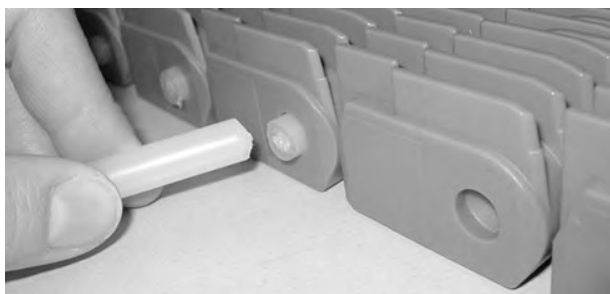
Figuur 217: De scharnierpen in de Shuttleplug duwen
