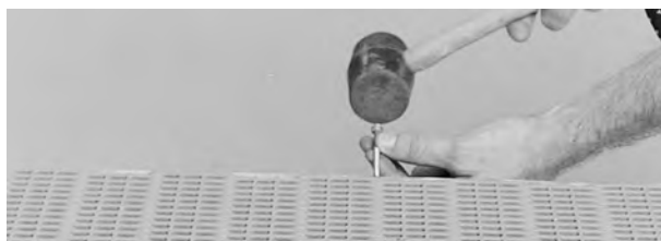
Figuur 38: De scharnierpen uit de band duwen
