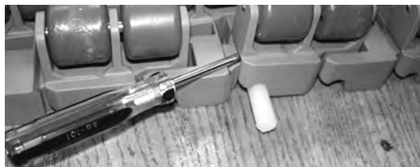
Figuur 196: Scharnierpen uit band trekken
