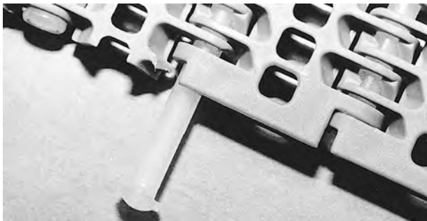
Figuur 34: Breng de scharnierpen in
