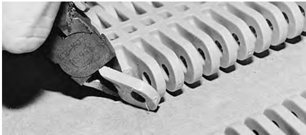
Figuur 52: Buitenste schakel knippen
