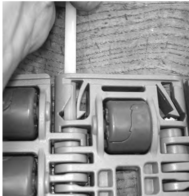
Figuur 222: De scharnierpen uit de band duwen
