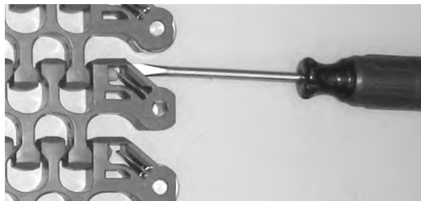
Figuur 303: Scharnierpenborging openen
