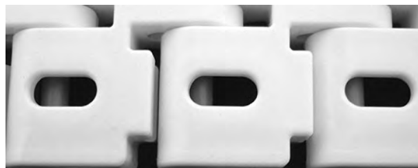
Figuur 289: Controleren of de scharnierpen in de scharnierpenborging zit
