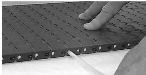
Figuur 162: Breng de scharnieren in
