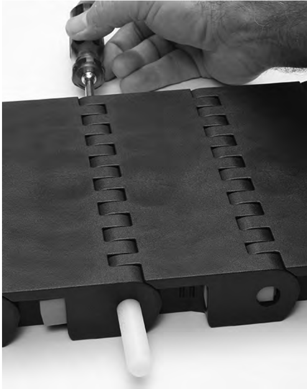
Figuur 264: De scharnierpen uit de band duwen
