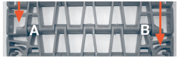
Figuur 258: Controleren of de scharnierpen zich volledig in de band bevindt
