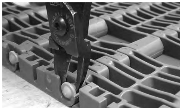
Figuur 273: Scharnierpennetje snijden
