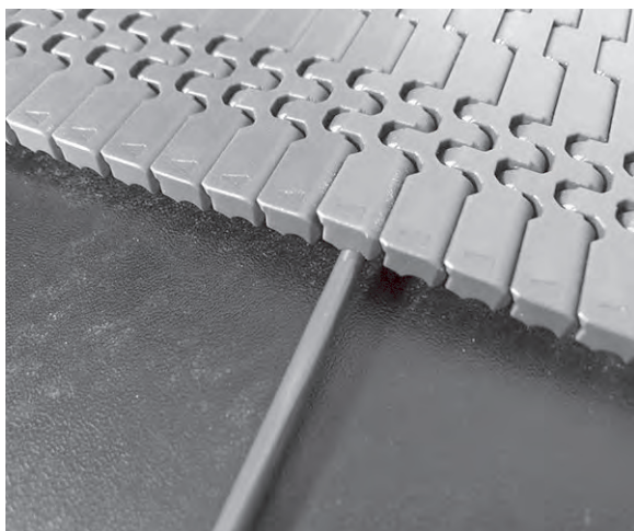
Figuur 59: Scharnieren plaatsen
