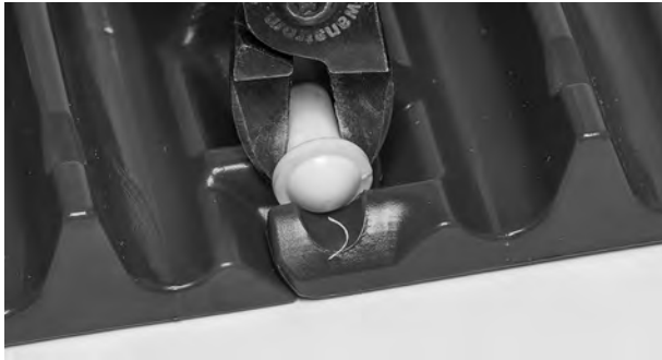
Figuur 96: De kop van de scharnierpen snijden
