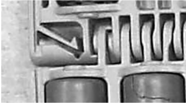
Figuur 224: Controleren of de scharnierpen in de scharnierpenborging zit
