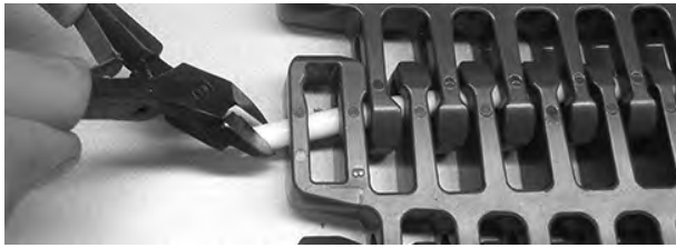
Figuur 339: Scharnierpen uit band trekken
