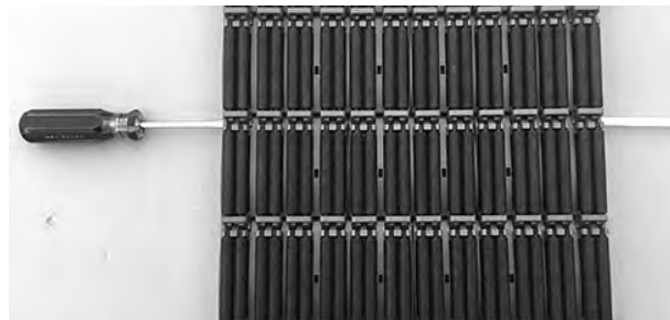
Figuur 244: De scharnieren uit de band duwen
