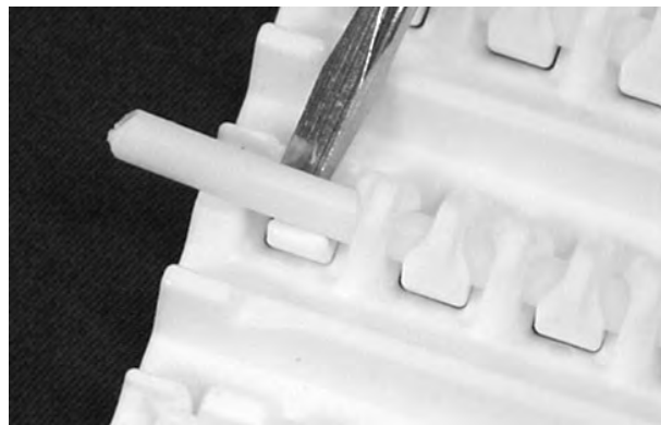
Figuur 177: Scharnieren uit scharnierenborging verwijderen
