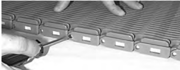
Figuur 49: De Slidelox openen
