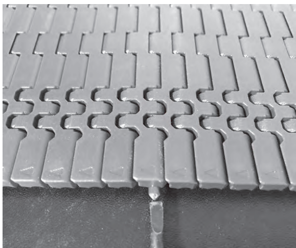
Figuur 60: Scharnieren tot in scharnierenborging duwen
