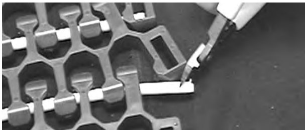
Figuur 317: Scharnierpen uit band trekken
