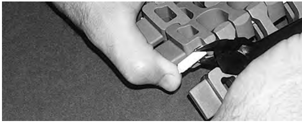
Figuur 279: De scharnierpen vastpakken
