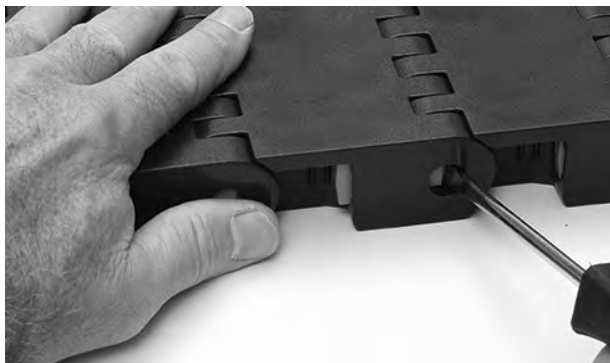
Figuur 262: De Slidelox openen
