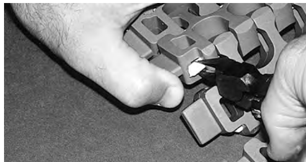
Figuur 278: Scharnierpen uit scharnierpenborging verwijderen
