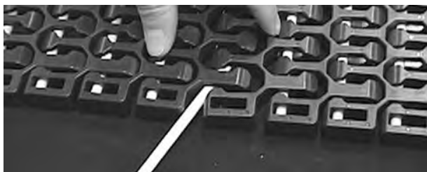
Figuur 309: De scharnierpen in de scharnieren steken
