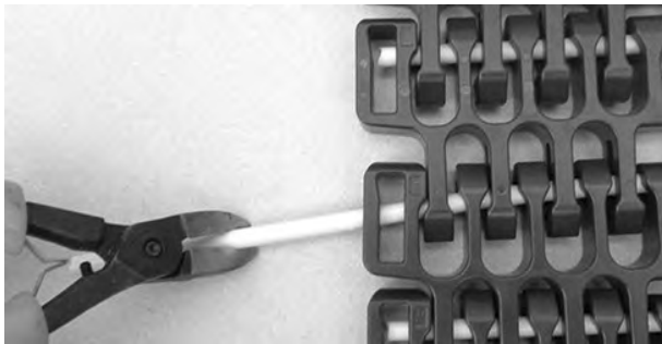
Figuur 322: Scharnierpen uit band trekken
