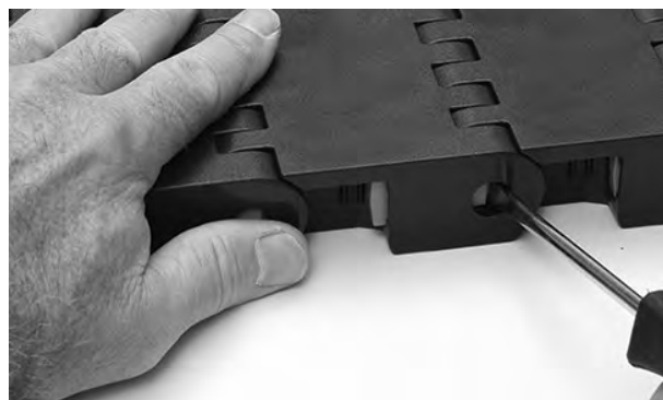
Figuur 267: De Slidelox openen
