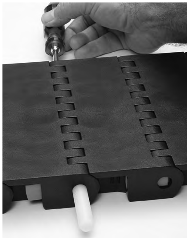
Figuur 268: De scharnieren uit de band duwen
