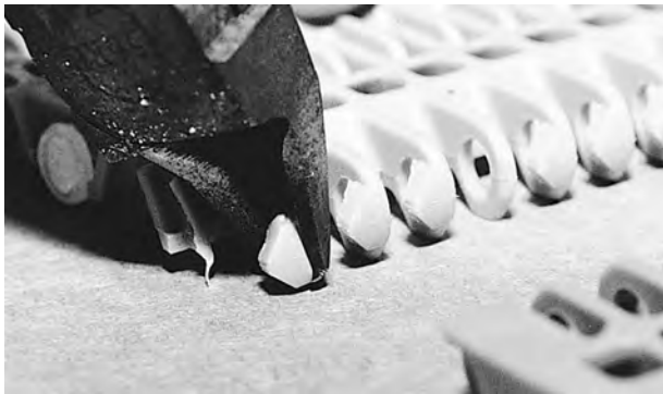
Figuur 33: Verdikking van afstandhouder knippen
