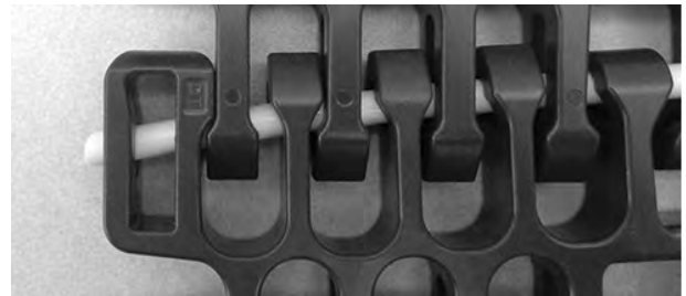
Figuur 319: Duw de scharnierpen tot in de scharnierpenborging
