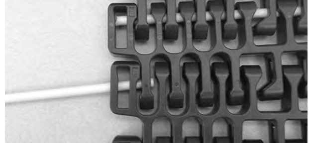
Figuur 318: Breng de scharnierpen in
