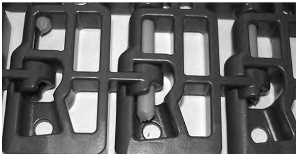
Figuur 121: Controleren of de scharnierpen zich volledig in de band bevindt
