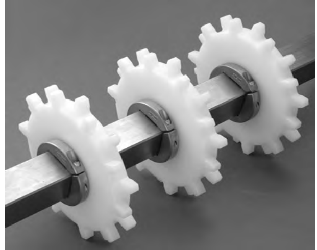
Figuur 323: Beide zijden van alle tandwielen vastzetten
