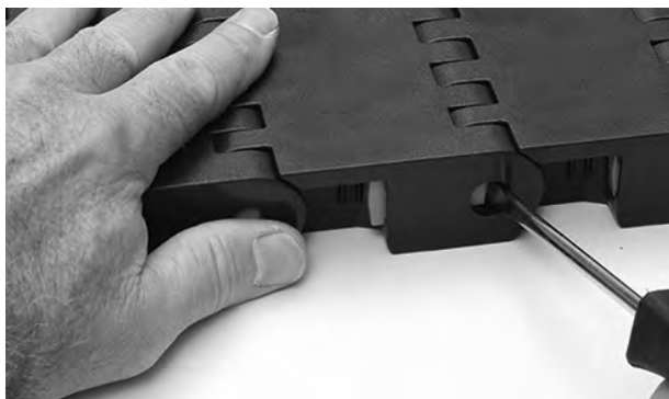
Figuur 265: De Slidelox openen
