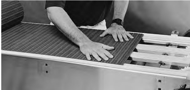
Figuur 14: Band invoeren vanaf de aandrijfszijde
