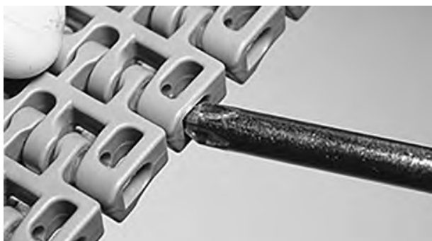
Figuur 146: Duw de scharnierpen tot in de scharnierpenborging
