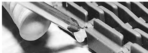
Figuur 107: De scharnieren in de band duwen
