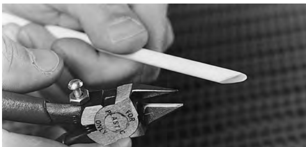
Figuur 20: Scharnierpen schuin afknippen
