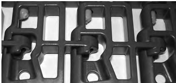
Figuur 112: De scharnierpennen bewegen in de vlakke zijkant
