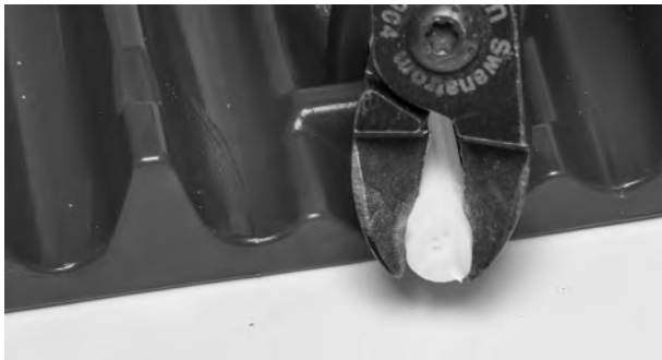
Figuur 97: Scharnierpen uit band trekken
