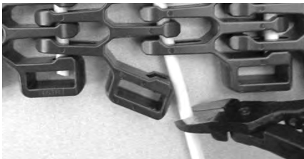
Figuur 334: Scharnierpen uit band trekken
