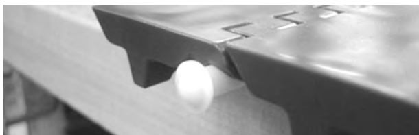
Figuur 68: De scharnierpen in de scharnieren steken
