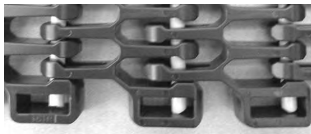
Figuur 331: Controleren of de scharnierpen zich volledig in de band bevindt
