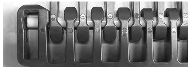
Figuur 337: Controleren of de scharnierpen in de scharnierpenborging zit
