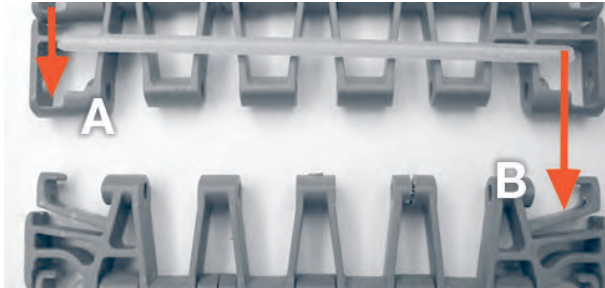
Figuur 256: De scharnierpenborgingen zoeken
