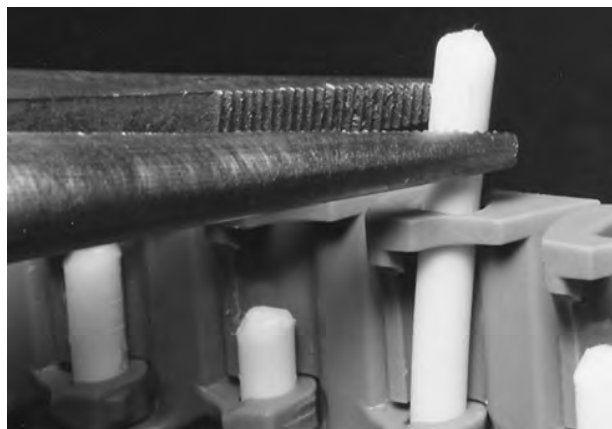
Figuur 150: Scharnierpen uit band trekken
