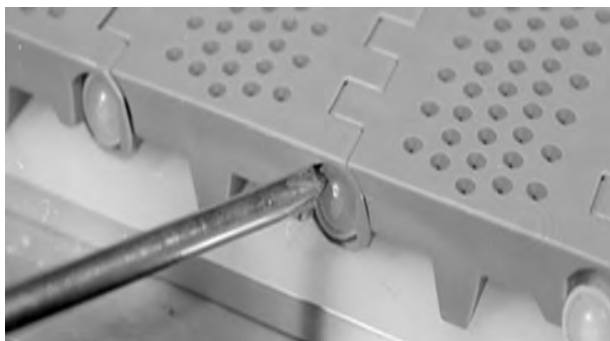
Figuur 65: De kop van de scharnierpen voorbij het snapslot duwen
