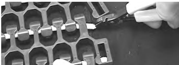
Figuur 316: De scharnierpen vastpakken
