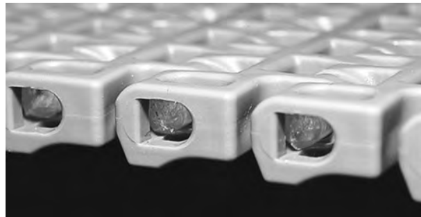
Figuur 138: Controleren of de scharnierpen in de scharnierpenborging zit
