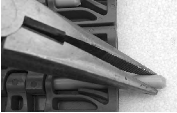
Figuur 132: Scharnierpen uit band trekken
