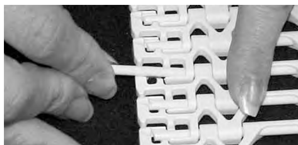
Figuur 170: De scharnierpen in de scharnieren steken
