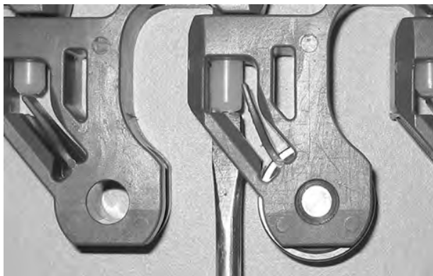
Figuur 283: Duw de scharnieren tot in de scharnierenborging
