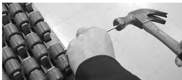
Figuur 195: De scharnierpen uit de band duwen
