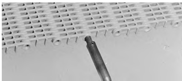
Figuur 36: De scharnierpenopening sluiten
