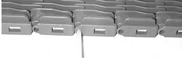
Figuur 47: Breng de scharnierpen in
