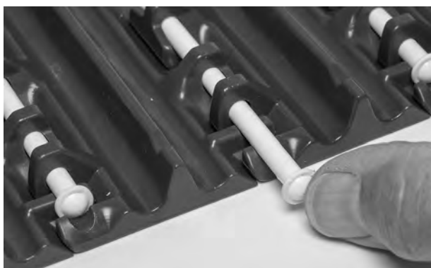
Figuur 92: De scharnierpen in de scharnieren steken
