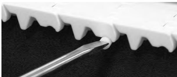
Figuur 175: Duw de scharnieren tot in de scharnierenborging
