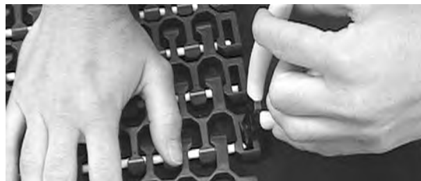
Figuur 314: De scharnierpen in de band duwen
