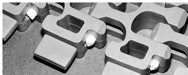
Figuur 277: Controleren of de scharnierpen zich volledig in de band bevindt
