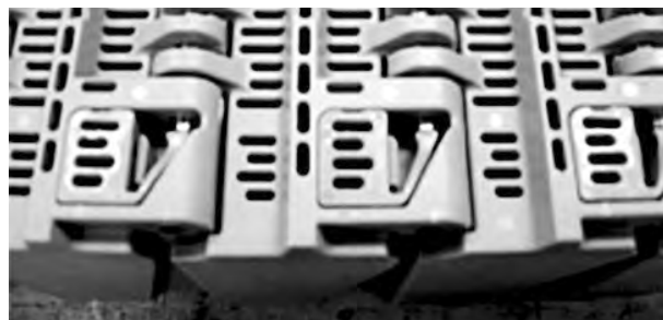
Figuur 101: Controleren of de scharnierpenborging is gesloten
