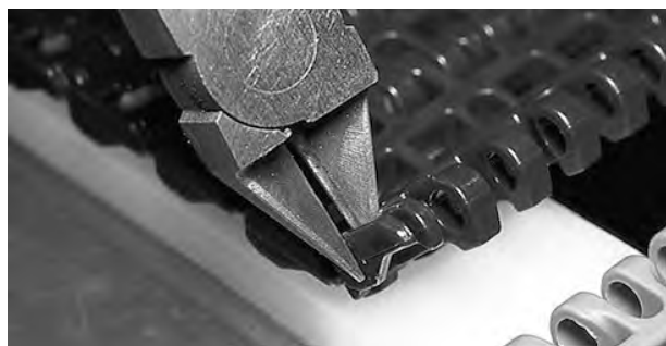
Figuur 151: Zijkantdeel knippen
