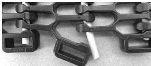
Figuur 330: De scharnierpen voorbij de rand van de band duwen
