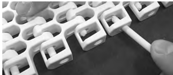
Figuur 292: De scharnierpen in de scharnieren steken
