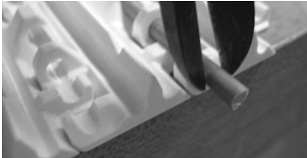
Figuur 184: Scharnierpen uit band trekken
