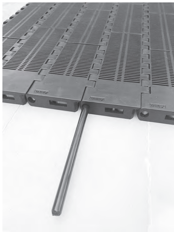
Figuur 211: Scharnierpen plaatsen
