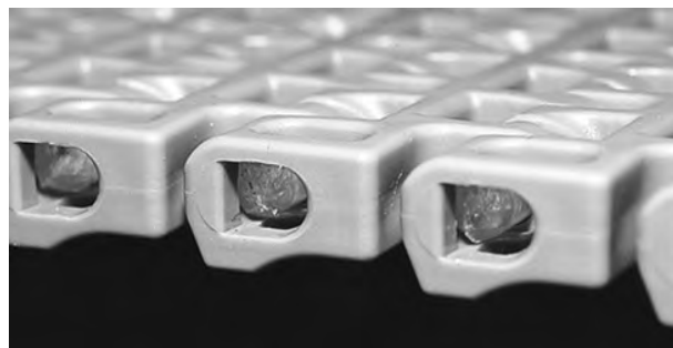
Figuur 147: Controleren of de scharnierpen in de scharnierpenborging zit
