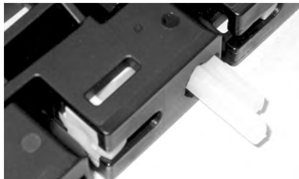
Figuur 186: De scharnierpen in de scharnieren steken
