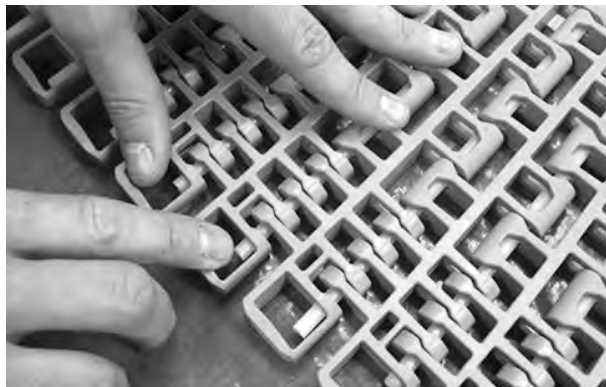
Figuur 344: Controleren of de scharnierpen in de scharnierpenborging zit
