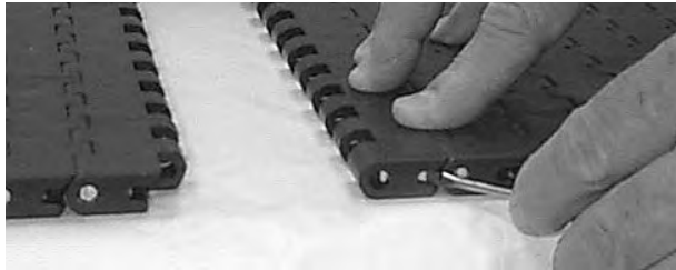
Figuur 163: De Slidelox sluiten
