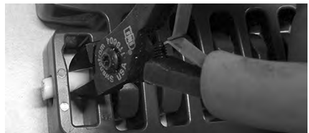
Figuur 338: De scharnierpen opzij duwen, voorbij de gesloten opening
