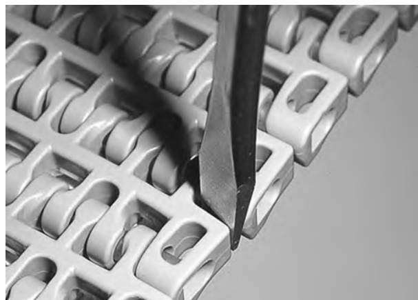
Figuur 139: Duw de scharnierpen tot in de scharnierpenborging
