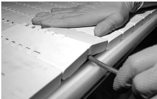
Figuur 89: De scharnieren een beetje buigen en in de scharnieren steken
