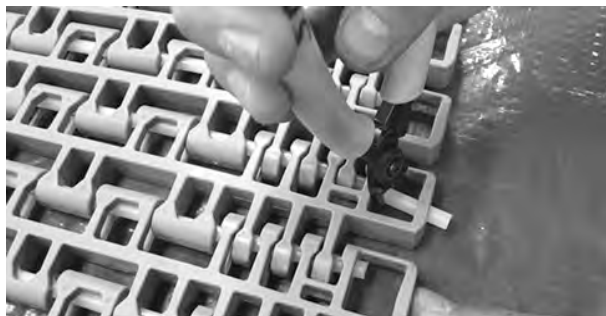
Figuur 345: Scharnierpen uit band trekken
