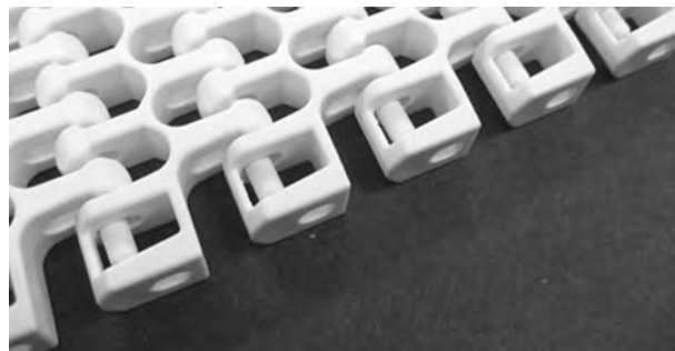
Figuur 294: Controleren of de scharnierpen in de scharnierpenborging zit
