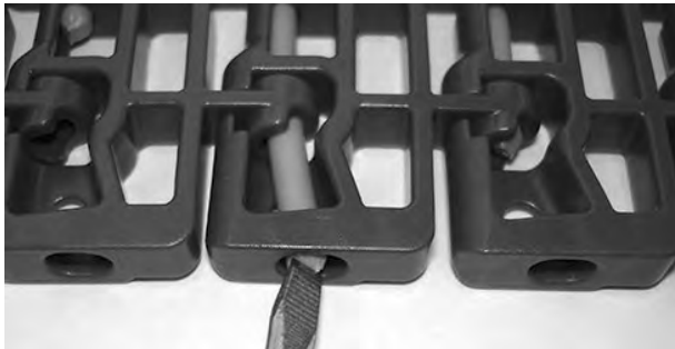
Figuur 120: Duw de scharnierpen tot in de scharnierpenborging
