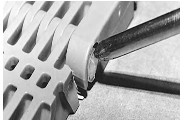
Figuur 54: De scharnierpen tot in de scharnierpenborging duwen
