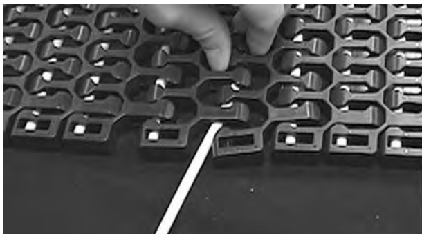
Figuur 310: De scharnieren uitlijnen
