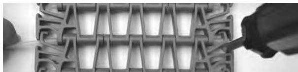
Figuur 255: De scharnierpen uit de band duwen
