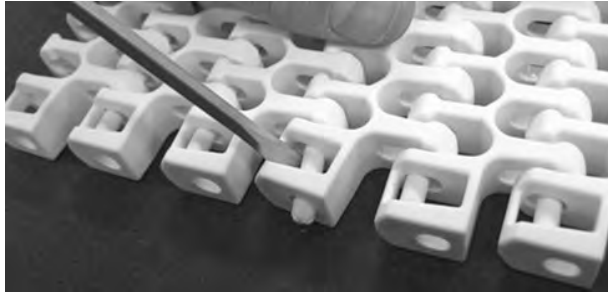
Figuur 295: De scharnierpen tot in de scharnierpenborging duwen
