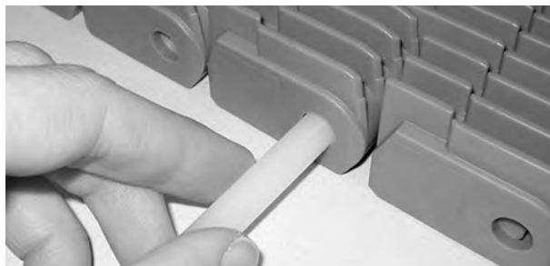
Figuur 219: Scharnierpen uit band trekken
