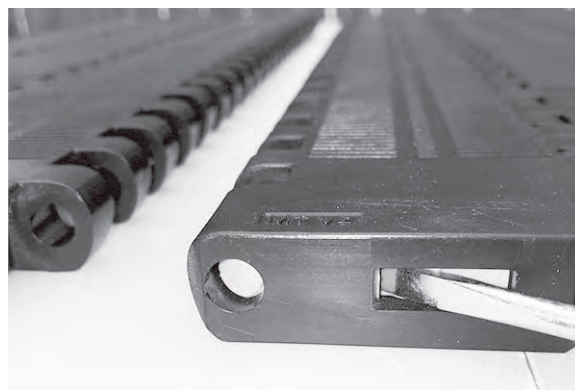
Figuur 212: De Slidelox sluiten
