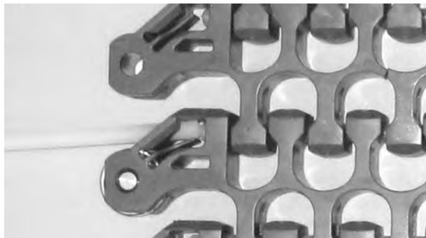
Figuur 286: De scharnieren uit de band duwen
