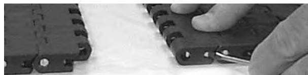
Figuur 161: De Slidelox sluiten met een schroevendraaier
