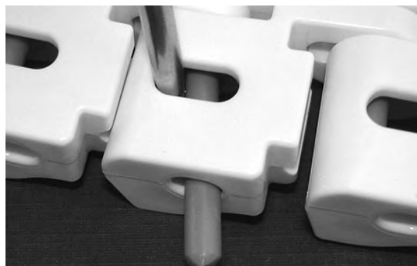
Figuur 290: De scharnierpen tot in de scharnierpenborging duwen
