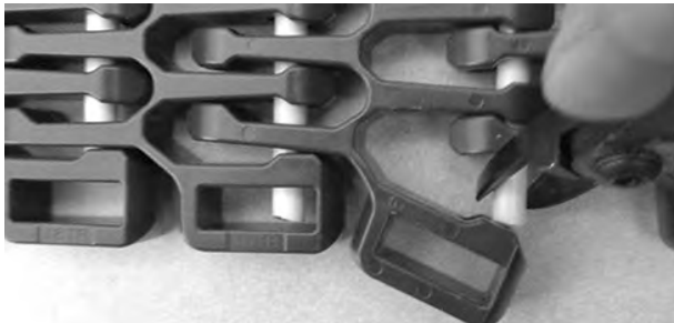
Figuur 333: De scharnierpen vastpakken
