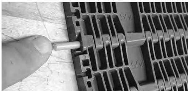
Figuur 271: Breng de scharnierpen in
