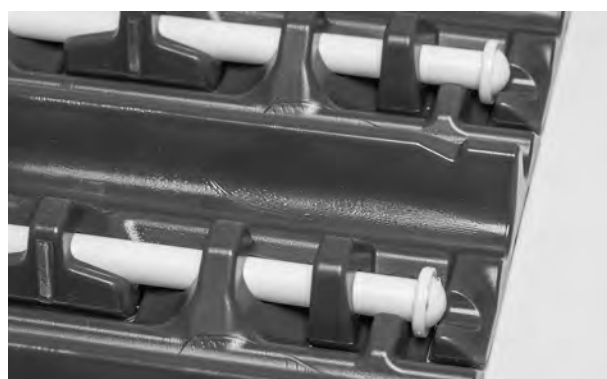
Figuur 95: Controleren of de scharnierpen in de scharnierpenborging zit
