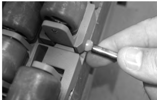
Figuur 191: Duw de scharnierpen tot in de scharnierpenborging
