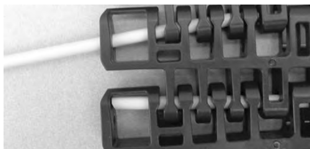
Figuur 359: De scharnierpen in de scharnieren steken
