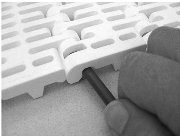
Figuur 80: De scharnierpen in de band duwen
