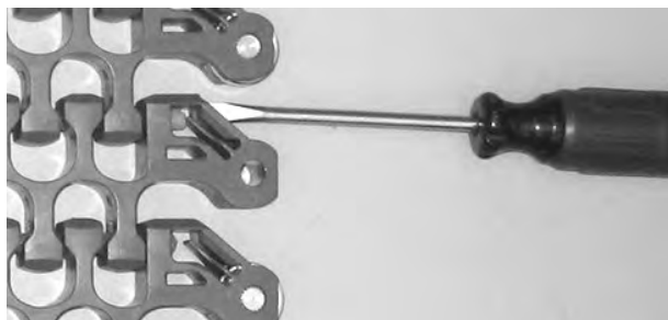
Figuur 285: Scharnierenborging openen
