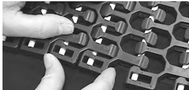
Figuur 313: Controleren of de scharnierpen zich volledig in de band bevindt
