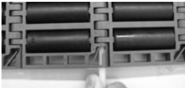
Figuur 237: De scharnierpen in de scharnieren steken
