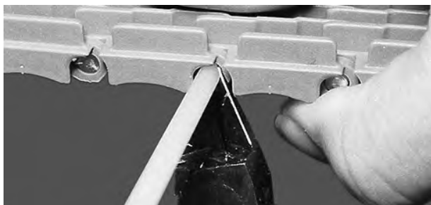
Figuur 30: De scharnierpen snijden zodat deze op gelijke lijn ligt met de rand van de band
