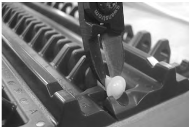
Figuur 72: De kop van de scharnierpen snijden
