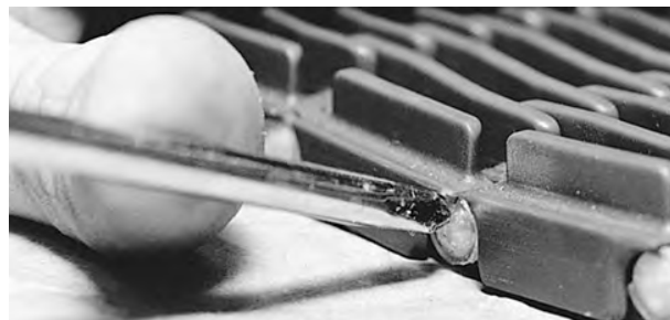
Figuur 108: De scharnieren voorbij het snapslot duwen
