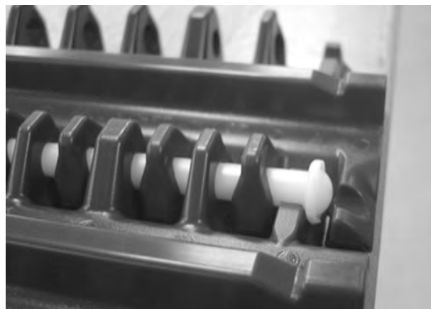
Figuur 71: Controleren of de scharnierpen in de scharnierpenborging zit
