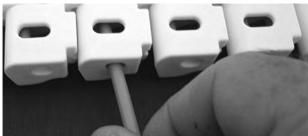
Figuur 287: De scharnierpen in de scharnieren steken
