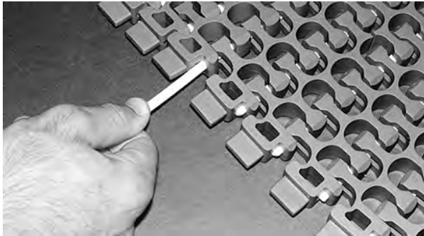
Figuur 280: De scharnierpen eruit trekken
