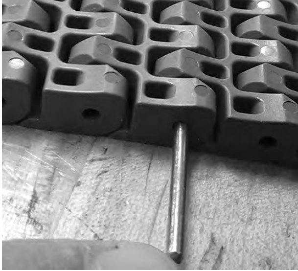
Figuur 274: De scharnierpen en scharnierpennetje uit de band duwen
