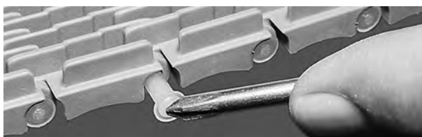
Figuur 28: De scharnierpen in de band duwen
