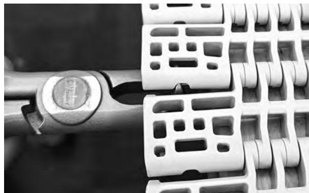
Figuur 126: Een scharnierenverwijderaar gebruiken om de stang vast te pakken
