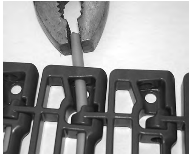
Figuur 123: Scharnierpen uit band trekken
