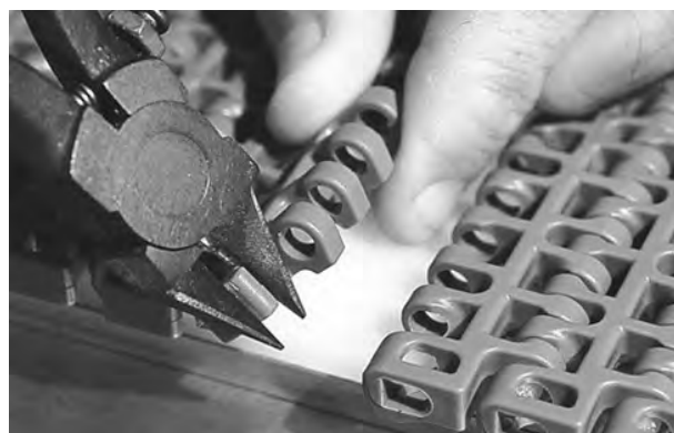
Figuur 153: De rand van de band knippen
