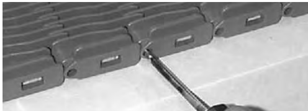
Figuur 50: De scharnierpen uit de band duwen
