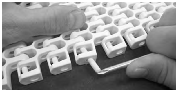
Figuur 293: Duw de scharnierpen tot in de scharnierpenborging
