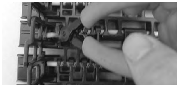
Figuur 372: Duw de scharnierpen tot in de scharnierpenborging
