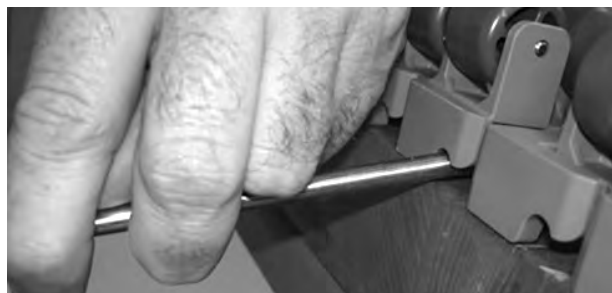
Figuur 194: Een stalen pen door het scharnier steken
