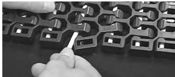
Figuur 311: De scharnierpen in de scharnieren steken
