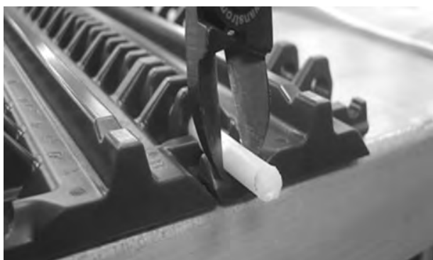
Figuur 73: Scharnierpen uit band trekken
