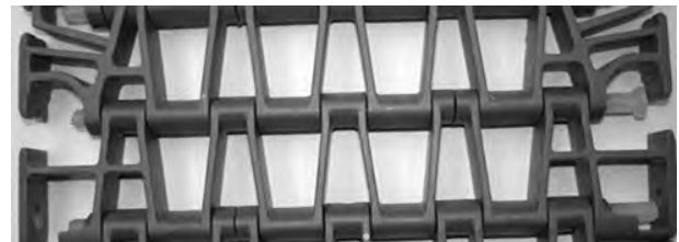
Figuur 260: Controleren of de scharnierpen in de scharnierpenborging zit
