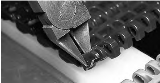
Figuur 141: De helft van de rand snijden
