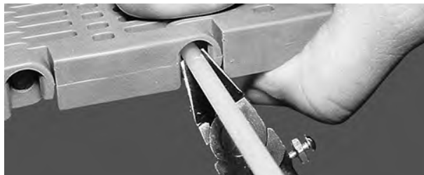
Figuur 45: De scharnierpen snijden zodat deze op gelijke lijn ligt met de rand van de band
