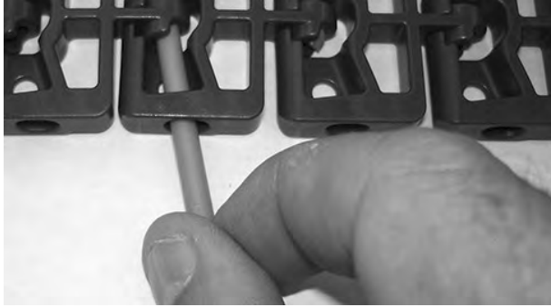
Figuur 119: De scharnierpen in de scharnieren steken
