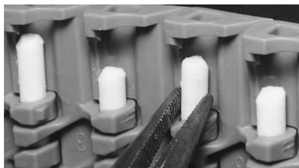
Figuur 148: De scharnierpen vastpakken
