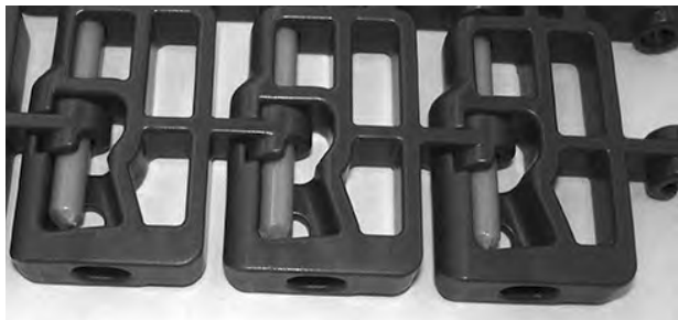
Figuur 113: De scharnierpen zet uit in de vlakke zijkant
