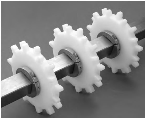
Figuur 340: Beide zijden van alle tandwielen vastzetten
