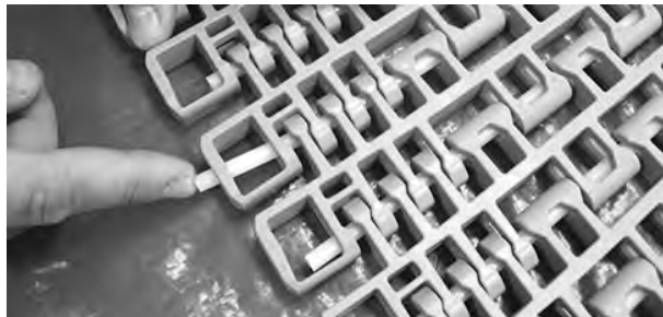
Figuur 343: Duw de scharnierpen tot in de scharnierpenborging
