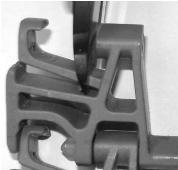
Figuur 257: Scharnierpenborging snijden
