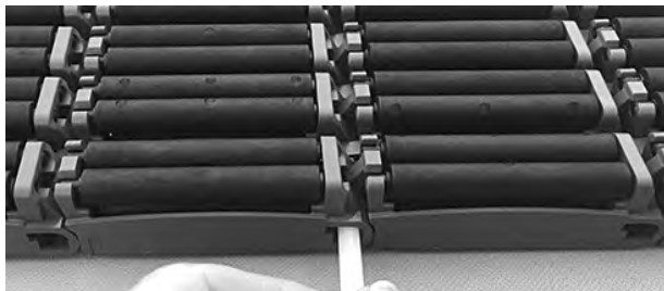
Figuur 241: De scharnieren in de scharnieren steken
