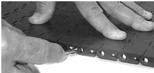
Figuur 164: De Slidelox openen
