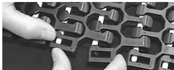
Figuur 312: De scharnierpen voorbij de rand van de band duwen, de vlakke rand over de pen klikken
