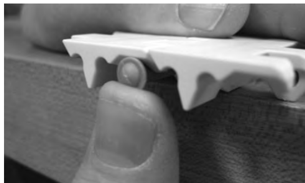
Figuur 180: Met uw duim op de scharnierpen drukken
