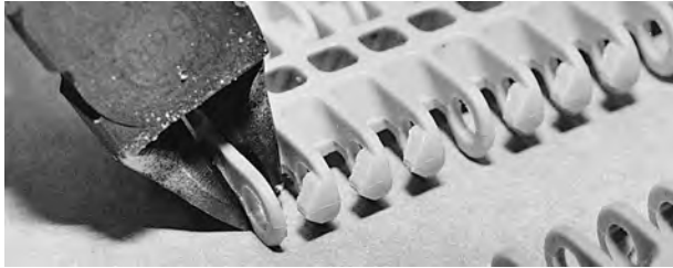
Figuur 32: Buitenste schakel knippen
