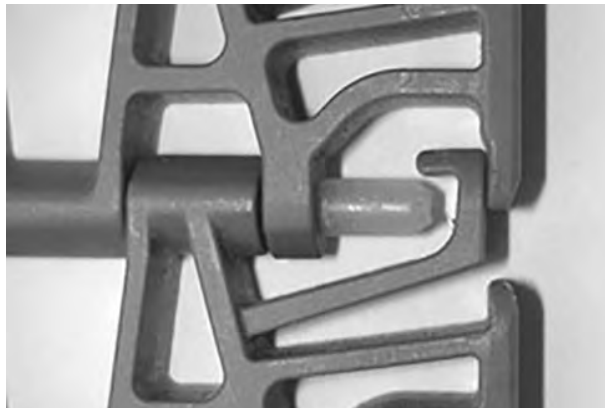
Figuur 253: Controleren of de scharnierpen in de scharnierpenborging zit
