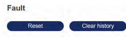
图 15: 故障 HMI 页面上的重置和清除历史记录
