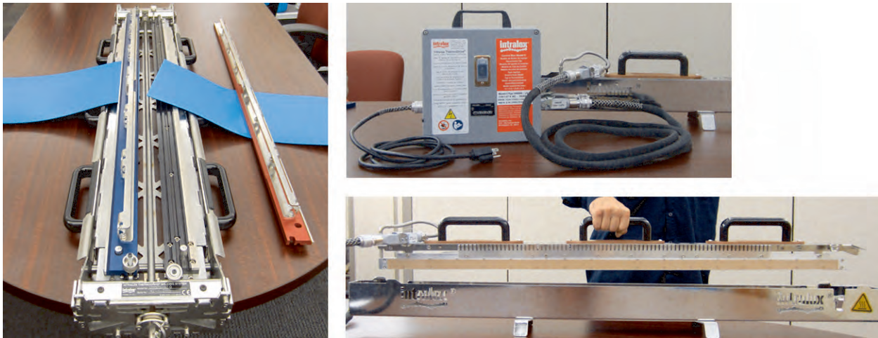
图 56: 热塑驱动拼接系统 V2 和部件
