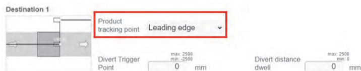
Figura 74: Parámetro de punto de seguimiento del producto DARB
