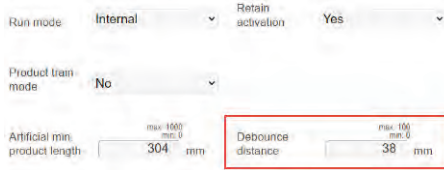
Figura 98: Debounce distance (Distancia de rebote) en la página Settings (Configuración) de la HMI
