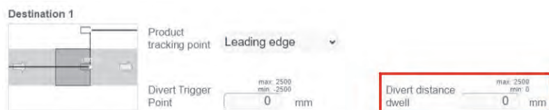
Figura 78: Retención de distancia de desvío del destino 1
