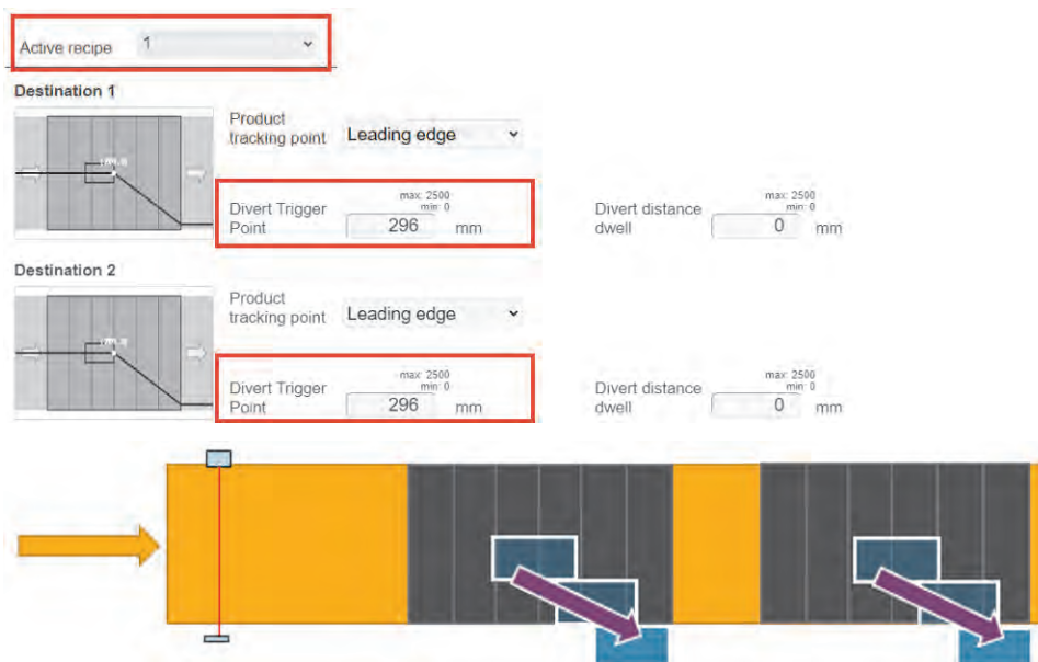
Figura 90: Conjunto de parámetros 1: Producto más pequeño, punto de activación de desvío más grande
