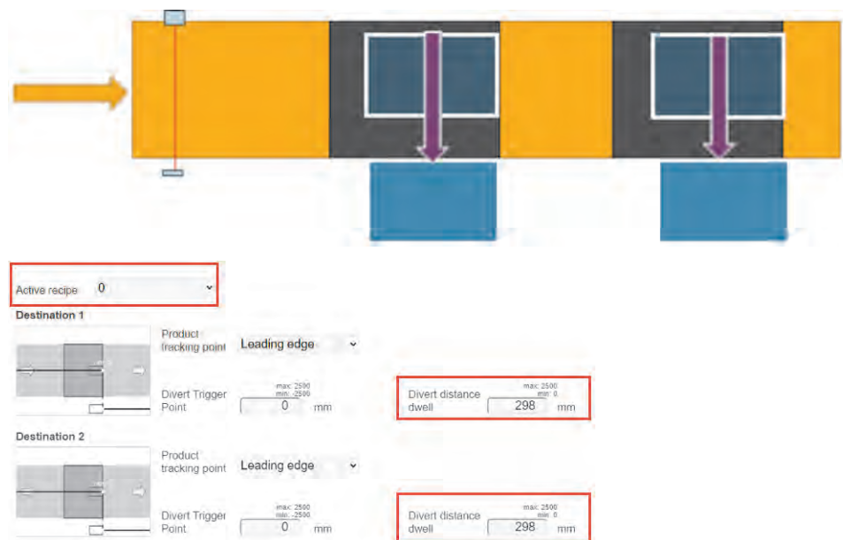
Figura 87: Conjunto de parámetros 0: Producto más grande, activación más prolongada
