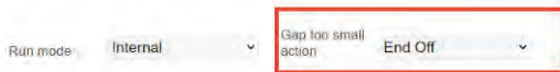
Figura 94: Gap too small action (Acción de separación demasiado pequeña) en la página Settings (Configuración) de la HMI
