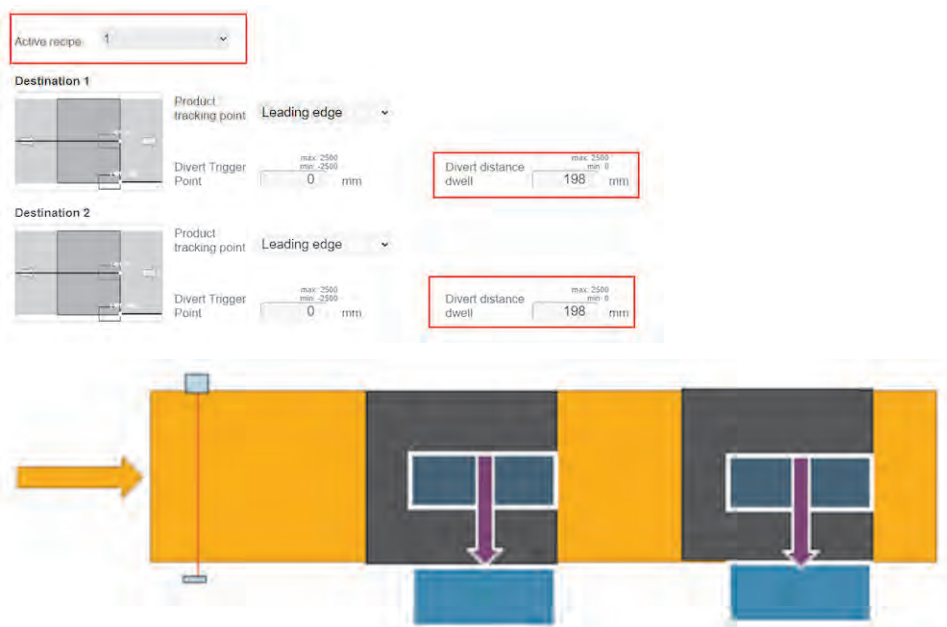
Figura 88: Conjunto de parámetros 1: Producto más pequeño, activación más corta
