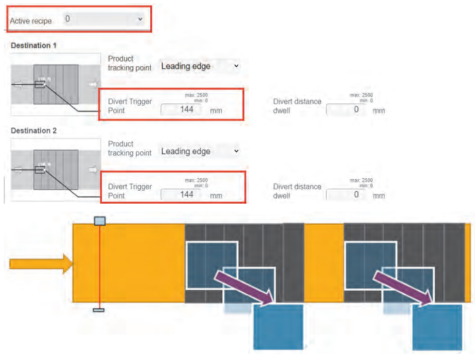
Figura 89: Conjunto de parámetros 0: Producto más grande, punto de activación de desvío más pequeño
