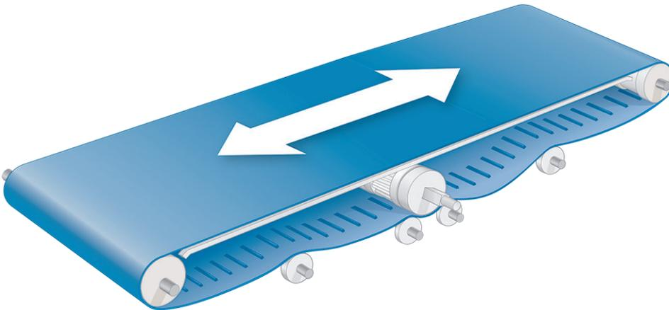
**Figura 70:** Locais da engrenagem de acionamento central e do limitador de posição
