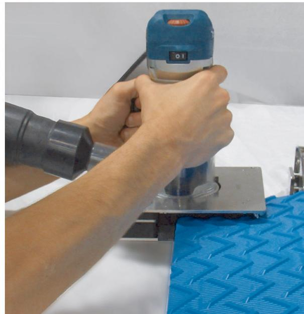
Figura 22: Conjunto da fresadora de extremidade para esteira
