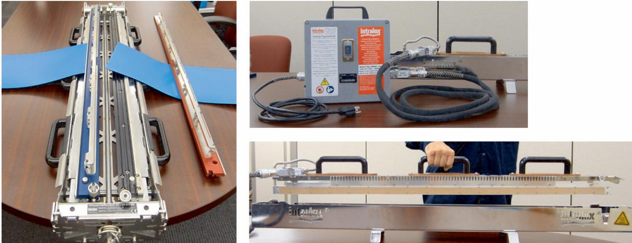
Figura 19: Sistema de emenda e componentes ThermoDrive V2
