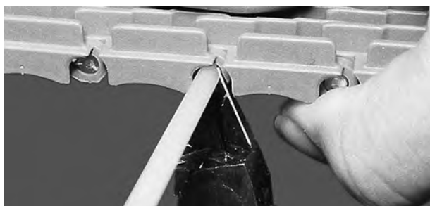
Figur 30: Kutt pinnen i fluks med båndkanten
