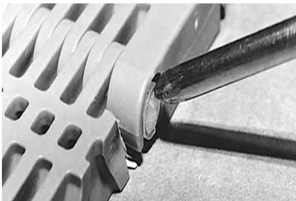
Figur 54: Skyv pinnehodet forbi låsemekanismen
