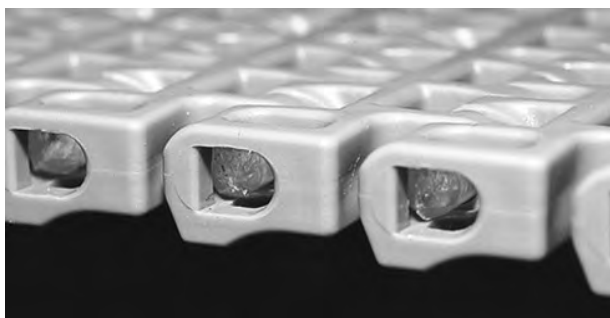
Figur 147: Sørg for at pinnen er forbi låsemekanismen
