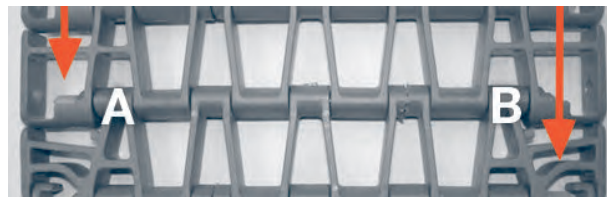
Figur 258: Sørg for at pinnen settes så langt inn som mulig
