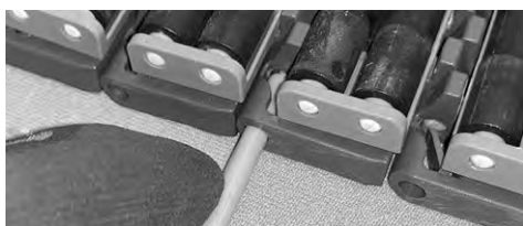
Figur 247: Sett inn pinne gjennom hengsler
