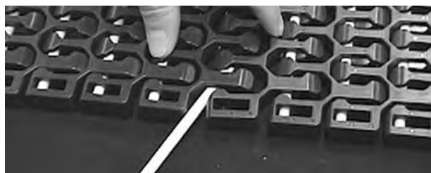
Figur 309: Sett inn pinne gjennom hengsler
