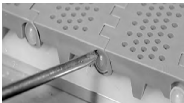
Figur 65: Kontroller at pinnehodet er forbi Snap-Lock
