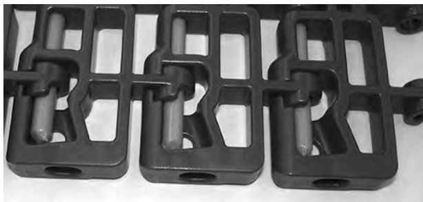
Figur 113: Pinnen utvides inn i den jevne kanten
