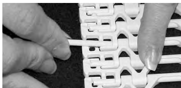
Figur 170: Sett inn pinne gjennom hengsler
