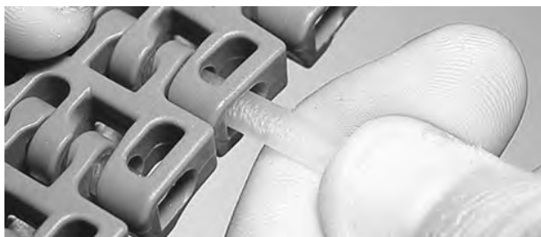
Figur 136: Sett inn pinne gjennom hengsler
