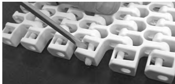
Figur 295: Skyv pinnen gjennom låsemekanismen
