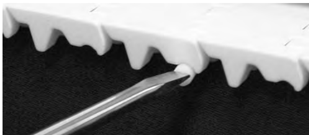
Figur 175: Skyv pinnen forbi låsemekanismen
