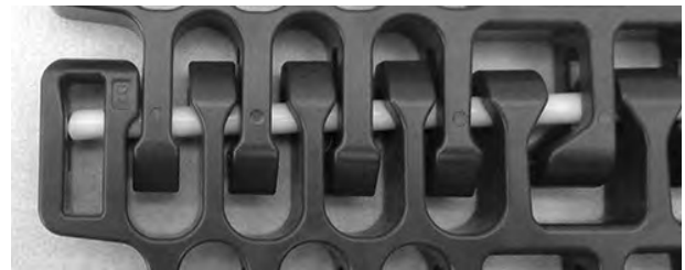
Figur 320: Sørg for at pinnen er forbi låsemekanismen
