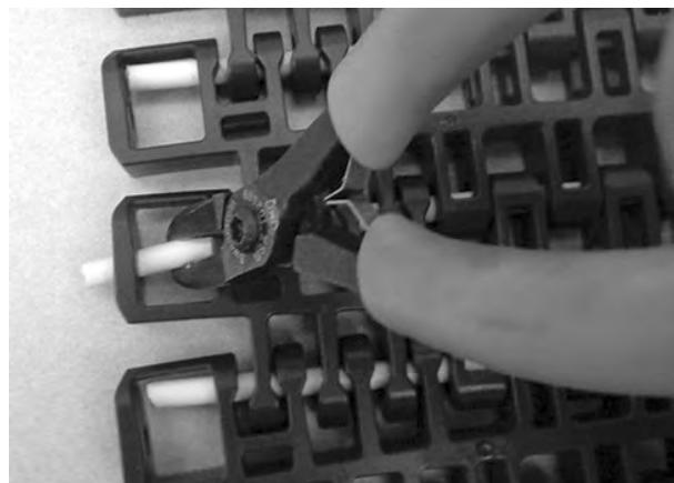
Figur 362: Skyv pinnen forbi låsemekanismen
