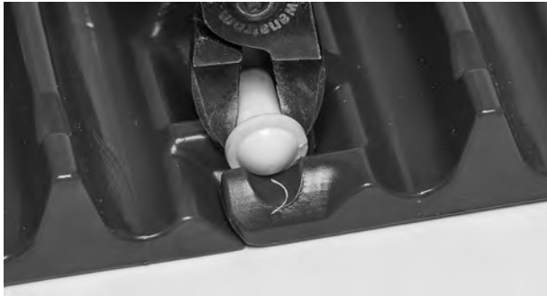
Figur 96: Kutt av pinnehode
