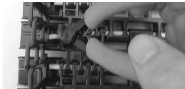
Figur 358: Trekk pinnen fra båndet
