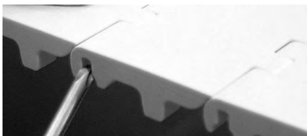
Figur 205: Skyv pinnen forbi låsemekanismen
