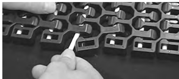
Figur 311: Sett inn pinne gjennom hengsler
