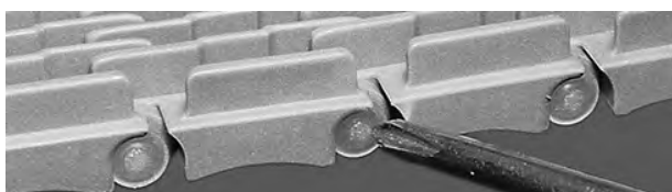
Figur 29: Kontroller at pinnehodet er forbi Snap-Lock
