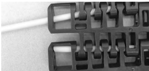
Figur 359: Sett inn pinne gjennom hengsler
