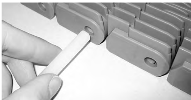
Figur 216: Sett inn pinne gjennom hengsler
