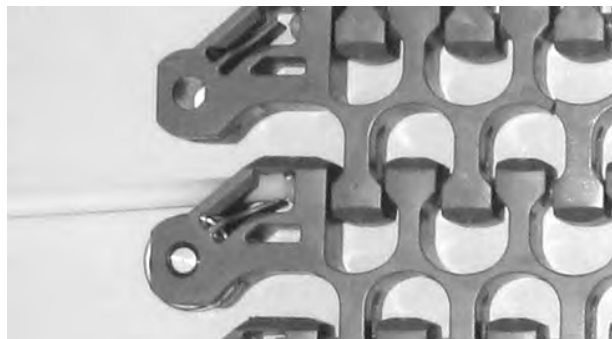
Figur 304: Trekk pinnen fra båndet
