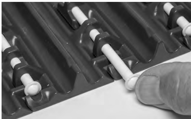
Figur 92: Sett inn pinne gjennom hengsler
