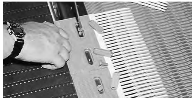
Figur 24: Monter fingeroverføringsplater ved hjelp av Intralox-skruer av plast
