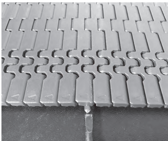
Figur 60: Skyv pinnen forbi låsemekanismen
