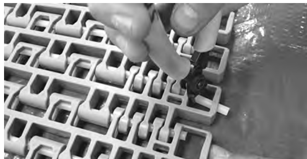
Figur 345: Trekk pinnen fra båndet
