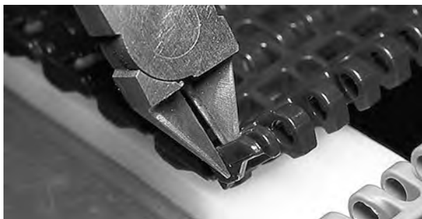
Figur 141: Kutt av halvparten av kanten
