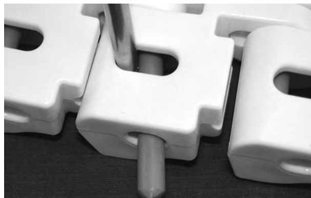
Figur 290: Skyv pinnen gjennom låsemekanismen
