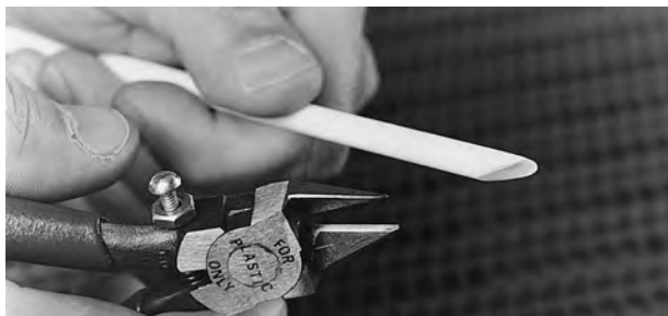
Figur 20: Kutt pinnen i en vinkel
