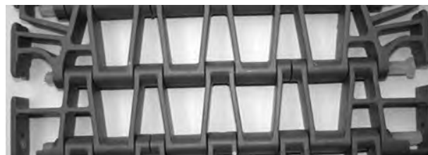
Figur 260: Sørg for at pinnen er forbi låsemekanismen
