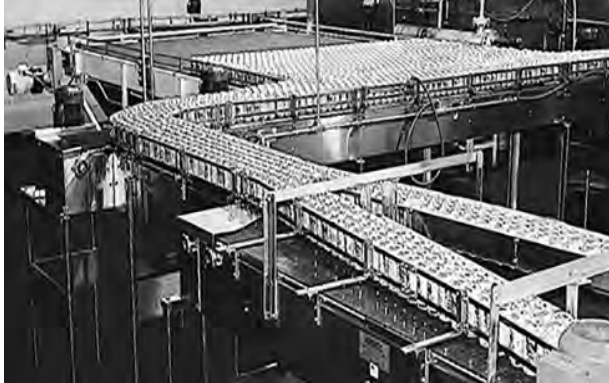
Figur 23: Plasser støtter langs båndbredden
