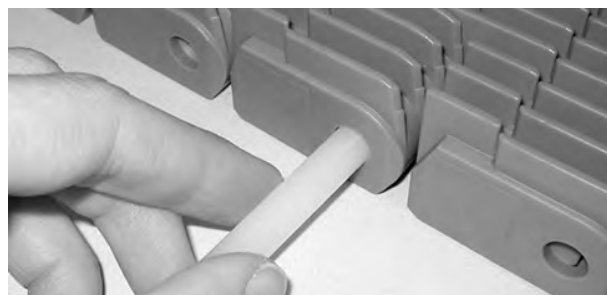
Figur 219: Trekk pinnen fra båndet
