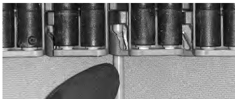
Figur 248: Skyv pinnen forbi låsemekanismen
