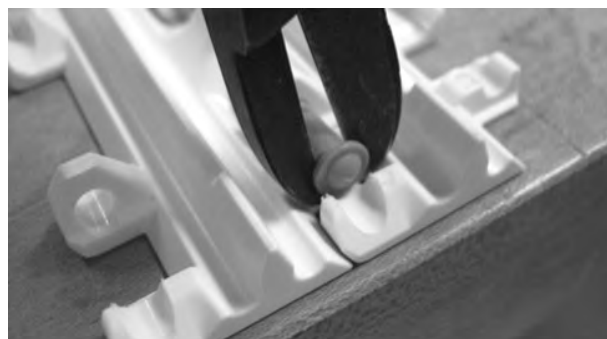
Figur 183: Kutt av pinnehode
