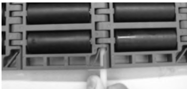
Figur 237: Sett inn pinne gjennom hengsler
