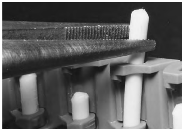
Figur 150: Trekk pinnen fra båndet
