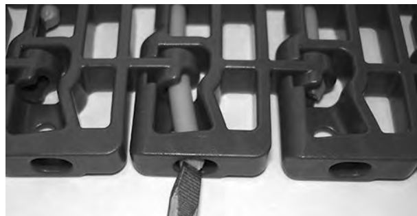
Figur 120: Skyv pinnen forbi låsemekanismen
