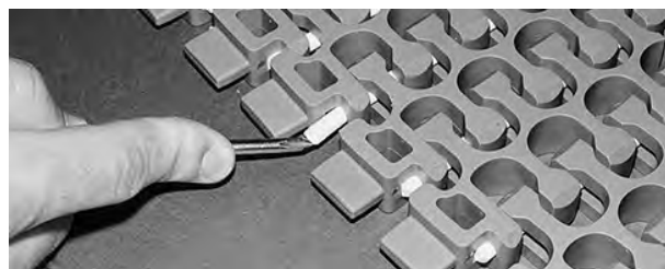
Figur 276: Sørg for at pinnen er forbi låsemekanismen
