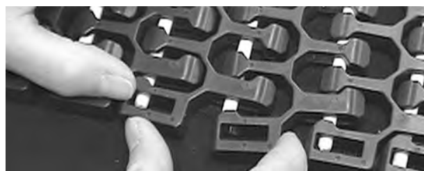
Figur 312: Skyv pinnen forbi båndkanten, knepp den jevne kanten over pinnen
