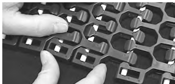
Figur 313: Kontroller at pinnen er satt så langt inn som mulig
