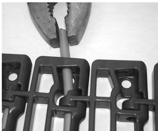
Figur 123: Trekk pinnen fra båndet
