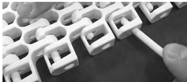
Figur 292: Sett inn pinne gjennom hengsler
