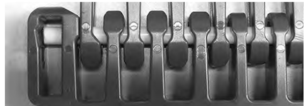
Figur 337: Sørg for at pinnen er forbi låsemekanismen
