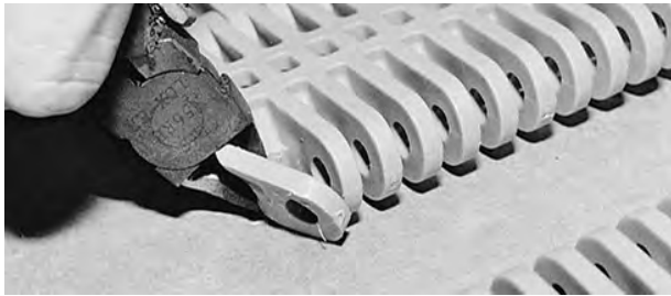
Figur 52: Kutt det ytterste leddet
