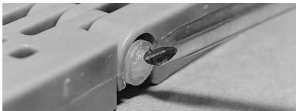
Figur 44: Kontroller at pinnehodet er forbi Snap-Lock
