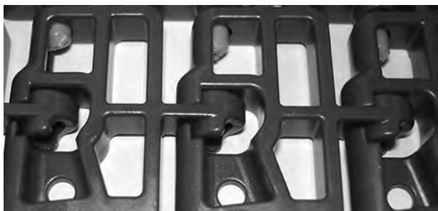
Figur 112: Pinner beveges inne i den jevne kanten
