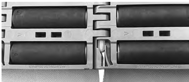
Figur 242: Skyv pinnen forbi låsemekanismen
