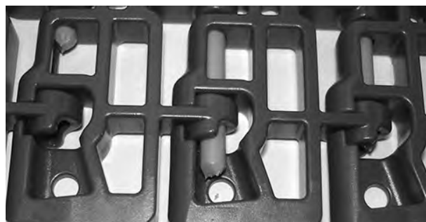
Figur 121: Sørg for at pinnen settes så langt inn som mulig
