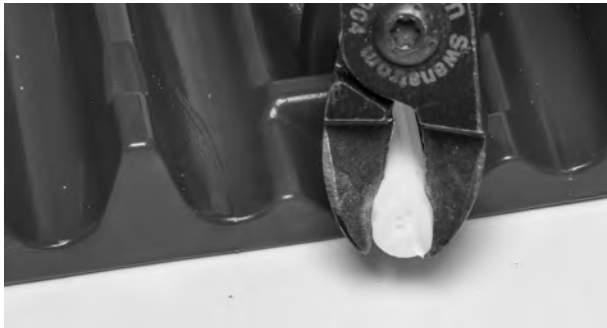
Figur 97: Trekk pinnen fra båndet
