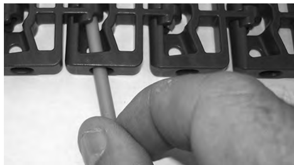
Figur 119: Sett inn pinne gjennom hengsler
