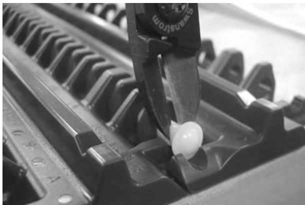
Figur 72: Kutt av pinnehode
