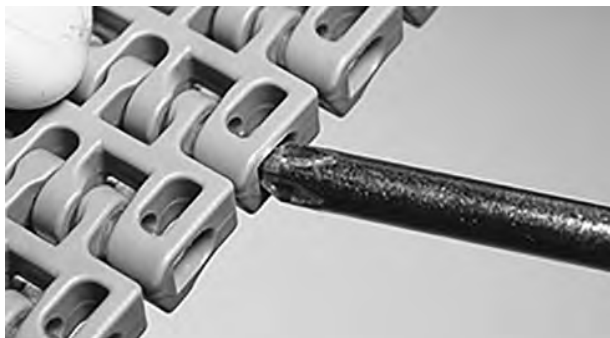
Figur 137: Skyv pinnen forbi låsemekanismen
