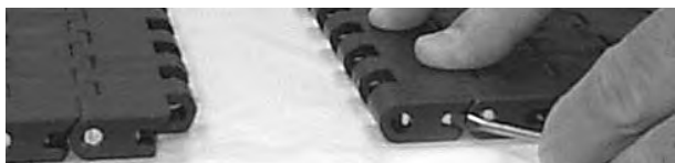
Figur 161: Bruk skrutrekker til å lukke Slidelox
