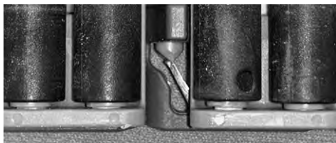
Figur 249: Sørg for at pinnen er forbi låsemekanismen
