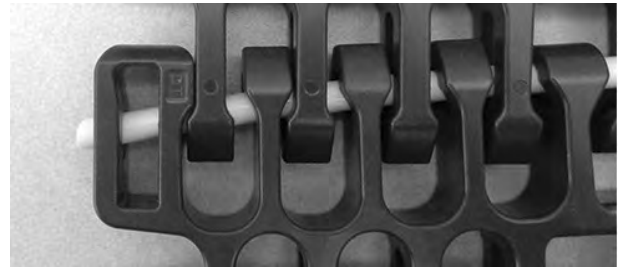
Figur 319: Skyv pinnen forbi låsemekanismen
