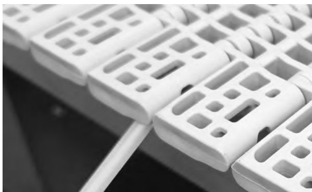
Figur 124: Sett inn pinnen under den fluktende kanten
