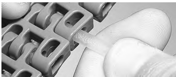
Figur 145: Sett inn pinne gjennom hengsler
