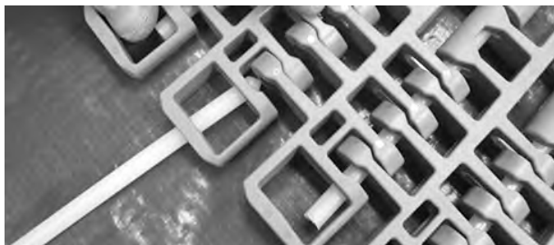
Figur 342: Sett inn pinne gjennom hengsler
