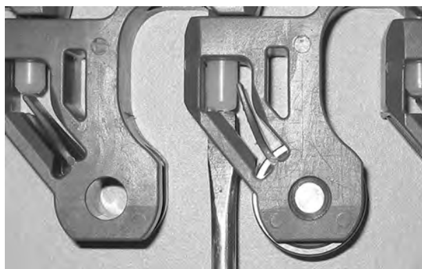
Figur 283: Skyv pinnen forbi låsemekanismen
