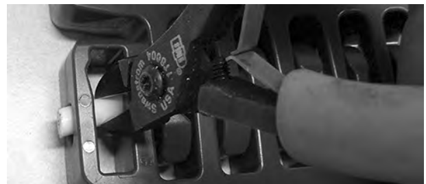
Figur 338: Skyv pinnen til siden og forbi det lukkede hullet
