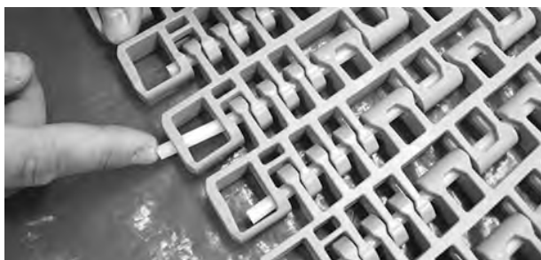
Figur 343: Skyv pinnen forbi låsemekanismen
