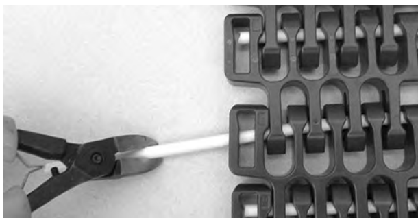
Figur 322: Trekk pinnen fra båndet
