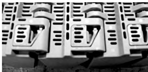
Figur 101: Sørg for at låsemekanismen er lukket
