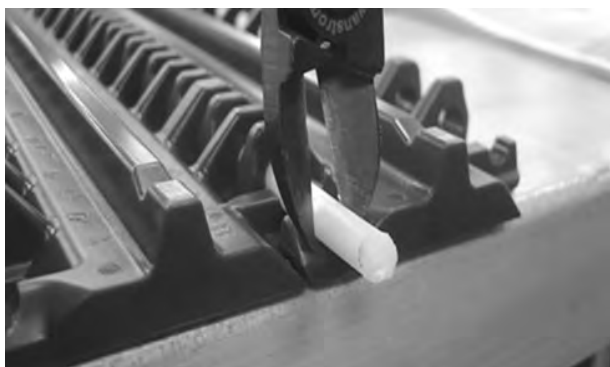
Figur 73: Trekk pinnen fra båndet
