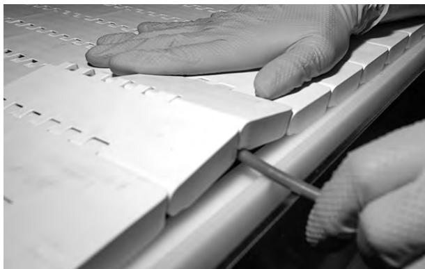
Figur 89: Bøy pinnen litt, og sett den inn gjennom hengslene
