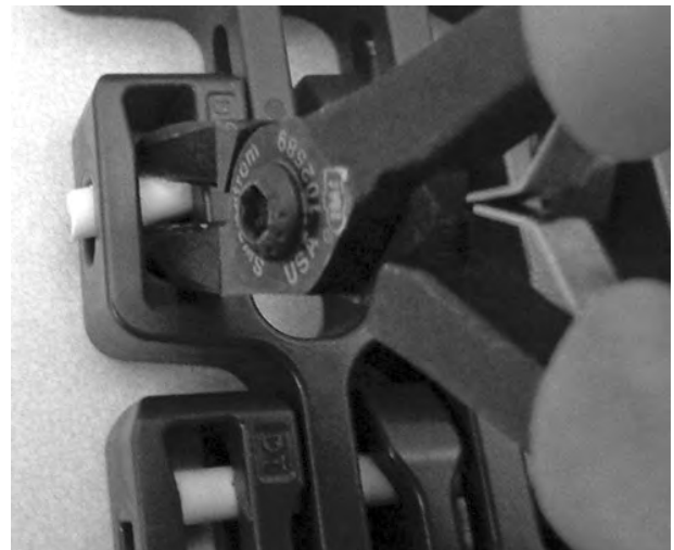
Figur 321: Skyv pinnen til siden og forbi hullet
