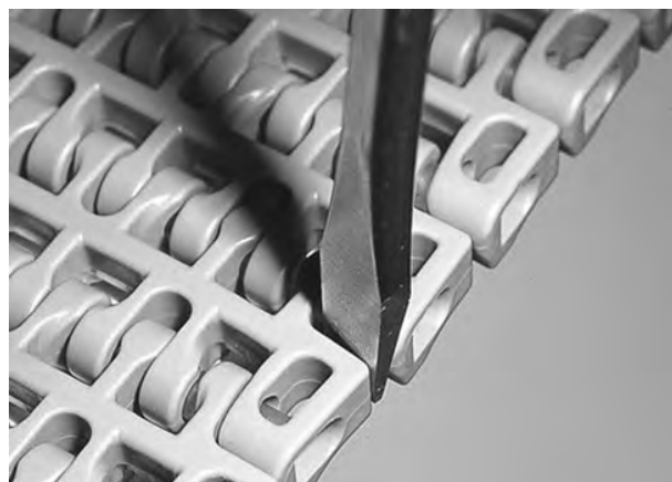
Figur 139: Skyv pinnen forbi låsemekanismen
