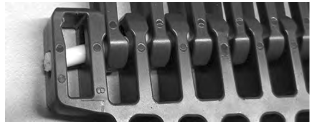
Figur 336: Sett inn pinne gjennom hengsler
