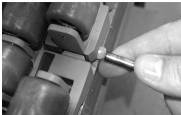
Figur 191: Skyv pinnen forbi låsemekanismen
