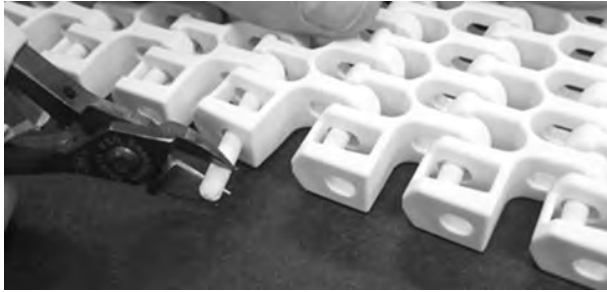
Figur 296: Trekk pinnen fra båndet
