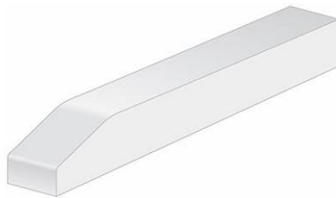
图 25: 耐磨条端部倒角
