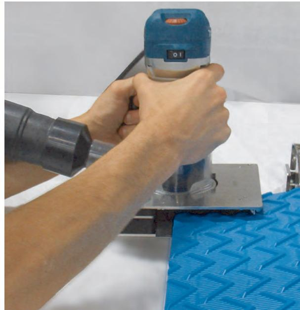
图 59: 传送带端头槽刨套件
