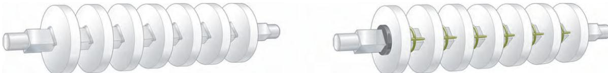
图 21：定位环和链轮隔圈
