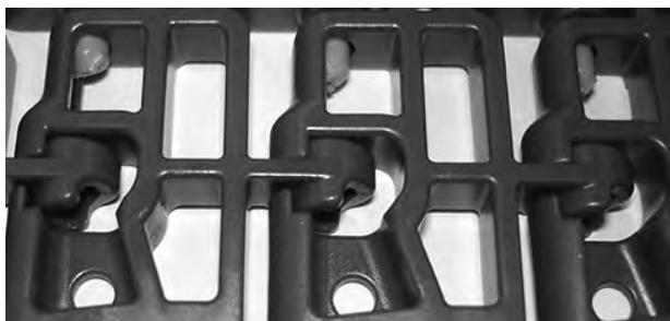
Rysunek 112: Wsunięcie się pinów w gładki brzeg
