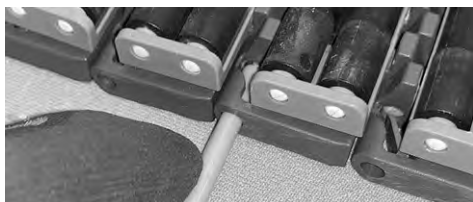
Rysunek 247: Wsuwanie pinu przez zawiasy
