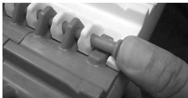
Rysunek 78: Wciśnij pin za element retencyjny
