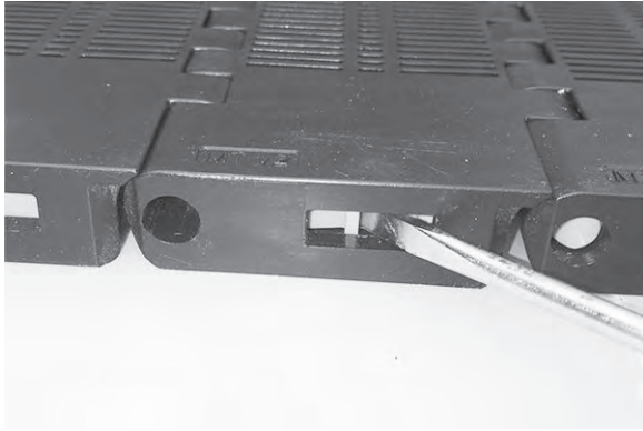
Rysunek 213: Otwieranie elementu Slidelox
