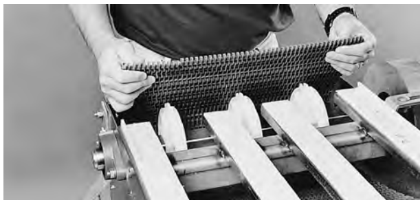
Rysunek 17: Przesuwanie taśmy przez sekcję powrotną przenośnika
