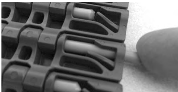
Rysunek 128: Wsuwanie pinu przez zawiasy
