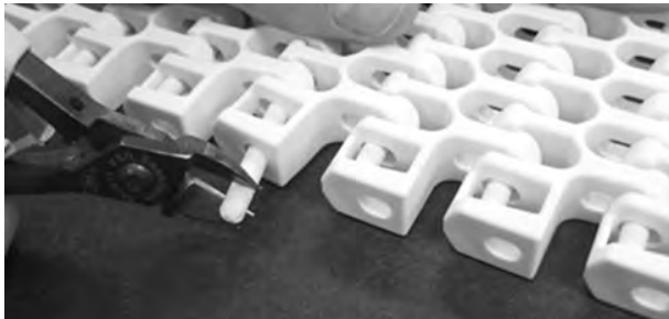
Rysunek 296: Wyciągnięcie pinu z taśmy
