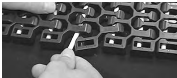
Rysunek 311: Wsuwanie pinu przez zawiasy
