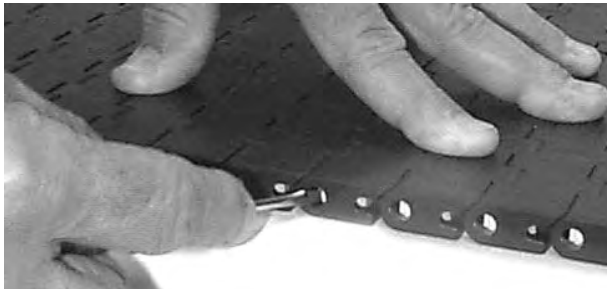
Rysunek 164: Otwieranie elementu Slidelox
