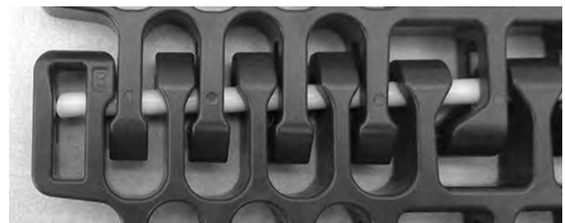
Rysunek 320: Upewnienie się, że pin znajduje się za elementem retencyjnym
