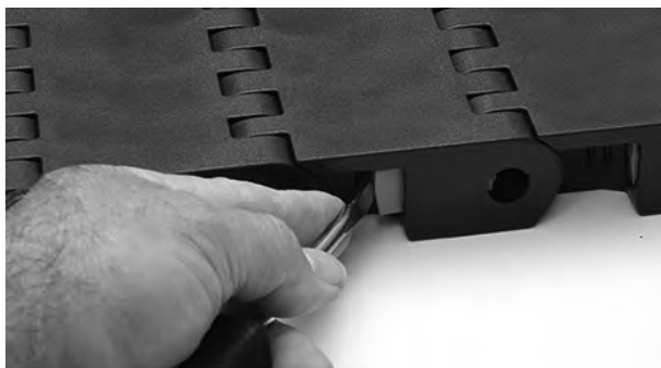
Rysunek 261: Zamykanie elementu Slidelox
