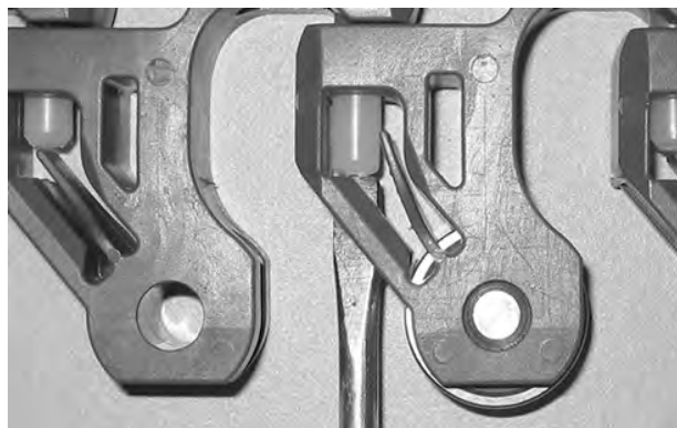
Rysunek 283: Wciśnij pin za element retencyjny
