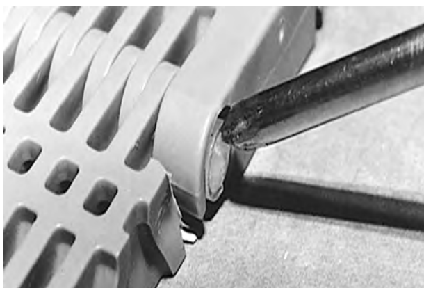
Rysunek 54: Wciśnięcie łba pinu przez element retencyjny
