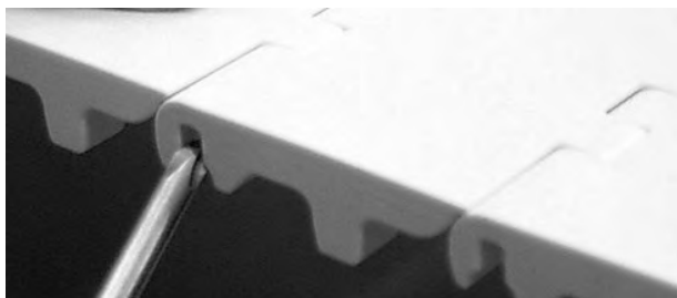
Rysunek 205: Wciśnięcie pinu przez element retencyjny
