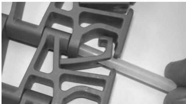
Rysunek 251: Wsuwanie pinu przez zawiasy
