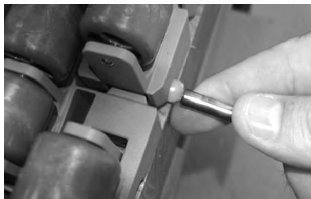
Rysunek 191: Wciśnij pin za element retencyjny
