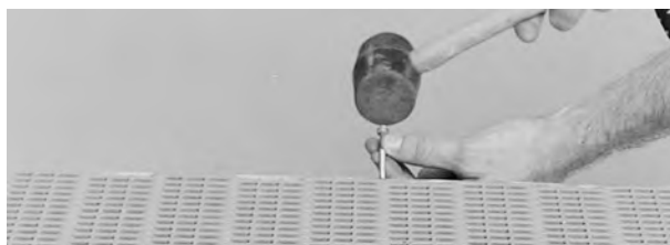
Rysunek 38: Wypchnięcie pinu z taśmy
