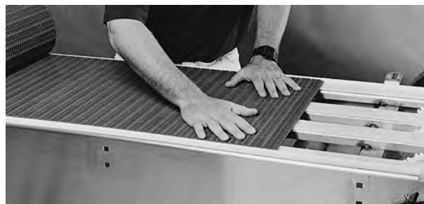
Rysunek 14: Przesuwanie taśmy od końca napędowego
