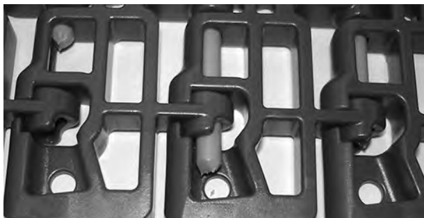
Rysunek 121: Upewnienie się, że pin jest całkowicie wsunięty
