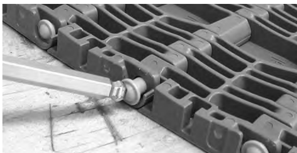
Rysunek 272: Wciśnięcie pinu krótkiego za element retencyjny
