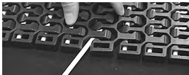
Rysunek 309: Wsuwanie pinu przez zawiasy
