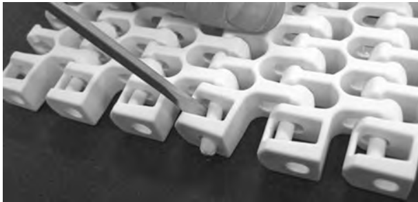
Rysunek 295: Wciskanie pinu przez element retencyjny
