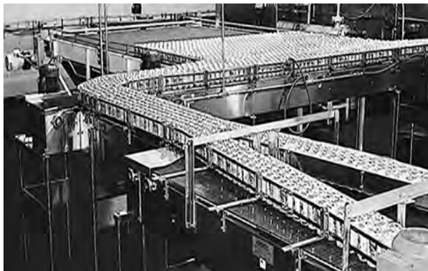
Rysunek 23: Umieszczenie podpór na całej szerokości taśmy
