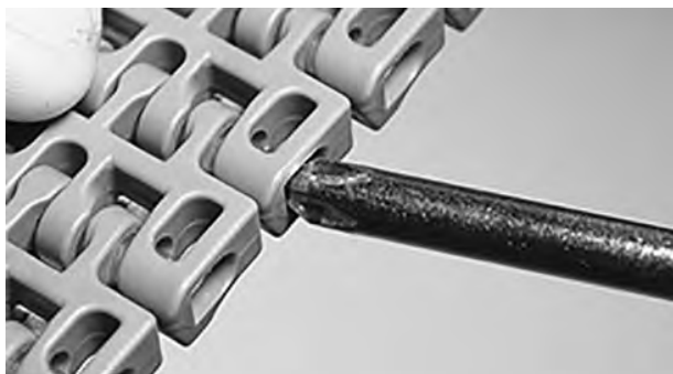
Rysunek 146: Wciśnij pin za element retencyjny
