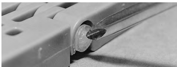
Rysunek 44: Upewnienie się, że pin znajduje się za zapięciem zatrzaskowym
