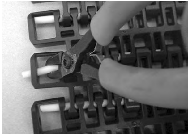
Rysunek 362: Wciśnij pin za element retencyjny
