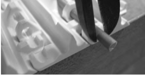
Rysunek 184: Wyciągnij pin z taśmy
