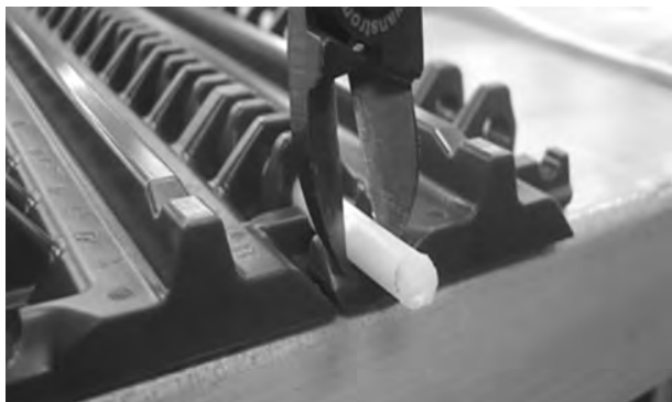
Rysunek 73: Wyciągnij pin z taśmy
