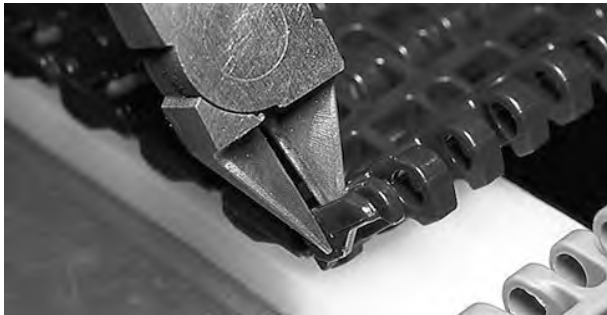
Rysunek 141: Odcięcie połowy brzegu
