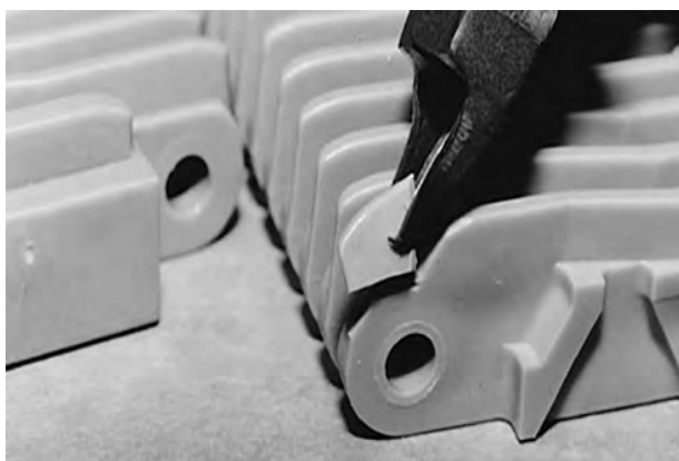
Rysunek 53: Odcięcie zewnętrznego żebra
