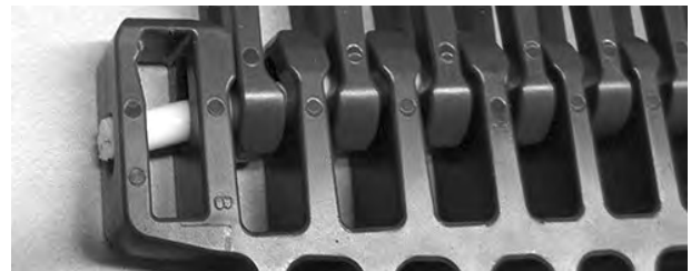
Rysunek 336: Wsuwanie pinu przez zawiasy
