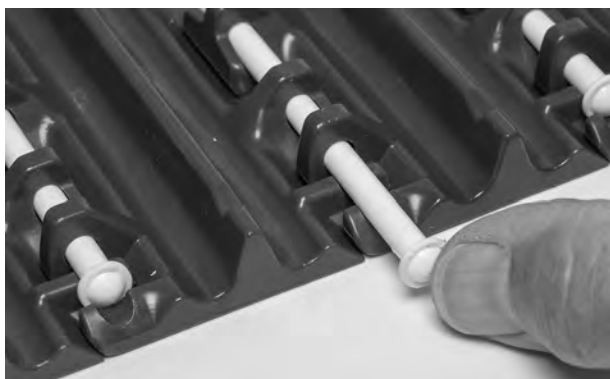
Rysunek 92: Wsuwanie pinu przez zawiasy
