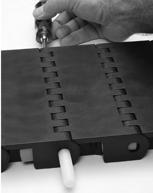
Rysunek 264: Wypchnięcie pinu z taśmy
