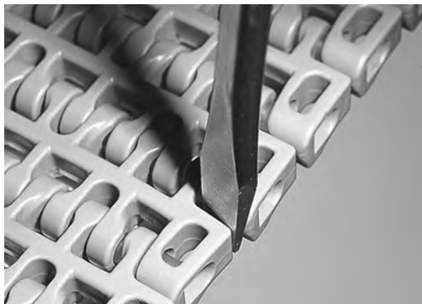
Rysunek 139: Wciśnij pin za element retencyjny
