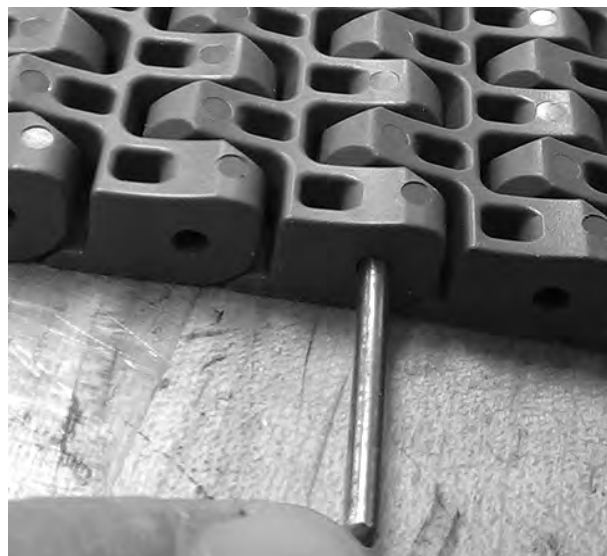
Rysunek 274: Wypchnięcie pinu i pinu krótkiego z taśmy
