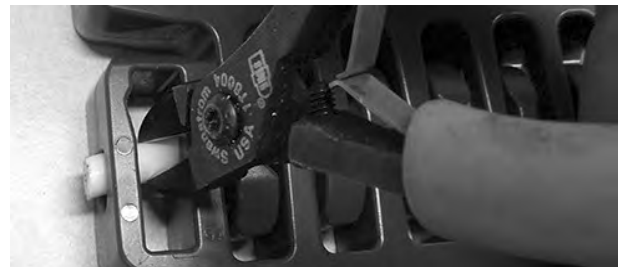
Rysunek 338: Popchnij pin w bok i wysuń poza przesłonięty otwór
