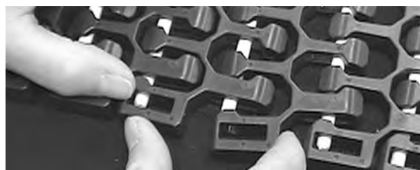
Rysunek 312: Wciśnięcie pinu poza krawędź taśmy, zatrzaśnięcie na nim gładkiego brzegu
