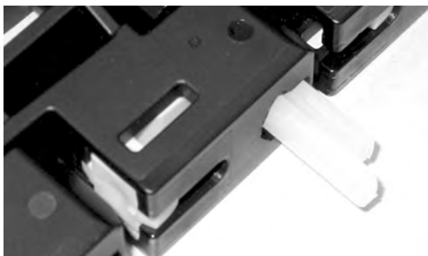
Rysunek 186: Wsuwanie pinu przez zawiasy
