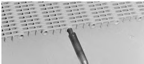
Rysunek 36: Zamykanie otworu pod pin
