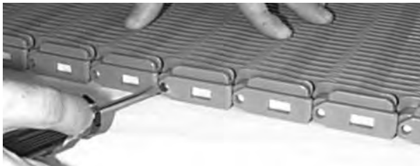
Rysunek 49: Otwieranie elementu Slidelox
