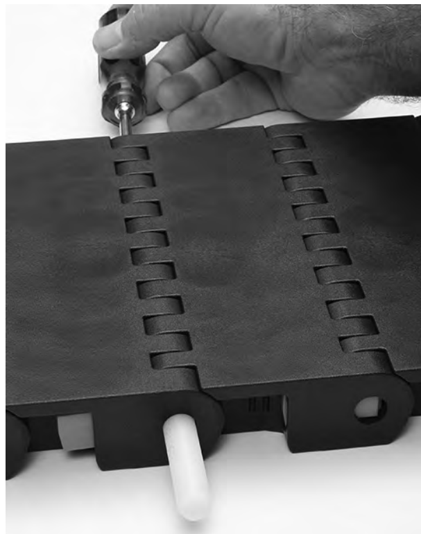
Rysunek 268: Wypchnięcie pinu z taśmy
