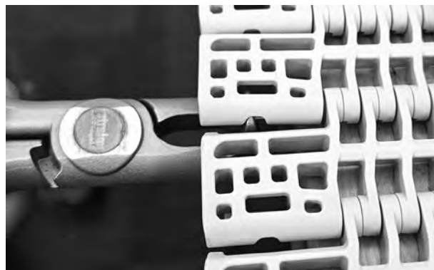
Rysunek 126: Chwytanie pinu za pomocą narzędzia do demontażu pinów
