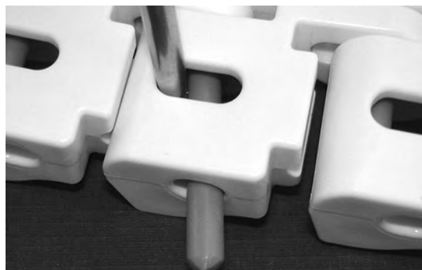
Rysunek 290: Wciskanie pinu przez element retencyjny
