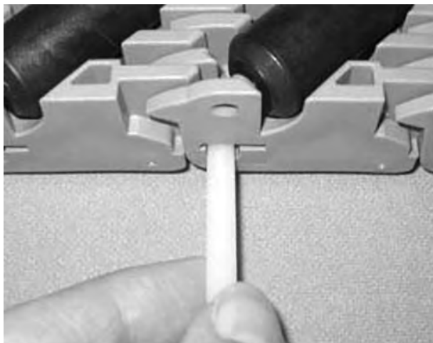
Rysunek 231: Wsuwanie pinu przez zawiasy
