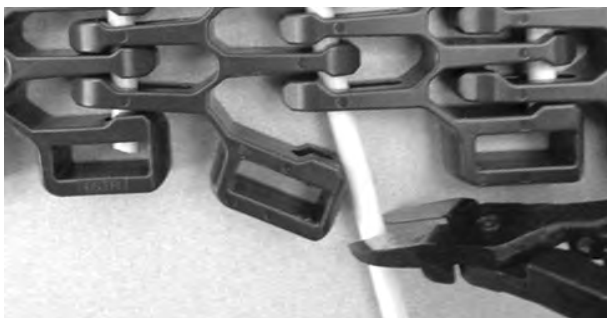
Rysunek 334: Wyciągnięcie pinu z taśmy
