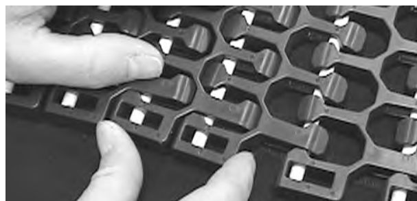
Rysunek 313: Upewnienie się, że pin jest całkowicie wsunięty
