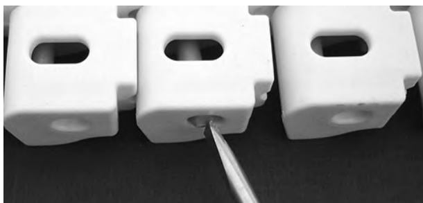
Rysunek 288: Wciśnij pin za element retencyjny
