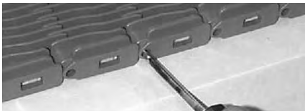
Rysunek 50: Wypchnięcie pinu z taśmy
