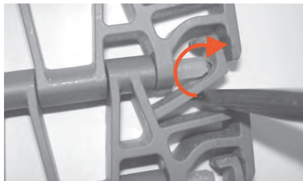
Rysunek 254: Obrócenie wkrętaka w celu utrzymania elementu retencyjnego w pozycji otwartej
