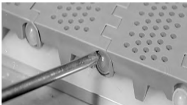
Rysunek 65: Upewnienie się, że pin znajduje się za zapięciem zatrzaskowym
