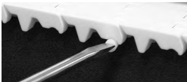
Rysunek 175: Wciśnij pin za element retencyjny
