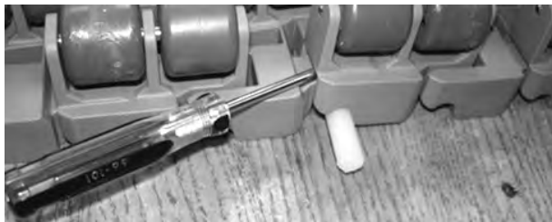
Rysunek 196: Wyciągnij pin z taśmy
