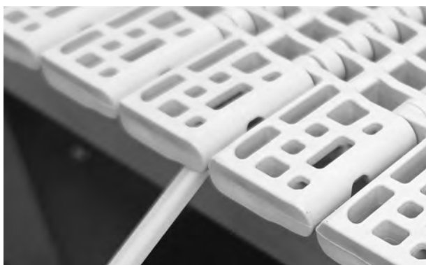
Rysunek 124: Wsuwanie pinu pod gładki brzeg
