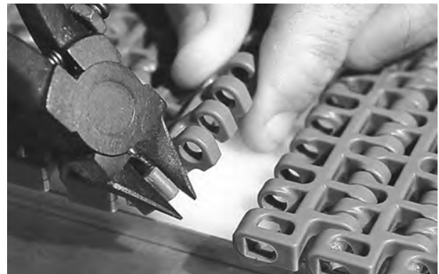
Rysunek 153: Odcięcie brzegu taśmy
