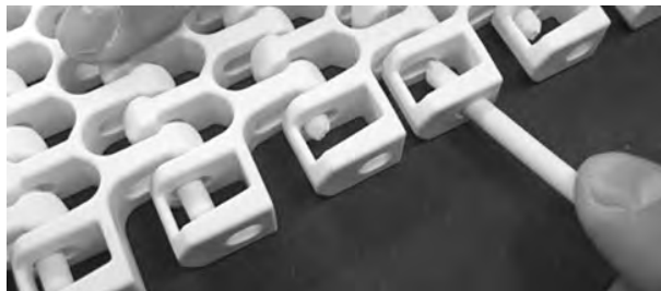
Rysunek 292: Wsuwanie pinu przez zawiasy
