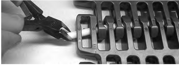
Rysunek 339: Wyciągnij pin z taśmy
