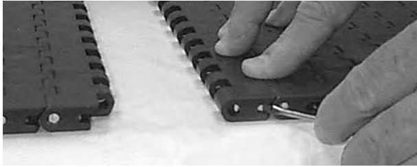
Rysunek 163: Zamykanie elementu Slidelox
