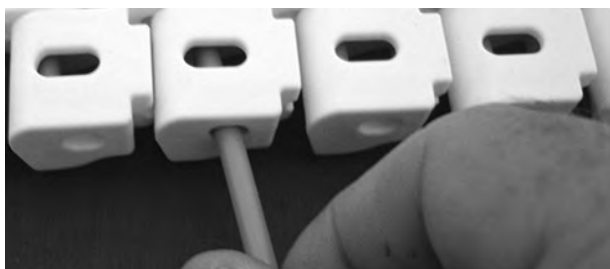
Rysunek 287: Wsuwanie pinu przez zawiasy
