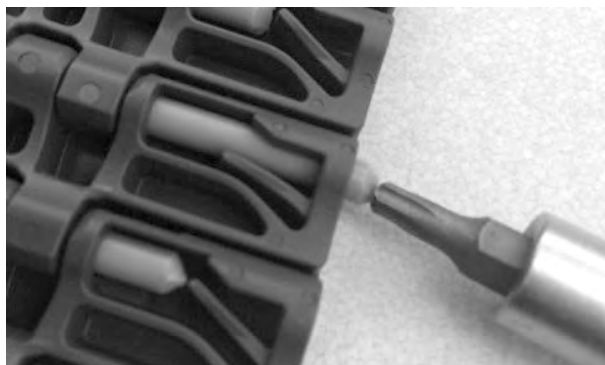
Rysunek 129: Wciśnij pin za element retencyjny
