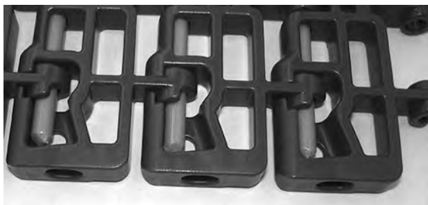
Rysunek 113: Zwiększenie wielkości pinu w gładkim brzegu
