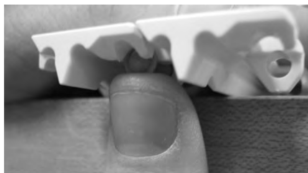
Rysunek 181: Wciśnij pin za element retencyjny
