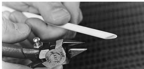
Rysunek 20: Przycięcie pinu pod kątem
