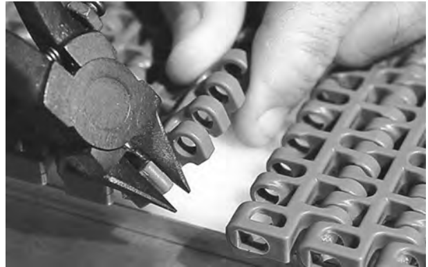
Rysunek 143: Odcięcie brzegu taśmy
