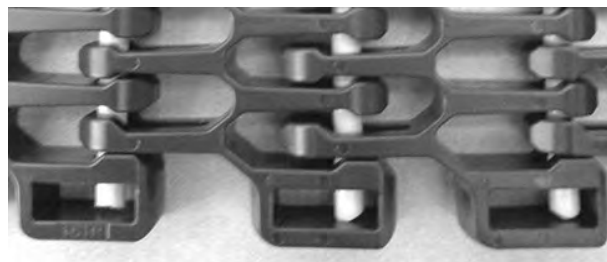
Rysunek 331: Upewnienie się, że pin jest całkowicie wsunięty
