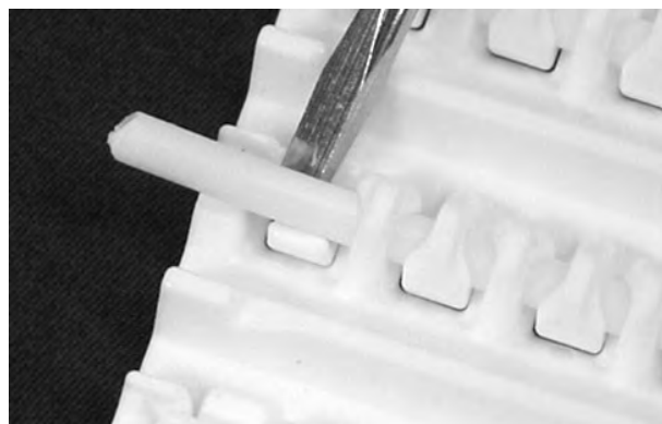
Rysunek 177: Unoszenie pinu ponad element retencyjny
