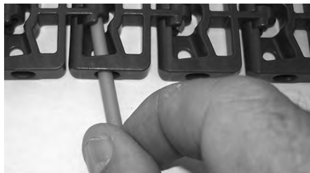
Rysunek 119: Wsuwanie pinu przez zawiasy
