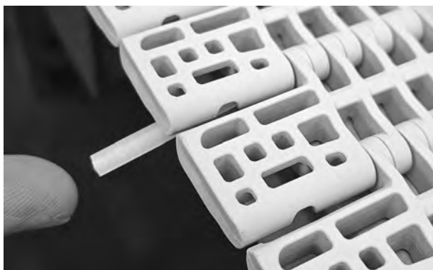
Rysunek 125: Wciskanie pinu do zatrzaśnięcia w gładkim brzegu
