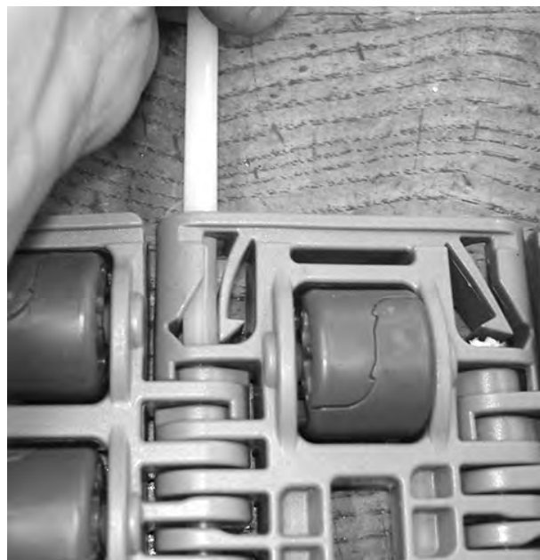
Rysunek 222: Wypchnięcie pinu z taśmy
