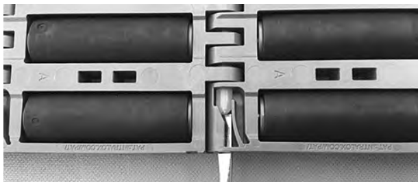
Rysunek 242: Wciśnij pin za element retencyjny
