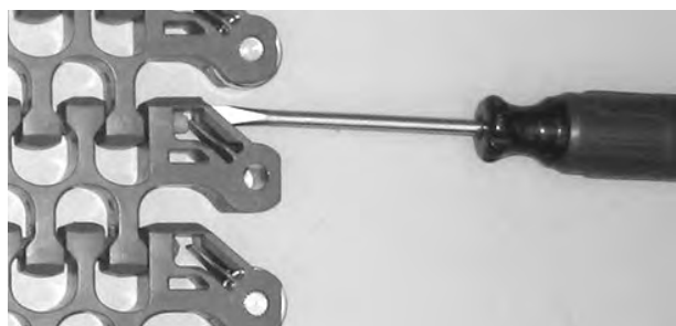
Rysunek 303: Otwieranie elementu retencyjnego
