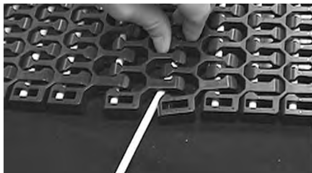
Rysunek 310: Wyrównanie zawiasów
