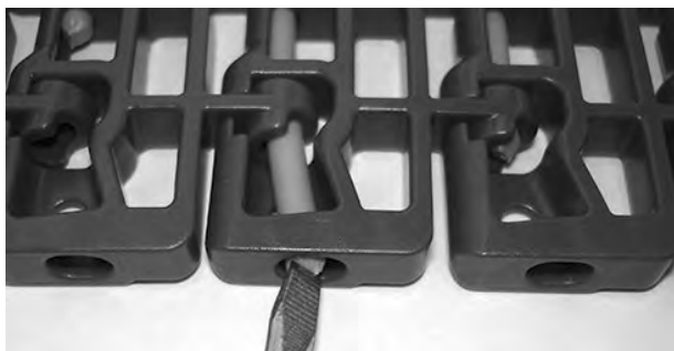
Rysunek 120: Wciśnij pin za element retencyjny
