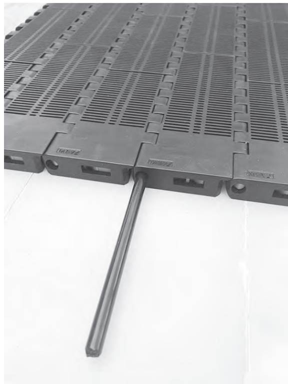
Rysunek 211: Wsuwanie pinu
