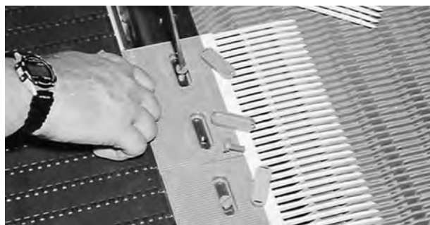
Rysunek 24: Mocowanie palcowych płytek transferowych przy użyciu śrub Intralox z tworzywa sztucznego
