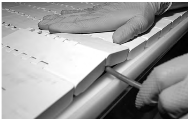
Rysunek 89: Lekkie zgięcie i wsunięcie pinu przez zawiasy
