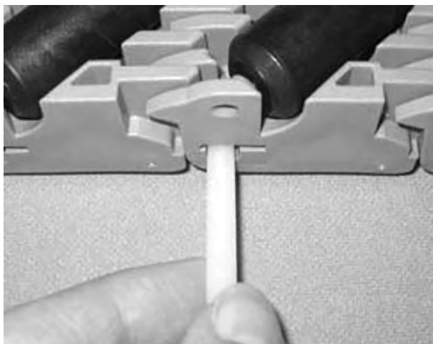
Rysunek 225: Wsuwanie pinu przez zawiasy
