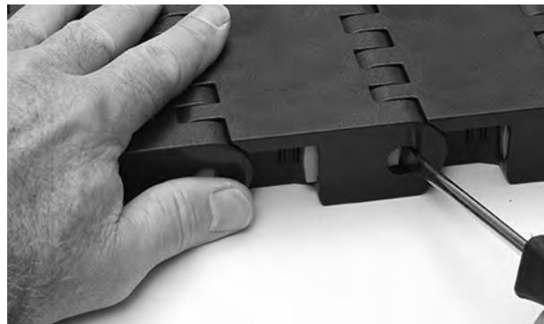
Rysunek 267: Otwieranie elementu Slidelox
