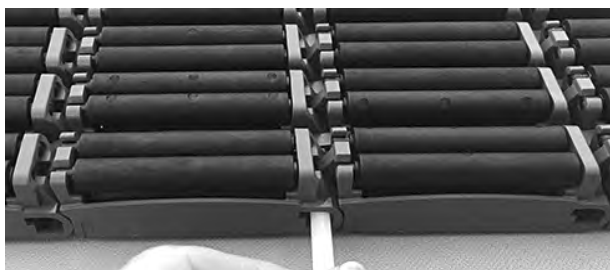
Rysunek 241: Wsuwanie pinu przez zawiasy
