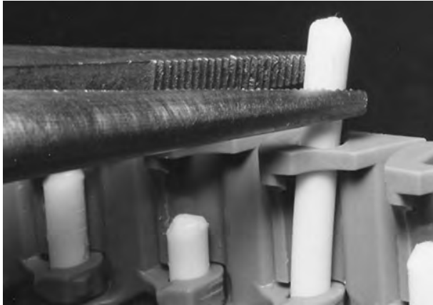
Rysunek 150: Wyciągnij pin z taśmy
