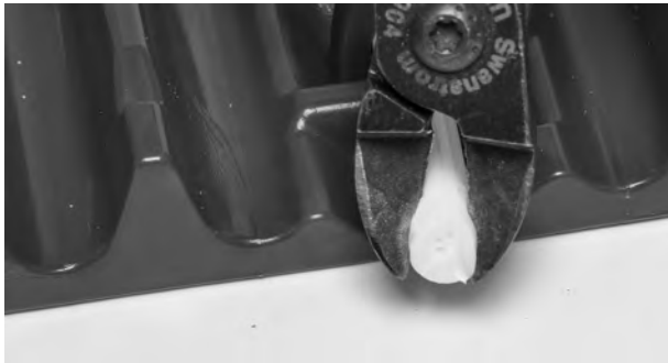
Rysunek 97: Wyciąganie pinu z taśmy
