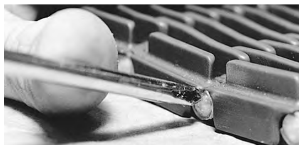
Rysunek 108: Upewnienie się, że pin znajduje się za zapięciem zatraskowym
