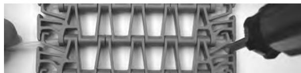
Rysunek 255: Wypchnięcie pinu z taśmy
