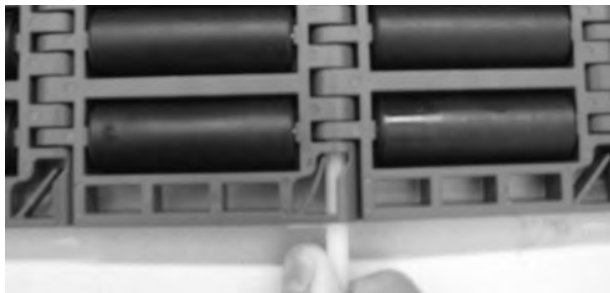
Rysunek 237: Wsuwanie pinu przez zawiasy
