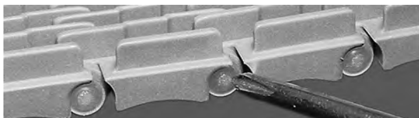
Rysunek 29: Upewnienie się, że pin znajduje się za zapięciem zatrzaskowym
