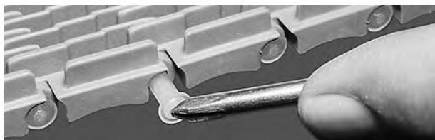
Rysunek 28: Wciśnięcie pinu do taśmy
