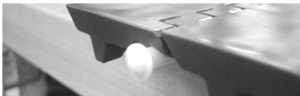
Rysunek 68: Wsuwanie pinu przez zawiasy
