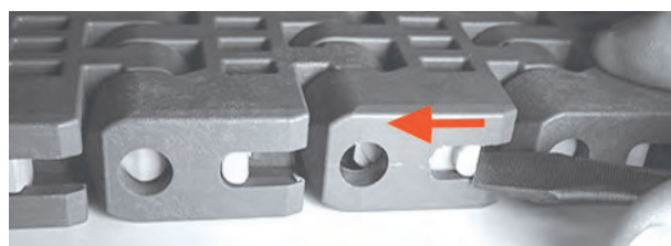
Rysunek 157: Zamykanie elementu Slidelox
