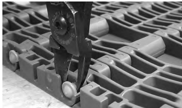
Rysunek 273: Przycięcie krótkiego pinu
