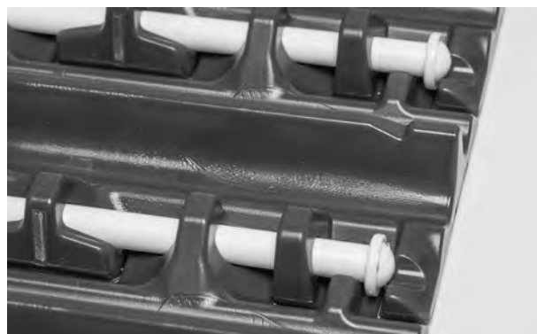
Rysunek 95: Upewnienie się, że pin znajduje się za elementem retencyjnym
