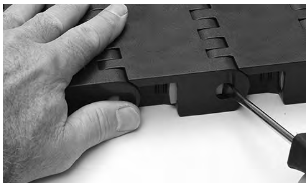
Rysunek 262: Otwieranie elementu Slidelox
