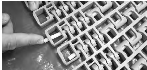
Rysunek 343: Wciśnij pin za element retencyjny
