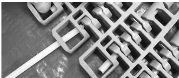
Rysunek 342: Wsuwanie pinu przez zawiasy
