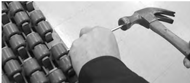
Rysunek 195: Wypchnięcie pinu z taśmy
