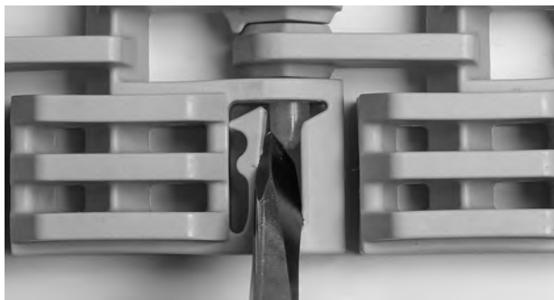
Rysunek 86: Wciskanie pinu za element retencyjny
