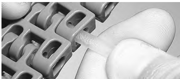
Rysunek 136: Wsuwanie pinu przez zawiasy
