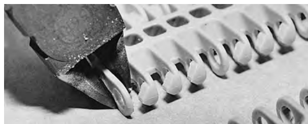
Rysunek 32: Odcięcie zewnętrznego ogniwa
