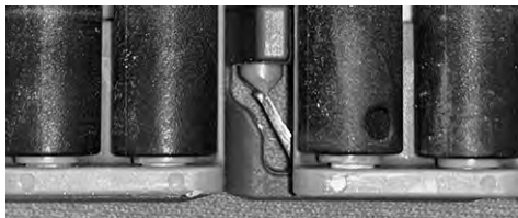
Rysunek 249: Upewnienie się, że pin znajduje się za elementem retencyjnym
