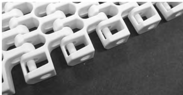
Rysunek 294: Upewnienie się, że pin znajduje się za elementem retencyjnym
