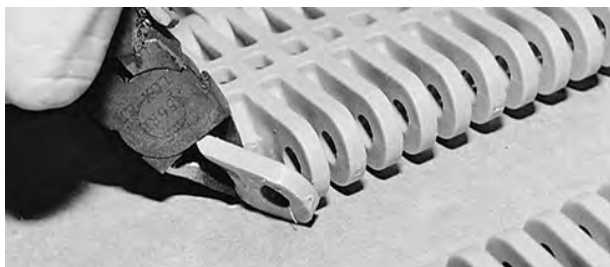
Rysunek 52: Odcięcie zewnętrznego ogniwa
