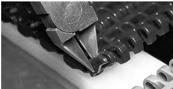
Rysunek 151: Odcięcie elementu brzegowego
