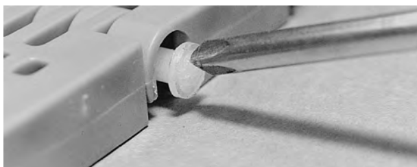
Rysunek 43: Wciśnięcie pinu do taśmy
