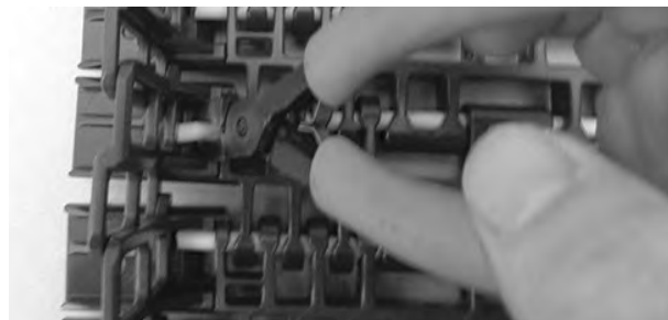
Rysunek 372: Wciśnij pin za element retencyjny
