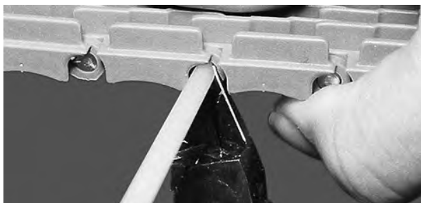
Rysunek 30: Przycięcie pinu równo z brzegiem taśmy
