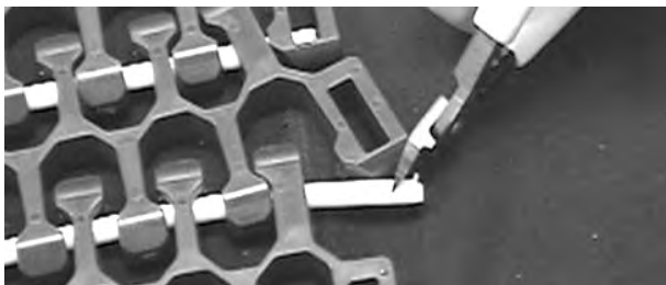
Rysunek 317: Wyciągnij pin z taśmy
