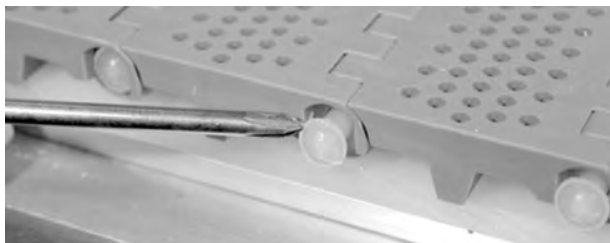
Rysunek 64: Wciśnięcie pinu do taśmy
