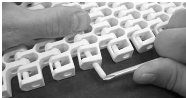
Rysunek 293: Wciśnij pin za element retencyjny
