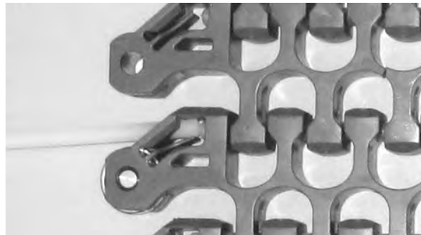
Rysunek 304: Wyciągnij pin z taśmy
