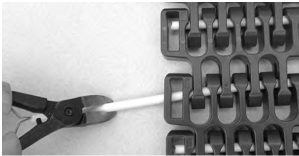
Rysunek 322: Wyciągnij pin z taśmy
