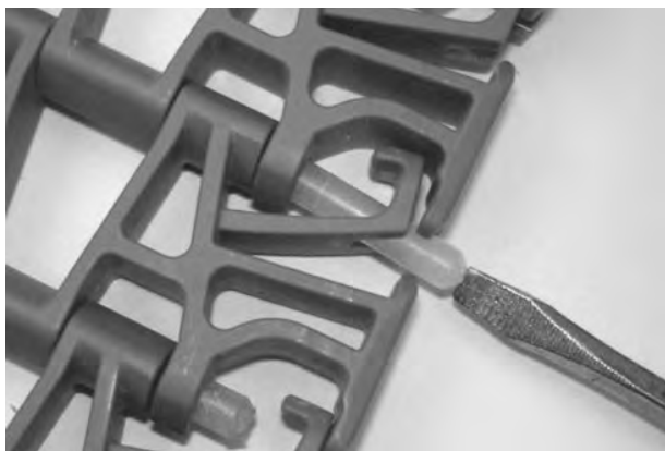
Rysunek 252: Wciśnij pin za element retencyjny
