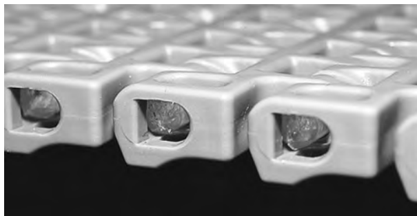
Rysunek 138: Upewnienie się, że pin znajduje się za elementem retencyjnym
