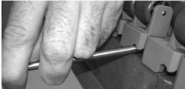
Rysunek 194: Wsuniecie pinu stalowego przez zawias
