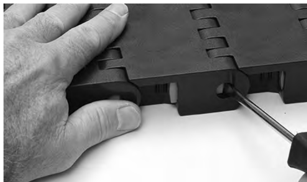
Rysunek 265: Otwieranie elementu Slidelox
