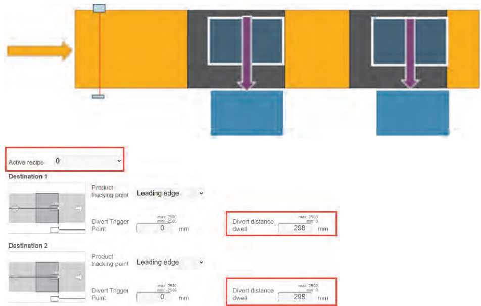
图 87: 配方 0 - 较大的货品，较长的激活时间
