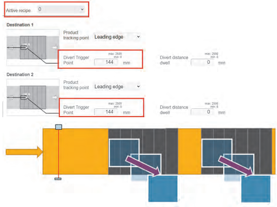
图 89: 配方 0-较大的货品，较小的分流触发点
