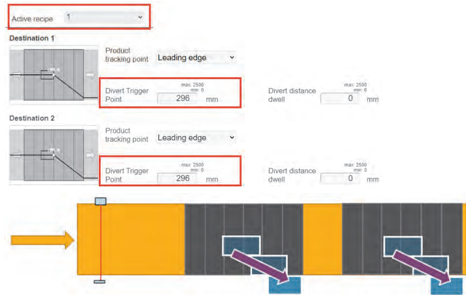
图 90: 配方 1-较小的货品，较大的分流触发点
