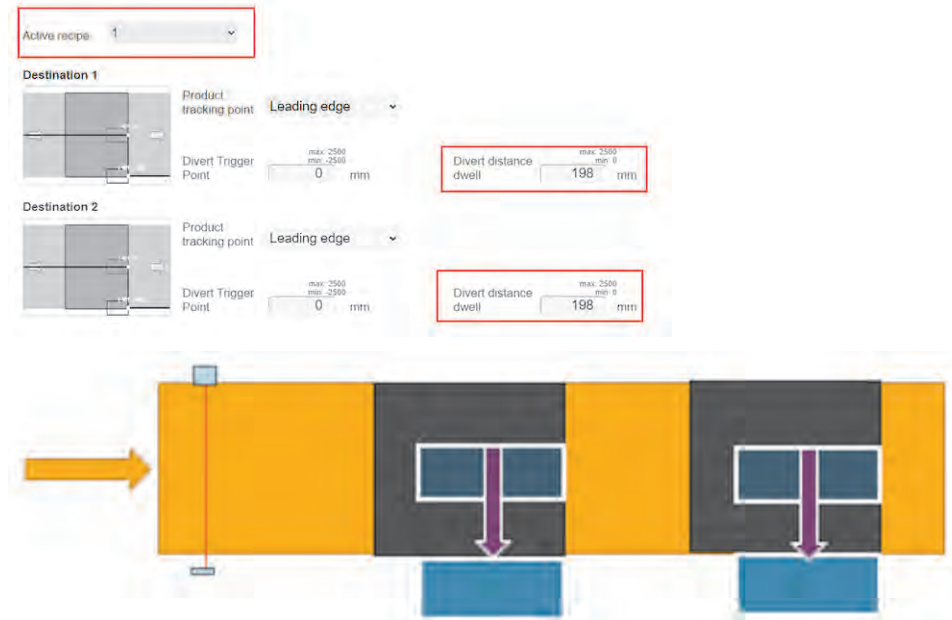
图 88: 配方 1 - 较小的货品，较短的激活时间
