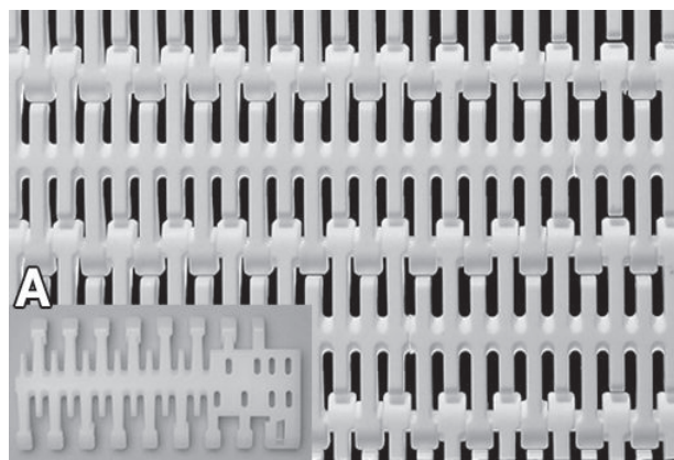
A Inset: polyethylene edge module
