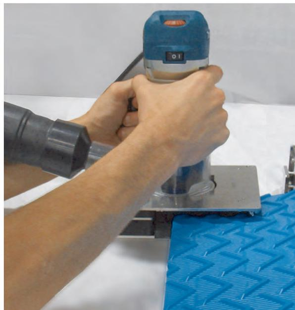
Figure 59: Kit de fraiseuse pour extrémités de tapis
