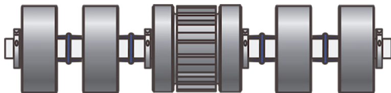
Figura 1: Engrenagem/roda de suporte espaçada (engrenagem com orifício quadrado de 6 pol de largura)
