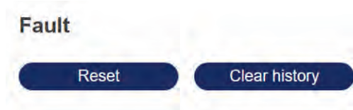
Figura 15: Reset dei guasti e cancellazione della cronologia nella pagina Guasti dell'HMI
