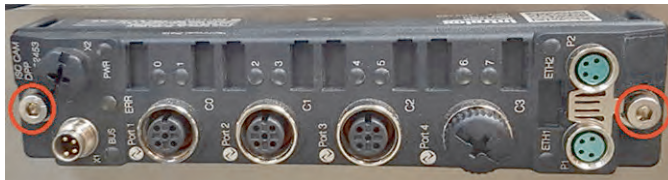
Figura 10: Viti di montaggio ISC CAM
