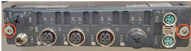
Figura 11: Viti di montaggio ISC CAM
