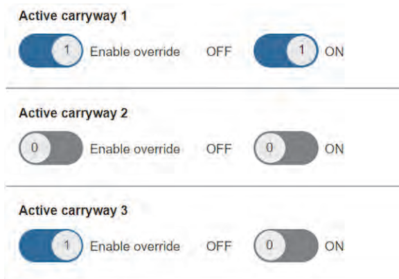
Abbildung 105: Ventilübersteuerungen auf der HMI-Seite „IO-COMM“ (E/A-Kommunikation)
