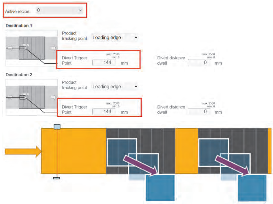
Abbildung 89: Rezept 0 – größeres Produkt, kleinerer Auslösepunkt für die Umlenkung
