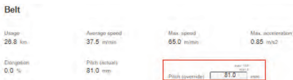
Abbildung 102: Übersteuerung der Bandteilung auf der HMI-Seite Maintenance (Wartung)
