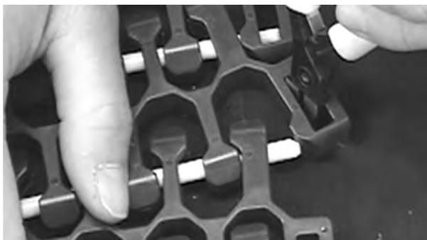
**Figure 310:** Pliez le bord lisse du module pour libérer l'axe
