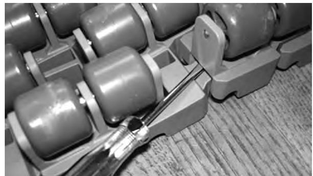
Figure 192: Introduisez le tournevis sous le rouleau
