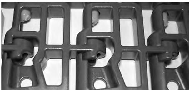
**Figure 116:** Les axes se déplacent à l'intérieur du bord lisse
