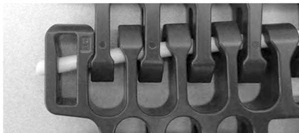
**Figure 314:** insérez l'axe dans le système de rétention
