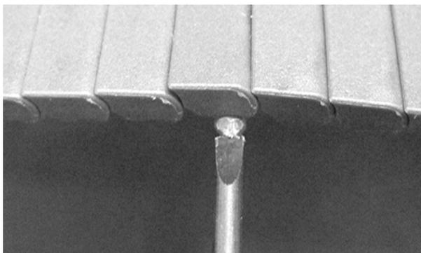
**Figure 54:** Poussez la tête de l'axe au-delà du système de rétention
