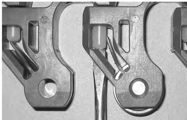
Figure 300: insérez l'axe dans le système de rétention
