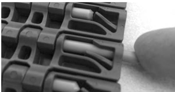
Figure 127: Insérez l'axe à travers les charnières
