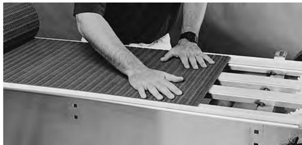
Figure 8: Installez le tapis en partant de l'extrémité d'entraînement
