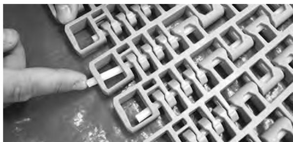
**Figure 338:** insérez l'axe dans le système de rétention
