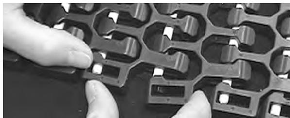
Figure 307: Enfoncez l'axe au-delà du bord du tapis et encliquez le bord lisse sur l'axe
