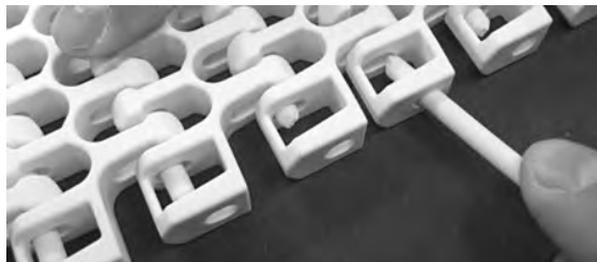
**Figure 287:** Insérez l'axe à travers les charnières
