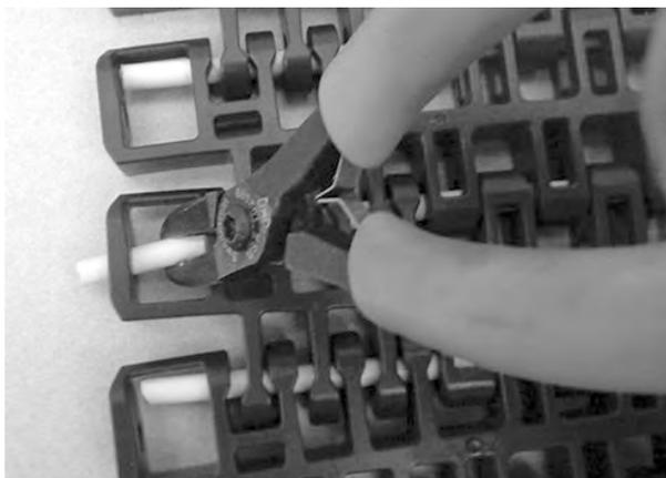
Figure 357: insérez l'axe dans le système de rétention
