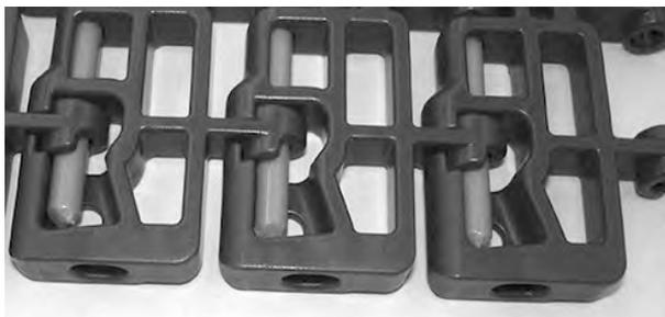
**Figure 117:** L'axe s'étend sur le bord lisse
