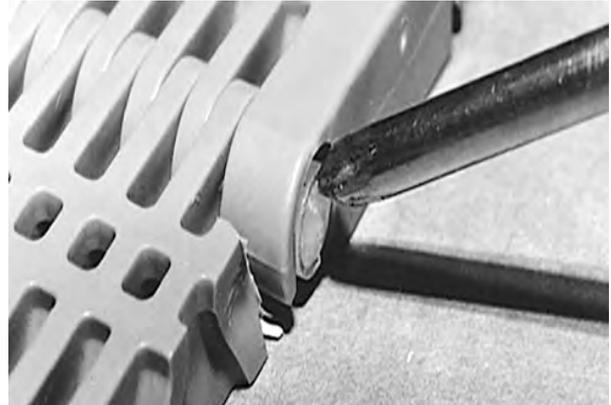
**Figure 48:** Poussez la tête de l'axe au-delà du système de rétention
