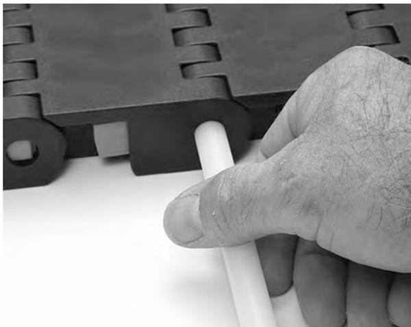
**Figure 261:** Insérez l'axe
