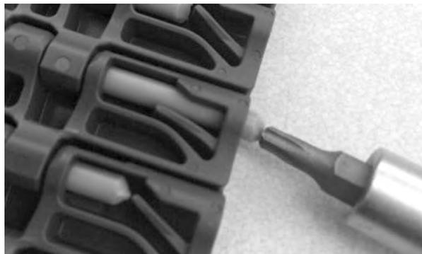
Figure 128: insérez l'axe dans le système de rétention
