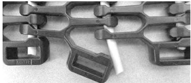
**Figure 325:** Enfoncez l'axe au-delà du bord du tapis
