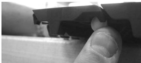
**Figure 69:** insérez l'axe dans le système de rétention
