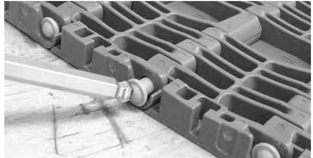
**Figure 267:** Enfoncez le petit axe au-delà du système de rétention
