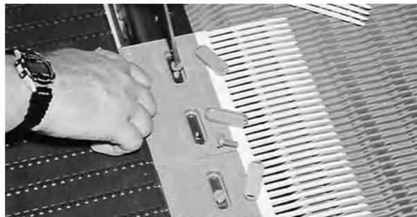
Figure 18: Installez les peignes de transfert à l'aide de boulons en plastique Intralox
