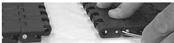
Figure 160: Utilisez un tournevis pour fermer le Slidelox
