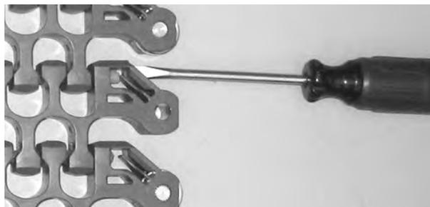
Figure 298: Système de rétention en position ouverte
