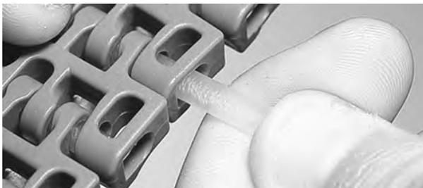
Figure 135: Insertion de l'axe à travers les charnières
