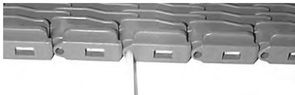
Figure 41: Insérez l'axe
