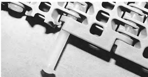
**Figure 28:** Insérez l'axe
