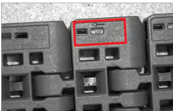
Figure 154: Sens de défilement du tapis
