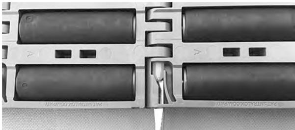
Figure 241: insérez l'axe dans le système de rétention
