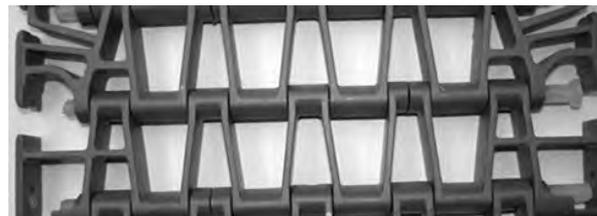
**Figure 255:** Vérifiez que l'axe est inséré au-delà du système de rétention
