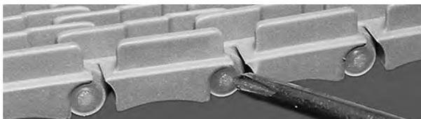
Figure 23: Vérifiez que la tête de l'axe va au-delà du clip d'arrêt
