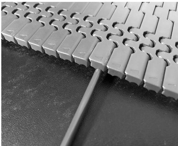
**Figure 58:** Insérez l'axe
