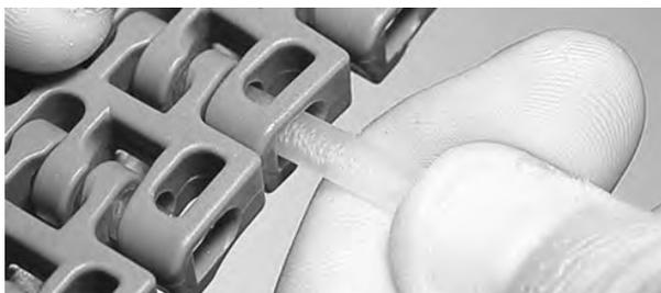
**Figure 144:** Insérez l'axe à travers les charnières
