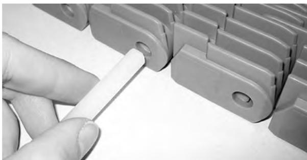
**Figure 215:** Insérez l'axe à travers les charnières
