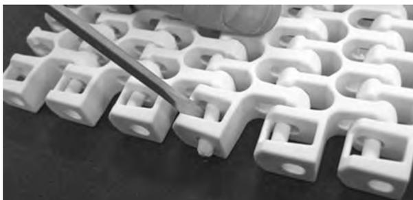
**Figure 290:** Poussez l'axe dans le système de rétention
