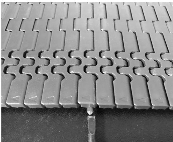
**Figure 59:** insérez l'axe dans le système de rétention
