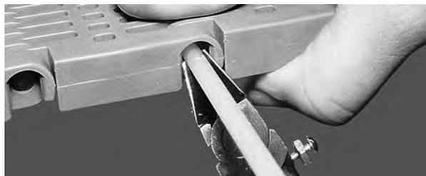
Figure 39: Coupez l'extrémité de l'axe en alignement avec le bord du tapis
