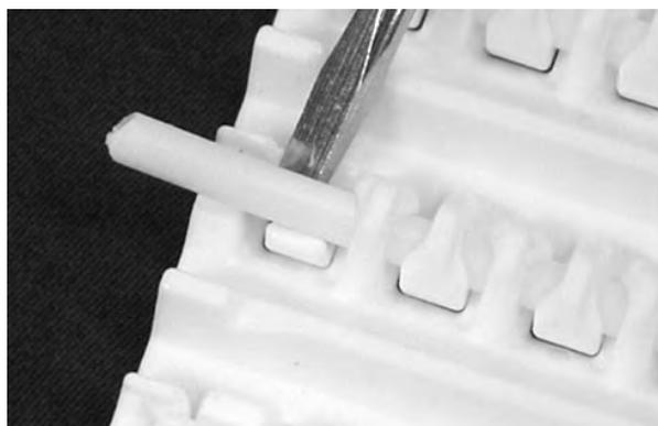
**Figure 176:** Soulevez l'axe au-dessus du système de rétention
