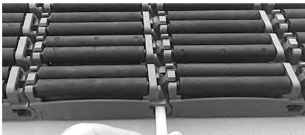
Figure 240: Insérez l'axe à travers les charnières
