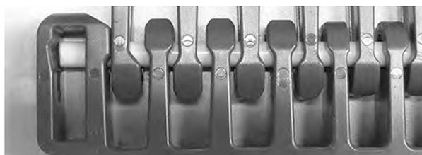
Figure 332: Vérifiez que l'axe est inséré au-delà du système de rétention
