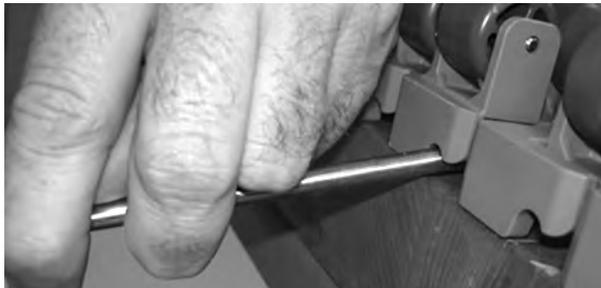
**Figure 193:** Insérez l'axe en acier dans la charnière
