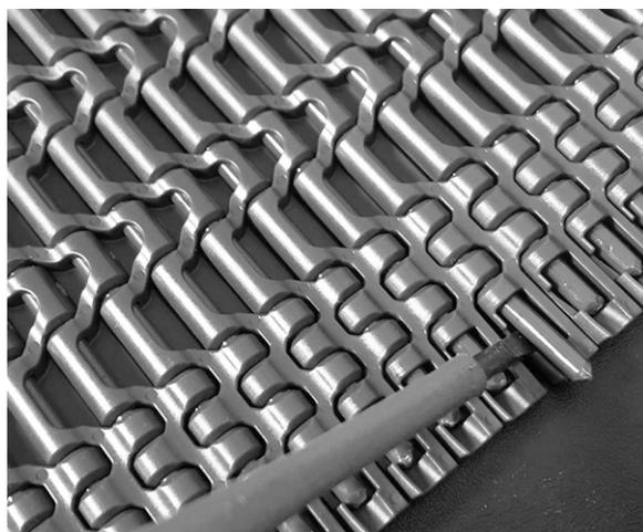
**Figure 61:** Soulevez l'axe au-dessus du système de rétention
