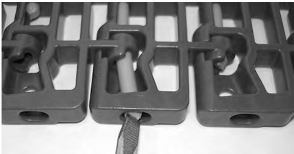
**Figure 123:** insérez l'axe dans le système de rétention
