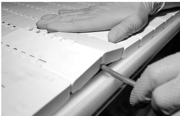
Figure 88: Pliez légèrement l'axe et insérez-le dans les charnières
