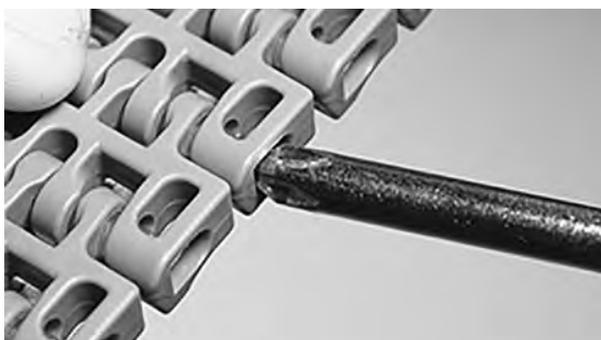
**Figure 145:** insérez l'axe dans le système de rétention
