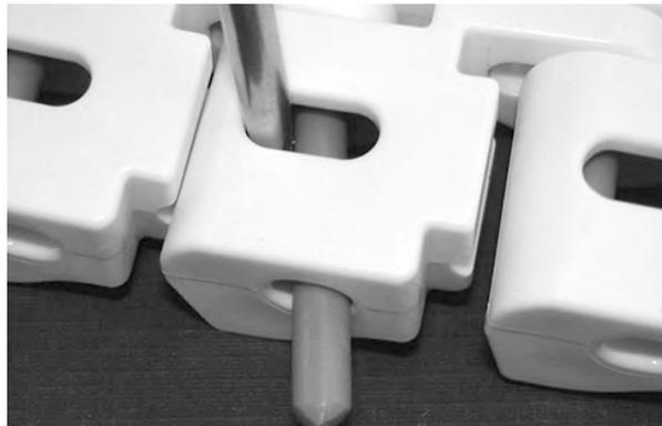
**Figure 285:** Poussez l'axe à travers le système de rétention
