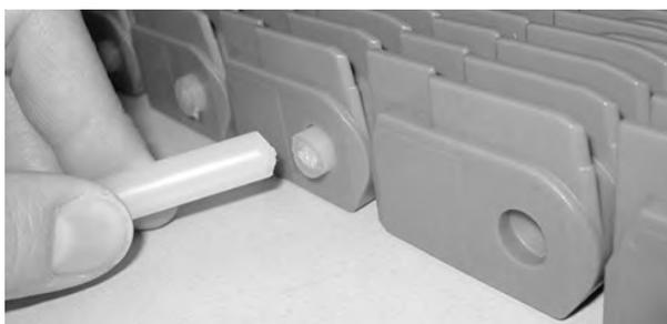
**Figure 216:** Poussez l'axe au-delà du Shuttleplug
