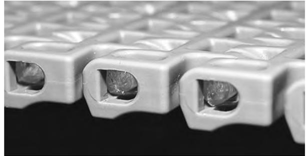
Figure 137: Vérifiez que l'axe est inséré au-delà du système de rétention
