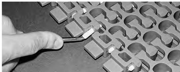
Figure 271: Vérifiez que l'axe est inséré au-delà du système de rétention
