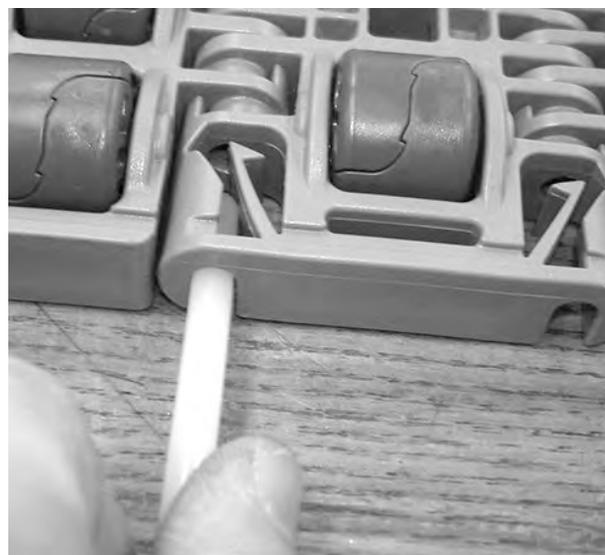
Figure 220: Système de rétention en position ouverte
