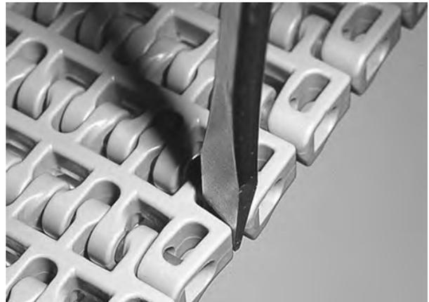
Figure 138: insérez l'axe dans le système de rétention
