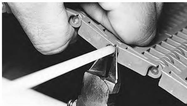
Figure 113: Coupez l'extrémité de l'axe en alignement avec le bord du tapis
