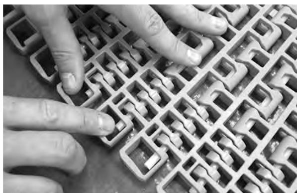
**Figure 339:** Vérifiez que l'axe est inséré au-delà du système de rétention
