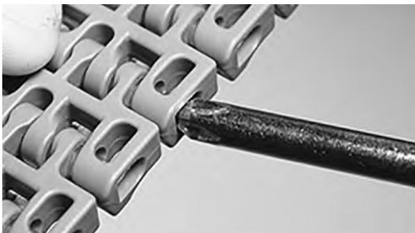
Figure 136: insérez l'axe dans le système de rétention
