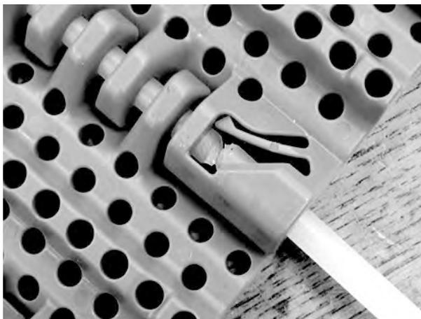
Figure 85: insérez l'axe dans le système de rétention
