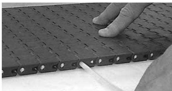
Figure 161: Insérez l'axe
