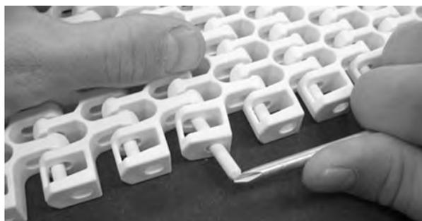
**Figure 288:** insérez l'axe dans le système de rétention
