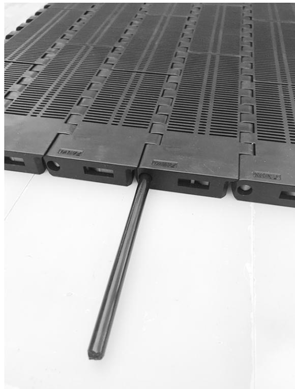
Figure 210: Insérez l'axe
