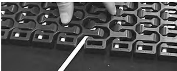
Figure 304: Insérez l'axe à travers les charnières
