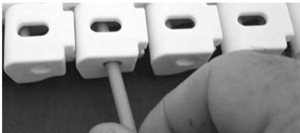
**Figure 282:** Insérez l'axe à travers les charnières
