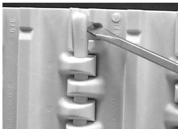
**Figure 206:** Soulevez l'axe au-dessus du système de rétention
