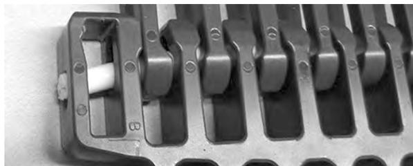
Figure 331: Insérez l'axe à travers les charnières
