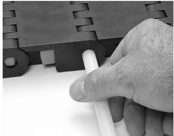
**Figure 258:** Insérez l'axe
