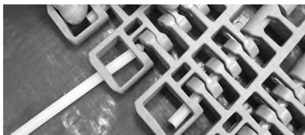
**Figure 337:** Insérez l'axe à travers les charnières
