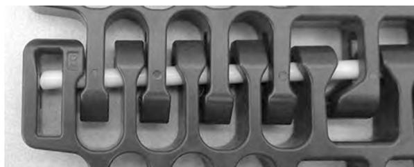
**Figure 315:** Vérifiez que l'axe est inséré au-delà du système de rétention
