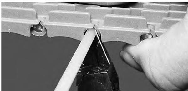
Figure 24: Coupez l'extrémité de l'axe en alignement avec le bord du tapis
