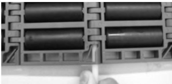
**Figure 236:** Insertion de l'axe à travers les charnières
