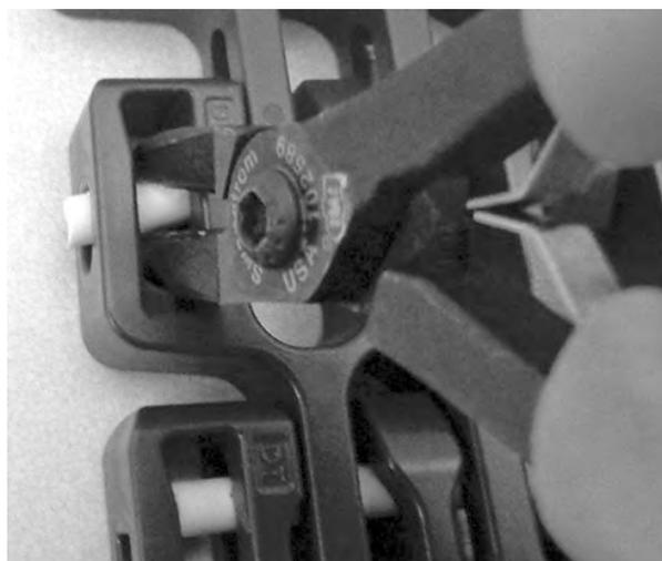
**Figure 316:** Enfoncez l'axe de biais et au-delà du trou
