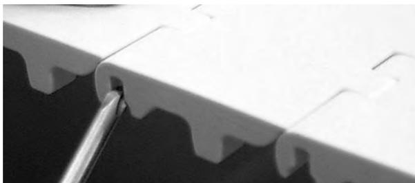
**Figure 204:** Insérez l'axe au-delà du système de rétention
