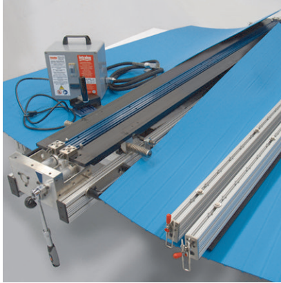
Şekil 21: ThermoDrive® Streamline Yapıştırma Seti ve bileşenleri
