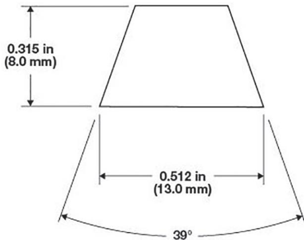
Figure 8: Géométrie nominale du guidage en V
