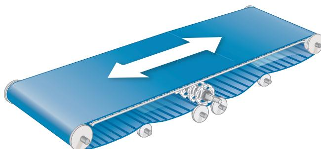
Figure 55: Emplacements du pignon d'entraînement central et du limiteur de position
