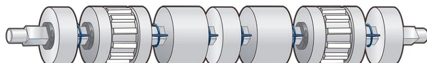
Figure 4: Pignon espacé / roue de support (pignon avec un alésage carré large de 6 pouces)
