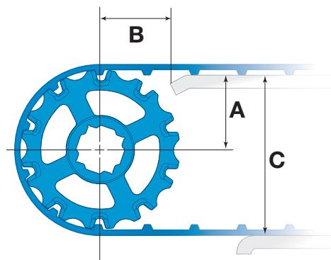
Figure 11: Dimensions de l'extrémité d'entraînement
