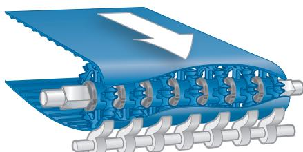
Figure 47: Installation des pignons extérieurs
