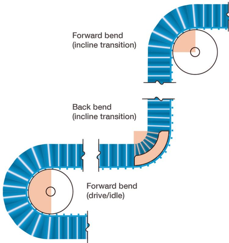
Figure 6: Angle d'enroulement élevé (voir le tableau suivant : Données relatives au flanc synchronisé S8050)
