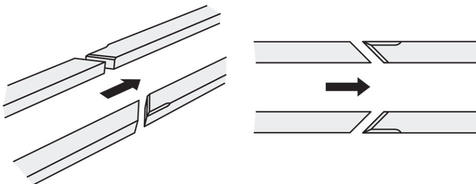
Figure 66: Rails chanfreinés à un angle de 45 degrés
