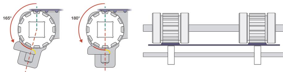
Figure 73: Positionnement du limiteur de position entre 165 degrés et 180 degrés
