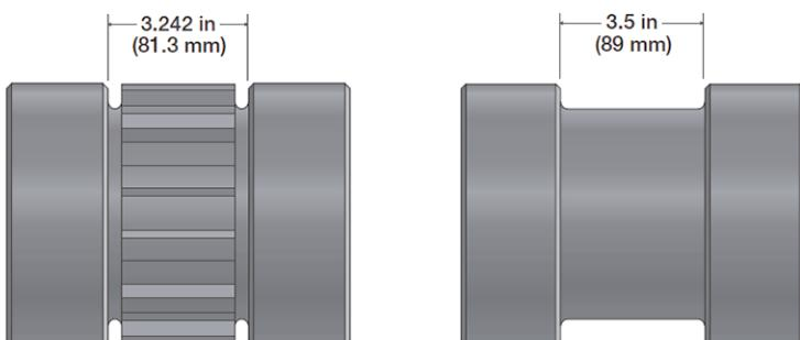
Figure 74: Dimensions internes des pignons et des rouleaux
