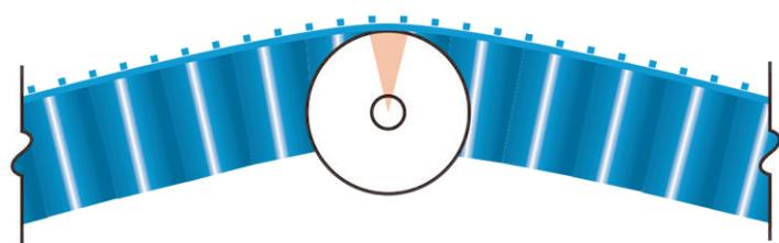
Figure 7: Angle d'enroulement faible (voir le tableau suivant : Données relatives au flanc synchronisé S8050)
