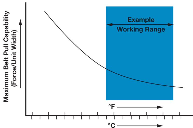
Figure 85: La température affecte la capacité de traction maximale du tapis
