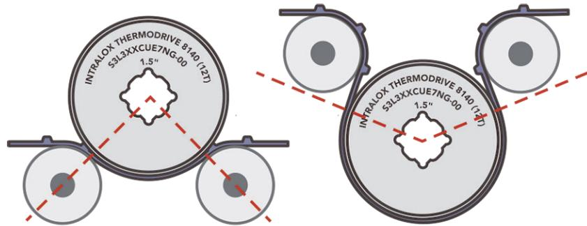
Figure 72: Engrènement du tapis dans les pignons à 90 et 225 degrés
