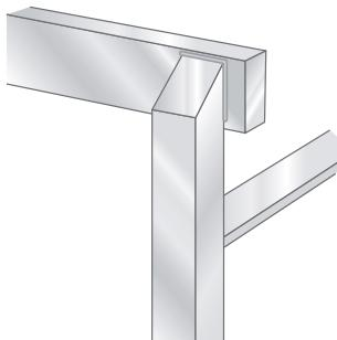
**Figure 29:** Montage adéquat du joint
