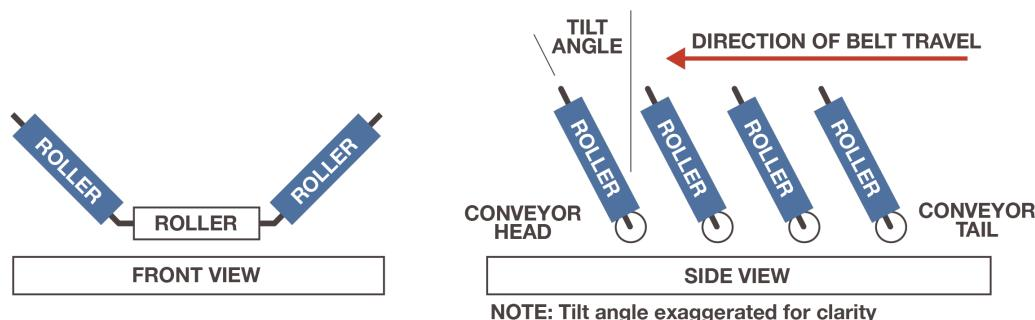
Figure 67: Angles d'inclinaison et sens de défilement du tapis
