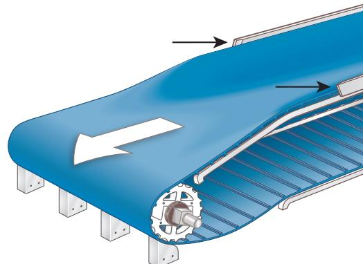
Figure 80: Rails de maintien PE-1000
