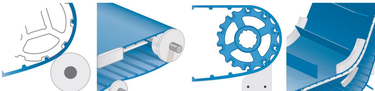
Figure 25: Composants au niveau ou au-dessus du rayon de courbure minimal
