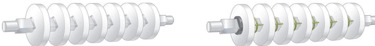
Figure 58: Circlips de retenue et entretoises de pignon
