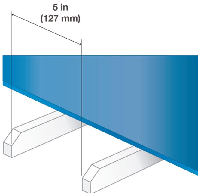
Figure 77: Alignement des ergots dans l'espacement entre les rails de maintien
