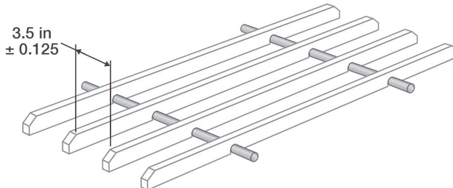
Figure 76: Dimensions de l'espacement entre les rails de maintien
