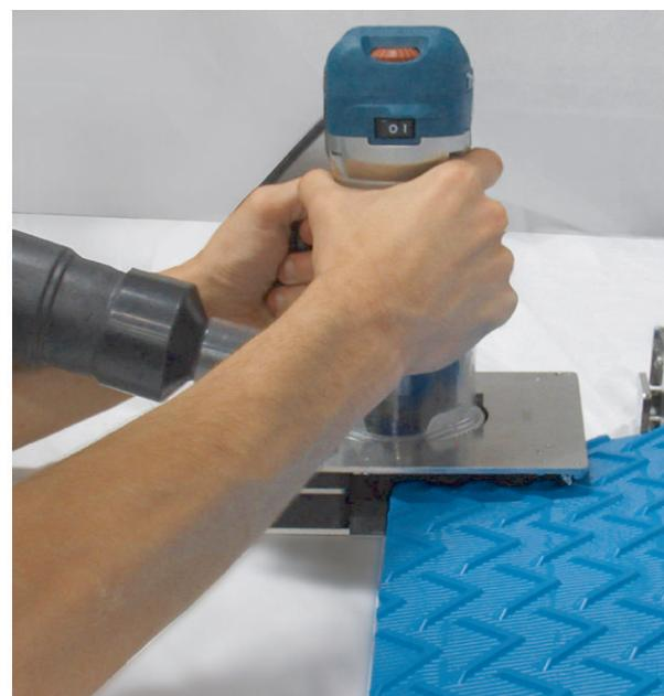
Figure 23: Kit de fraiseuse pour extrémités de tapis
