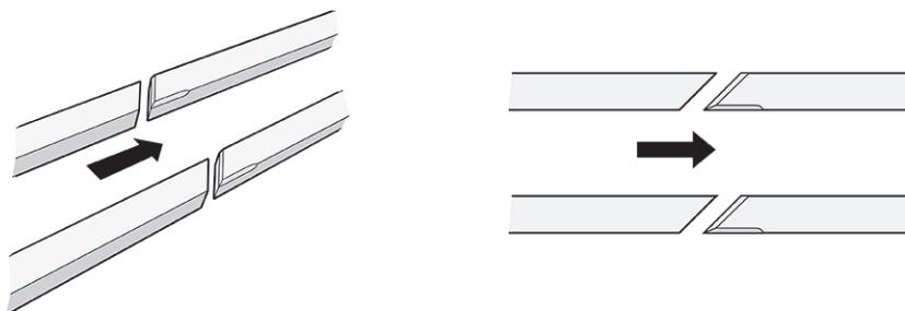
**Figure 32:** Rails chanfreinés à un angle de 45 degrés
