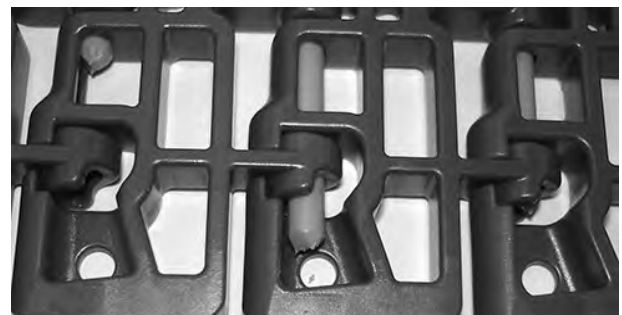
Figur 121: Sørg for, at stangen er sat helt ind
