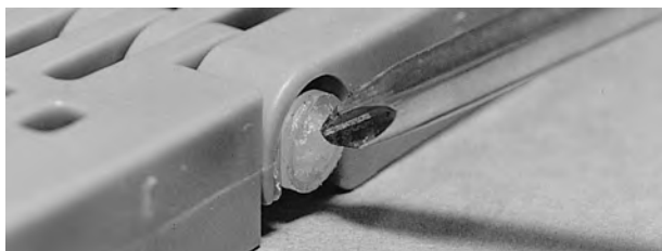
Figur 44: Kontroller, at stangens gevind er forbi snaplåsen
