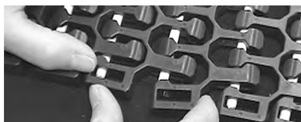
Figur 312: Skub stangen forbi båndkanten, og placer den plane kant over stangen
