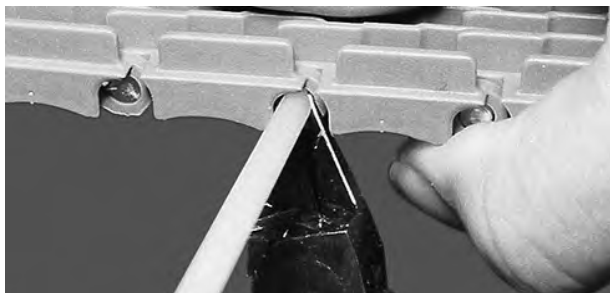
Figur 30: Skær stangen, så den flugter med båndkanten
