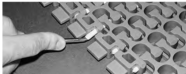
Figur 276: Sørg for, at stangen er forbi låseanordningen
