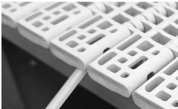
Figur 124: Indsæt stangen under den glatte kant
