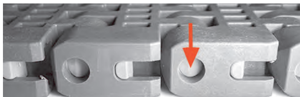
Figur 156: Søg for, at Slidelox er åben
