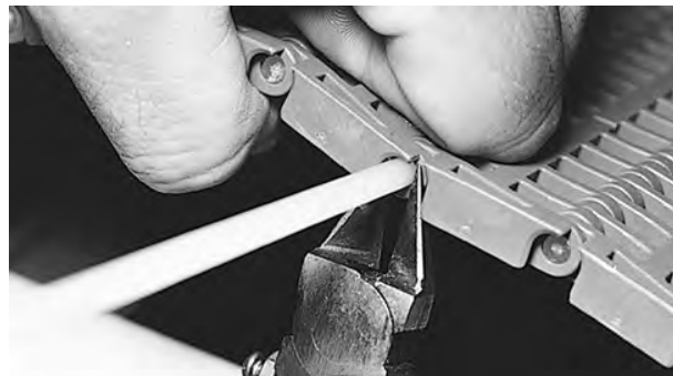
Figur 109: Skær stangen, så den flugter med båndkanten
