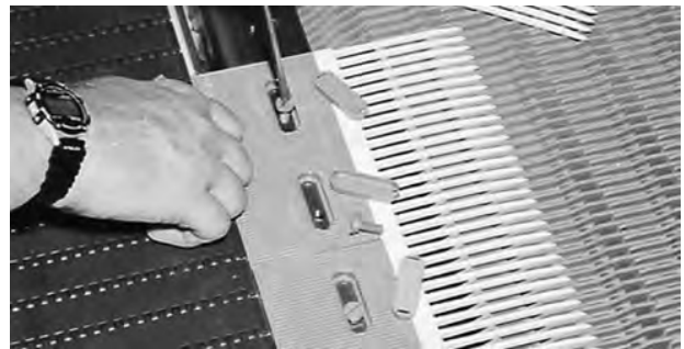
Figur 24: Monter fingeroverførselspladerne vha. Intralox-plastbolte
