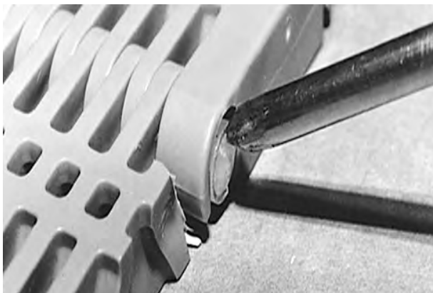
Figur 54: Skub stangens gevind forbi låseanordningen
