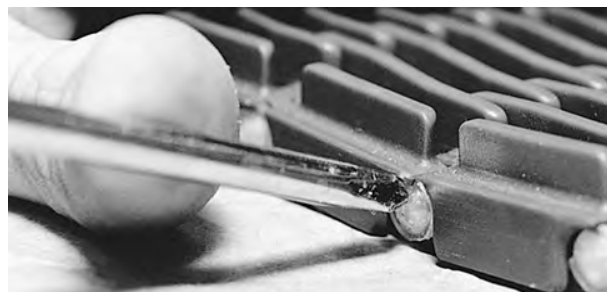
Figur 108: Kontroller, at stangen er forbi snaplåsen
