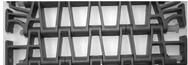
Figur 260: Sørg for, at stangen er forbi låseanordningen
