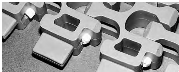
Figur 277: Sørg for, at stangen er sat helt ind
