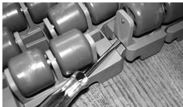
Figur 193: Stik skruetrækkeren ind under rullen
