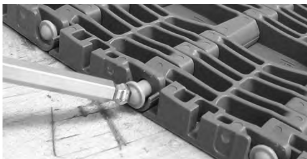
Figur 272: Skub stanggevindet forbi låseanordningen
