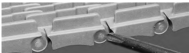
Figur 29: Kontroller, at stangens gevind er forbi snaplåsen
