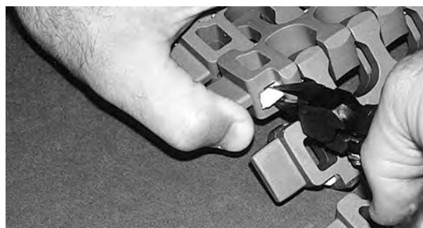
Figur 278: Frigør stangen fra låseanordningen
