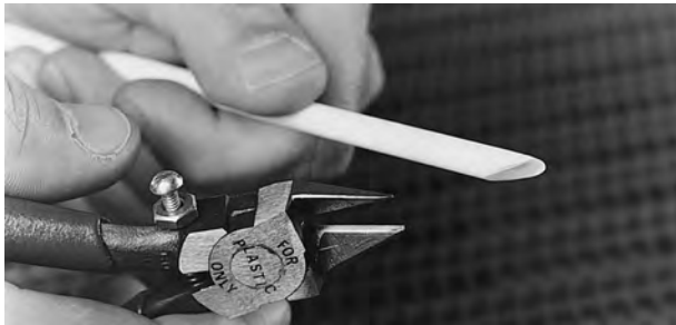
Figur 20: Klip stangen i vinkel
