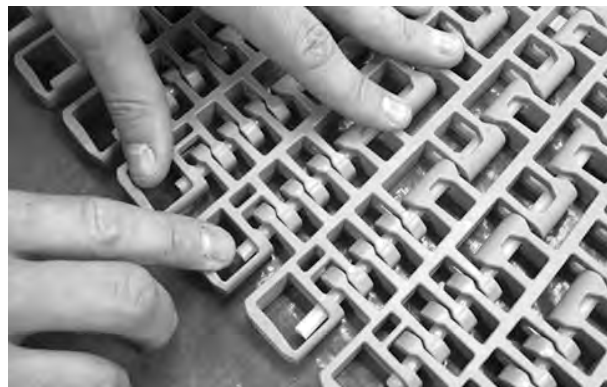
Figur 344: Sørg for, at stangen er forbi låseanordningen
