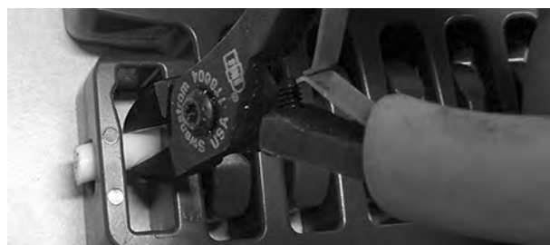
Figur 338: Skub stangen til side og forbi det blændede hul
