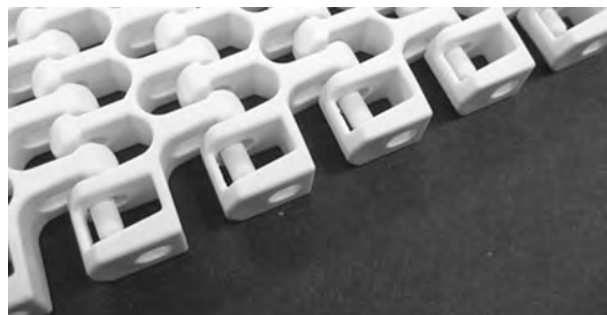
Figur 294: Sørg for, at stangen er forbi låseanordningen
