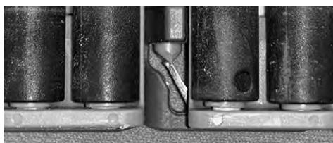
Figur 249: Sørg for, at stangen er forbi låseanordningen
