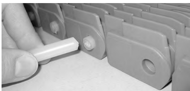
Figur 217: Skub stangen forbi Shuttleplug-enheden
