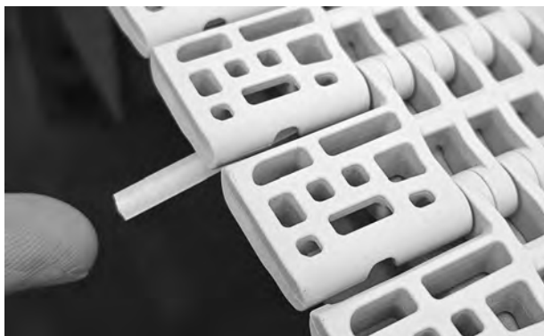
Figur 125: Skub stangen, indtil den klikker ind i den glatte kant
