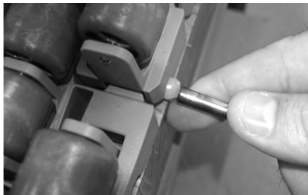
Figur 191: Skub stangen forbi låseanordningen
