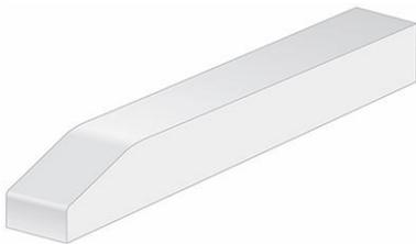
**Abbildung 25:** Endabschrägung des Gleitprofils
