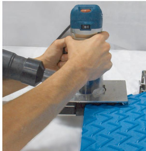
Abbildung 59: Oberfräsensatz für Bandabschluss
