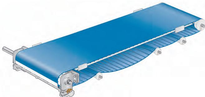
**Abbildung 1:** Band ohne Vorspannung
