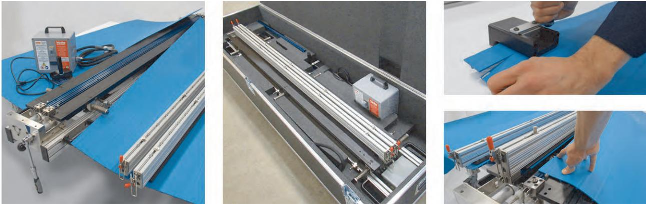
Abbildung 57: ThermoDrive-Linien-Spleißsatz und Komponenten
