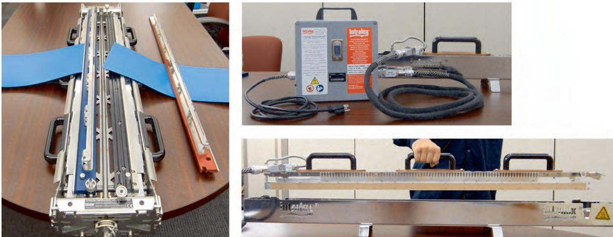
Abbildung 56: ThermoDrive-Spleißsystem v2 und Komponenten
