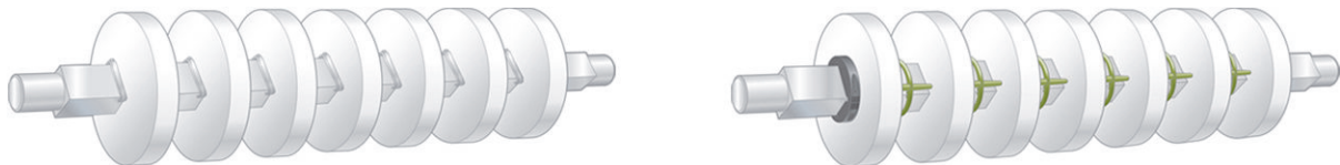
Abbildung 58: Halteringe und Abstandhalter am Zahnrad
