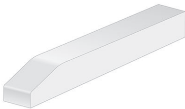
Abbildung 65: Endabschrägung der Gleitleiste
