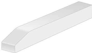
Abbildung 33: Endabschrägung der Gleitleiste
