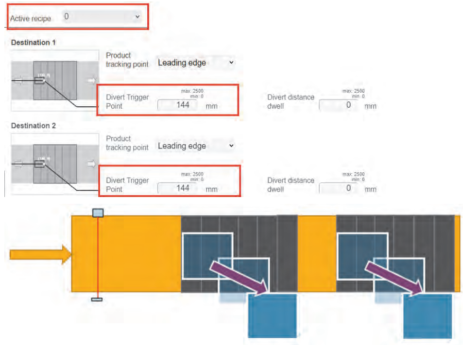
図 89: レシピ 0 - 大型搬送品、分流トリガーポイントに小さな値を設定
