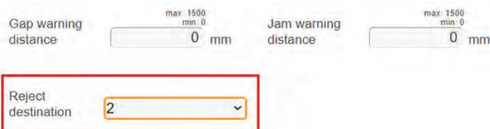
図 14: 設定 HMI ページの不良品排出先
