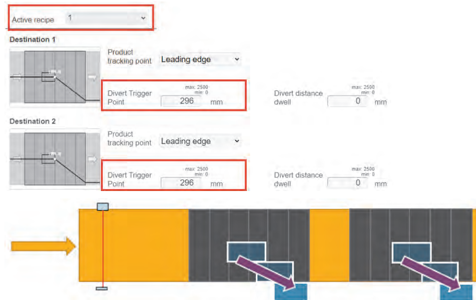
図 90: レシピ 1 - 小型搬送品、分流トリガーポイントに大きな値を設定
