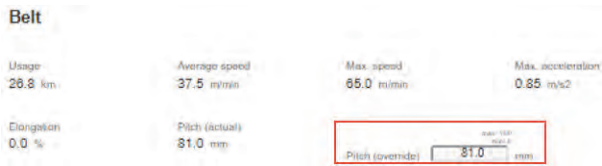
図 102: メンテナンス HMI ページでのベルトピッチのオーバーライド
