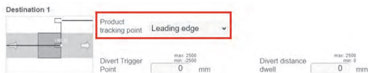
Figura 74: Parametro del punto di tracciamento del prodotto su DARB
