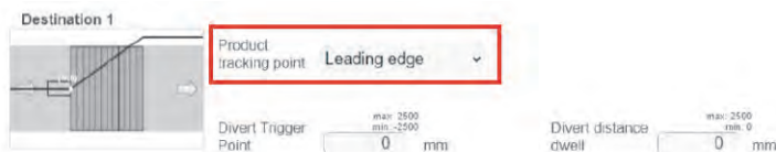
Figura 80: Parametro del punto di tracciamento del prodotto
