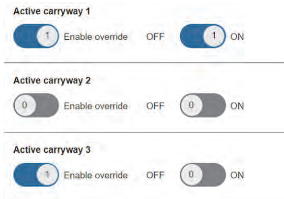
Figura 105: Esclusione valvole nella pagina IO-COMM dell'HMI
