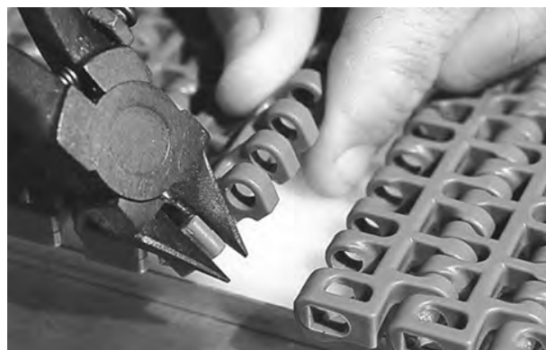
Figur 153: Klipp av kanten från bandet
