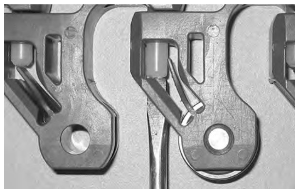
Figur 305: Skjut pinnen förbi spärranordningen
