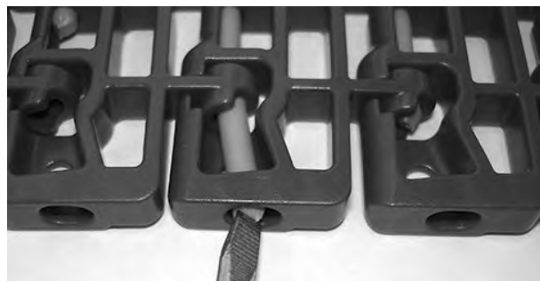
Figur 120: Tryck pinnen förbi spärranordningen
