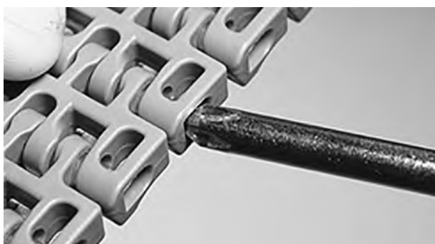
Figur 146: Tryck pinnen förbi spärranordningen
