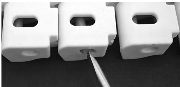
Figur 288: Skjut pinnen förbi spärranordningen
