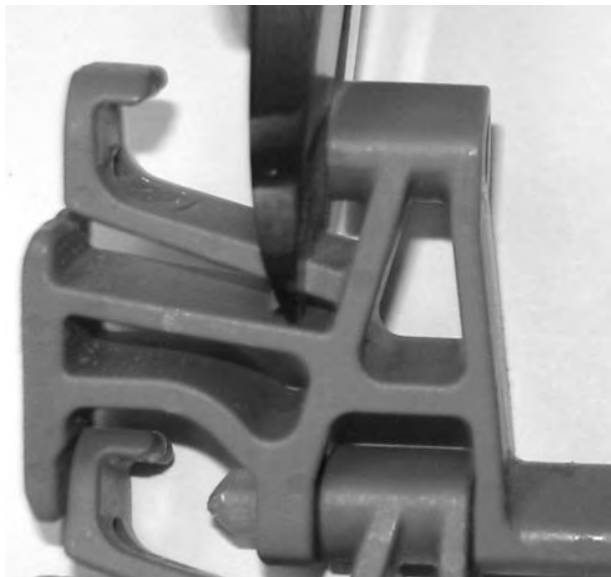
Figur 257: Klipp av spärranordningen
