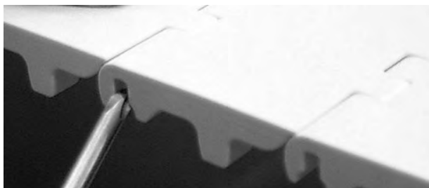
Figur 205: Tryck pinnen förbi spärranordningen
