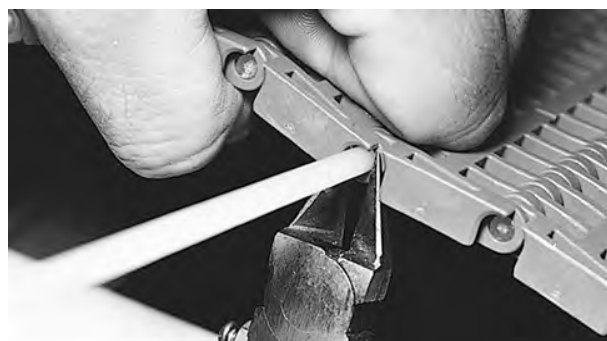
Figur 109: Klipp av pinnen plant mot bandets kant
