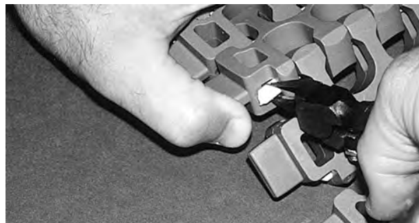
Figur 278: Frigör pinnen från spärranordningen
