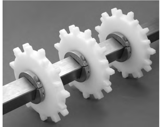
Figur 323: Sätt fast båda sidor av alla tandhjul
