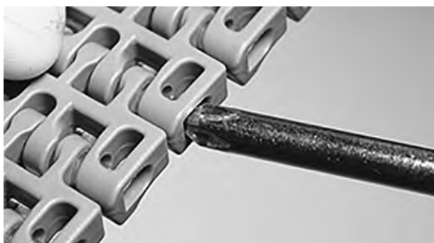
Figur 137: Tryck pinnen förbi spärranordningen
