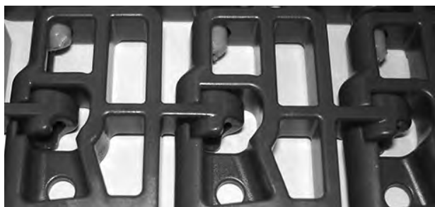
Figur 112: Pinnar rör sig inuti den jämna kanten
