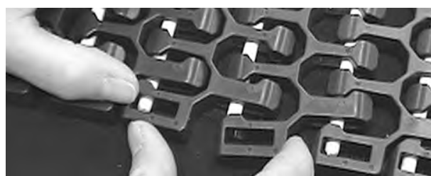
Figur 312: Skjut pinnen förbi bandkanten och snäpp den plana kanten över pinnen
