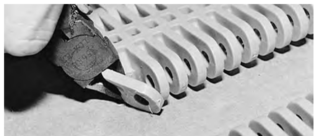
Figur 52: Klipp av den yttersta länken
