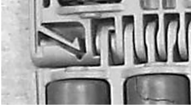
Figur 224: Se till att pinnens läge är förbi spärranordningen
