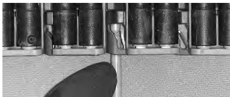
Figur 248: Skjut pinnen förbi spärranordningen
