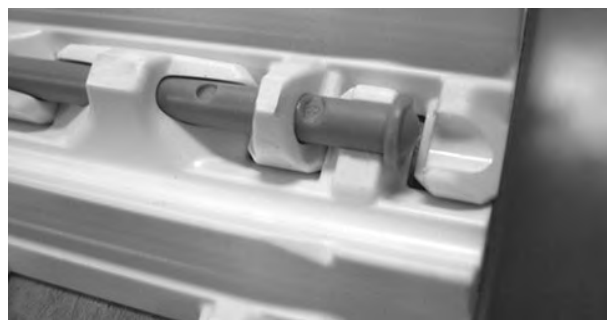
Figur 182: Se till att pinnen är helt insatt
