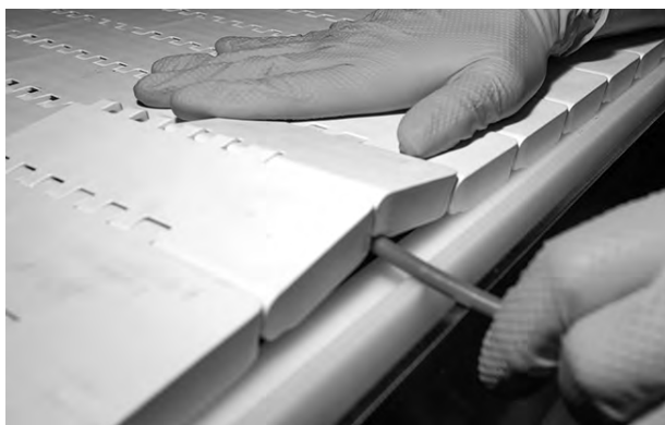
Figur 89: Böj pinnen en aning och för in den genom gångjärnen
