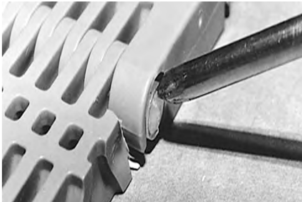
Figur 54: Tryck pinnen förbi spärranordningen
