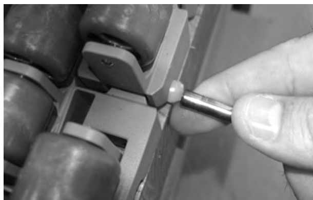
Figur 191: Skjut pinnen förbi spärranordningen
