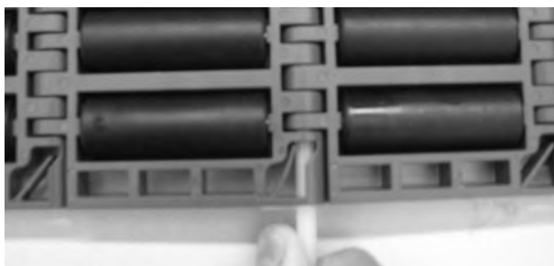
Figur 237: För in pinnen genom gångjärnen
