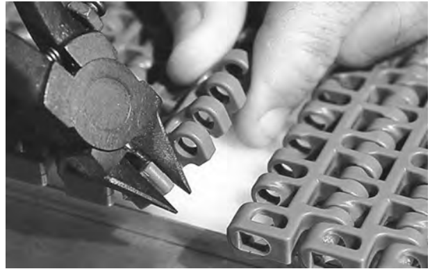
Figur 143: Klipp av kanten från bandet
