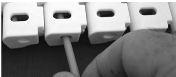
Figur 287: För in pinnen genom gångjärnen
