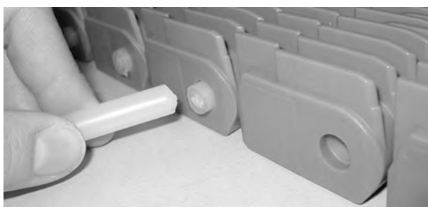
Figur 217: Tryck pinnen förbi Shuttleplug
