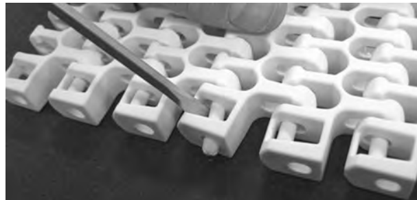
Figur 295: Tryck pinnen genom spärranordningen
