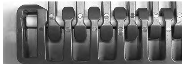
Figur 337: Se till att pinnens läge är förbi spärranordningen
