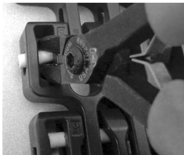
Figur 321: Tryck pinnen åt sidan och förbi hålet
