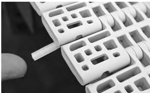
Figur 125: Tryck på pinnen tills den knapps in i den jämna kanten
