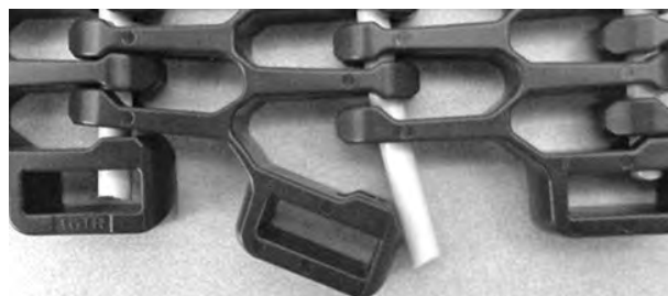
Figur 330: Skjut pinnen förbi bandkanten
