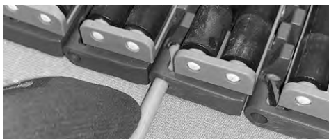
Figur 247: För in pinnen genom gångjärnen
