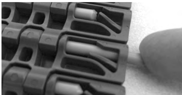
Figur 128: För in pinnen genom gångjärnet
