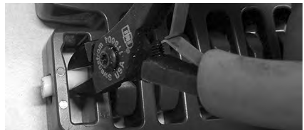
Figur 338: Tryck pinnen åt sidan och förbi det tillslutna hålet
