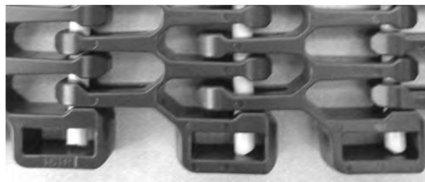
Figur 331: Se till att pinnen är helt insatt.
