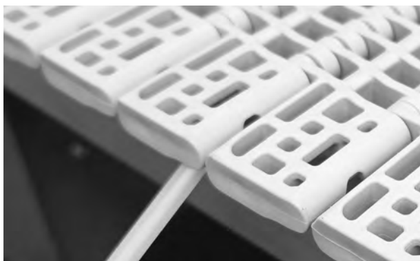
Figur 124: För in pinnen under den jämna kanten
