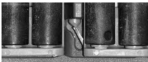
Figur 249: Se till att pinnens läge är förbi spärranordningen
