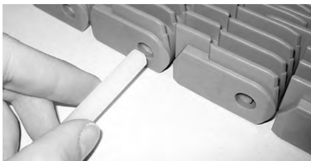
Figur 216: För in pinnen genom gångjärnen
