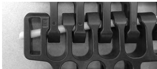
Figur 319: Tryck pinnen förbi spärranordningen
