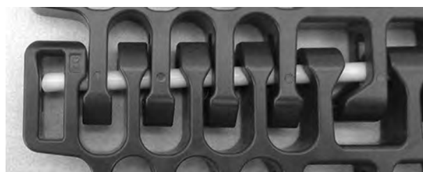
Figur 320: Se till att pinnens läge är förbi spärranordningen
