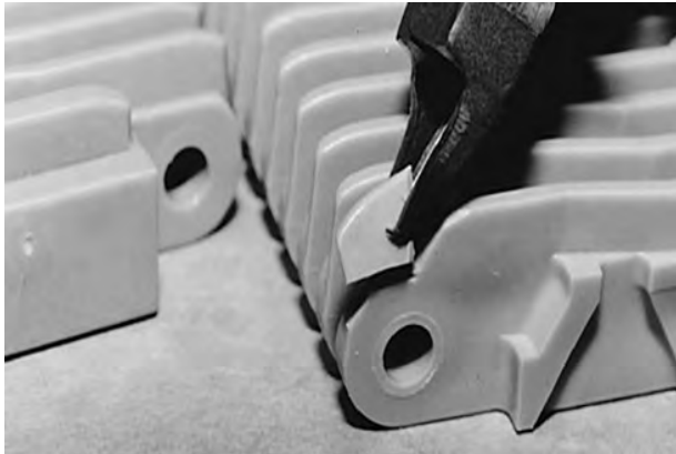
Figur 53: Klipp av den yttersta ribban
