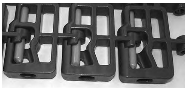
Figur 113: Pinnar växer in i den jämna kanten
