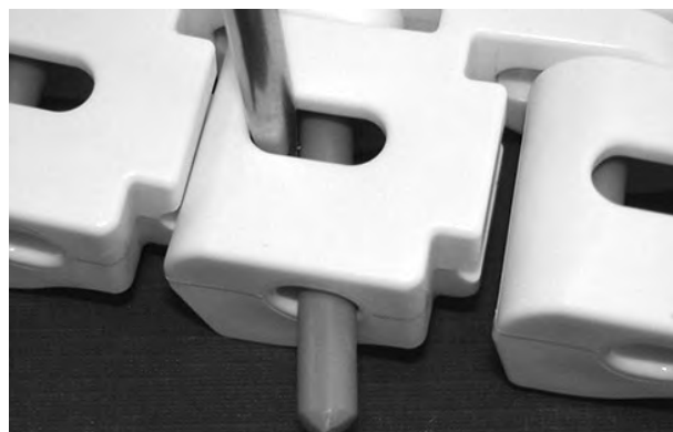
Figur 290: Tryck pinnen genom spärranordningen
