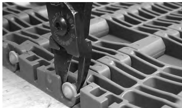
Figur 273: Klipp av kantpinne
