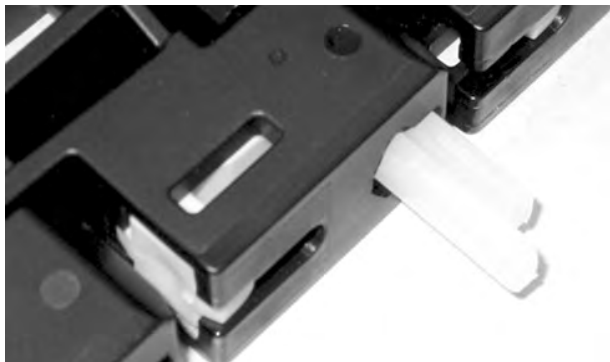
Figur 186: För in pinnen genom gångjärnen
