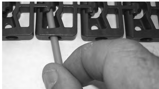
Figur 119: För in pinnen genom gångjärnen
