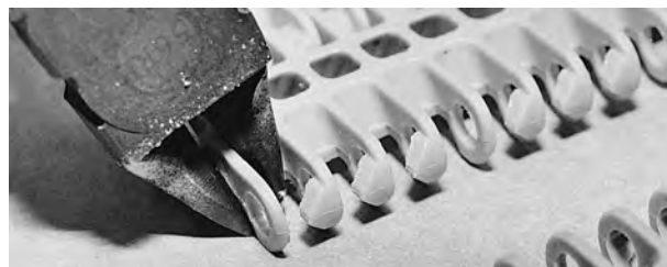
Figur 32: Klipp av den yttersta länken
