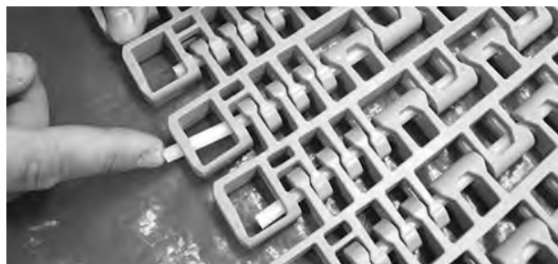
Figur 343: Tryck pinnen förbi spärranordningen
