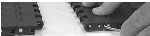
Figur 161: Använd en skruvmejsel för att stänga Slidelox
