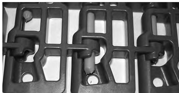
Figur 121: Se till att pinnen är helt insatt.
