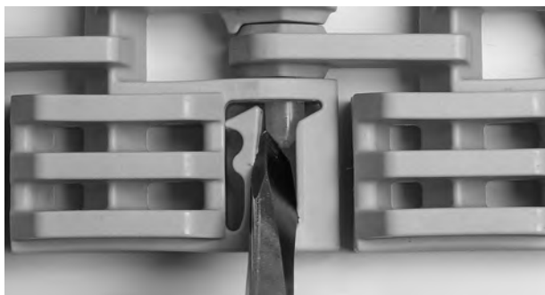
Figur 86: Skjut pinnen förbi spärranordningen
