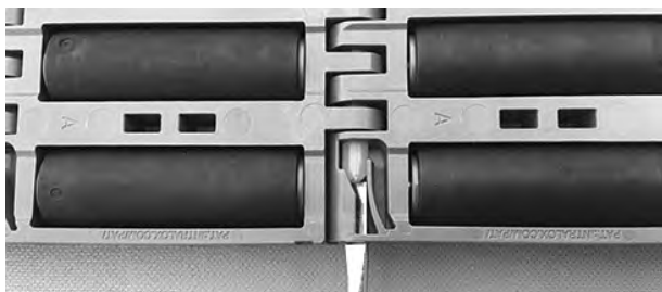
Figur 242: Skjut pinnen förbi spärranordningen
