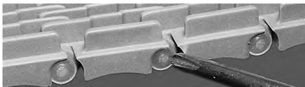
Figur 29: Se till att pinnens huvud sitter utanför snäpplåset
