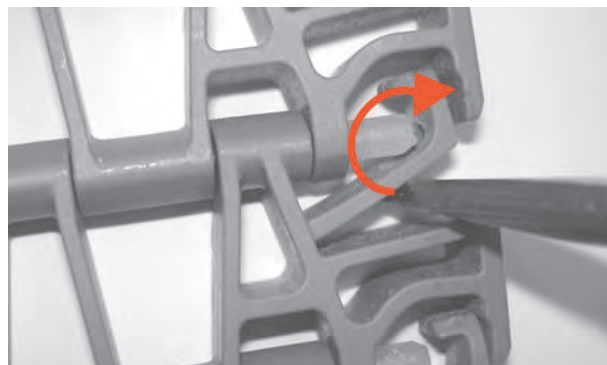
Figur 254: Vrid skruvmejseln för att hålla spärranordningen öppen
