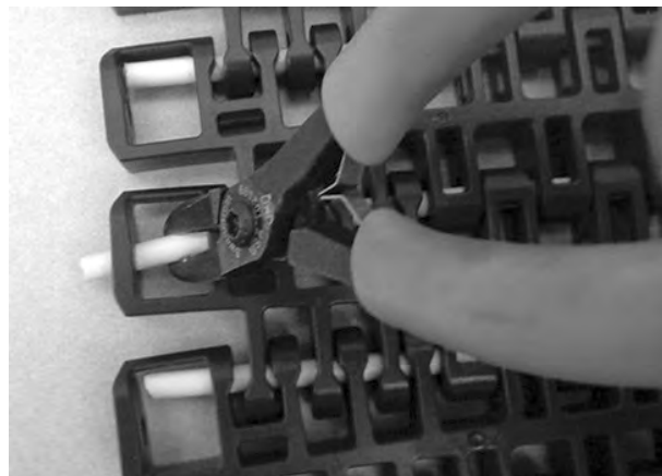
Figur 362: Tryck pinnen förbi spärranordningen
