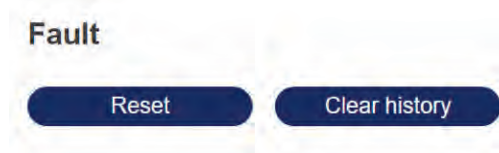
Figura 15: Redefinição de falhas e limpeza de histórico na página Faults (Falhas) da IHM
