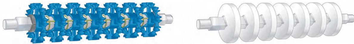
**Figura 3:** Ejes con componentes bloqueados
