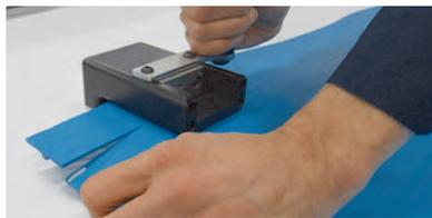
Figura 58: Herramienta de preparación manual de la banda
