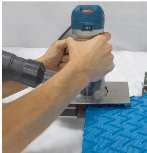
Figura 59: Conjunto de herramientas para desbarbar los extremos de las bandas
