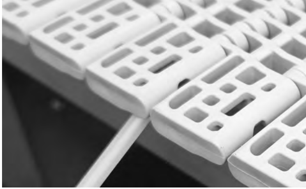
Şekil 124: Çubuğu tam düz kenarın altına takın
