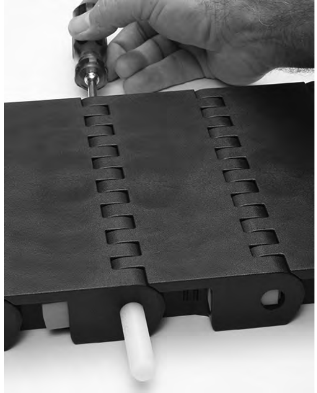
Şekil 268: Çubuğu banttan itin
