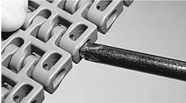
Şekil 146: Çubuğu, tutma unsurunu geçecek şekilde itme
