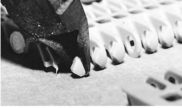
Şekil 33: Ara parça ucunu kesin
