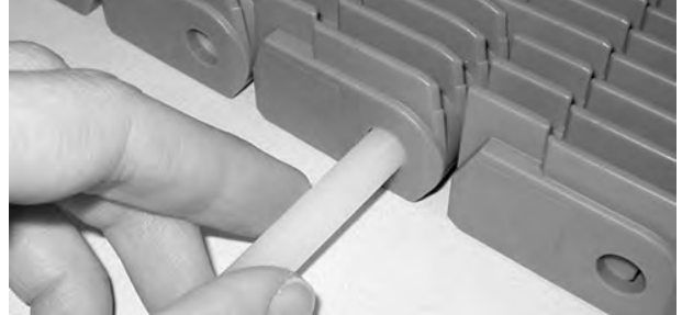
Şekil 219: Çubuğu banttın çekin
