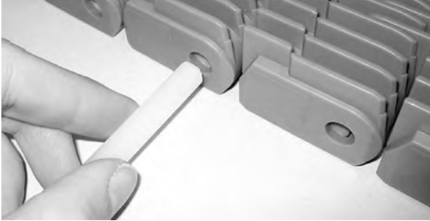
Şekil 216: Çubuğu menteşelerin içinden geçirin
