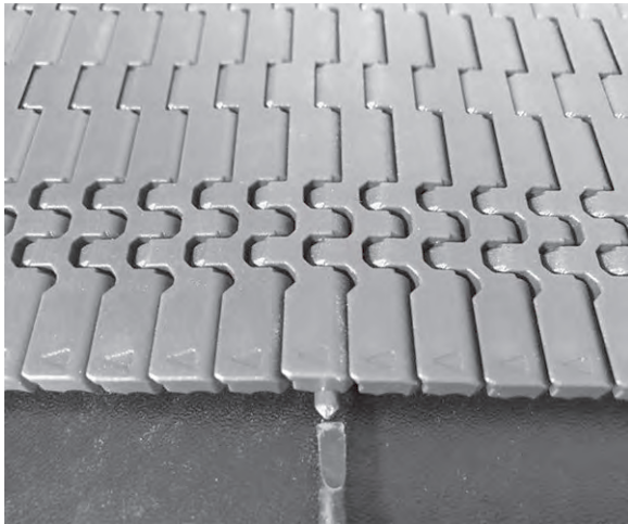
Şekil 60: Çubuğu, tutma unsurunu geçecek şekilde itme
