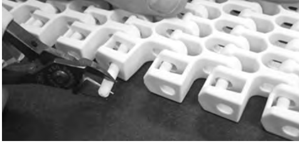
Şekil 296: Çubuğu banttan çekin
