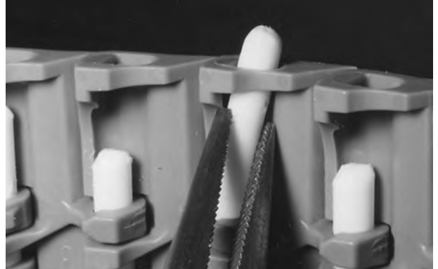
Şekil 149: Çubuğu, tutma unsurunu geçecek şekilde itme
