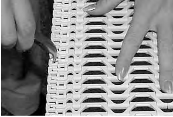
Şekil 172: Çubuğu banttan çekin
