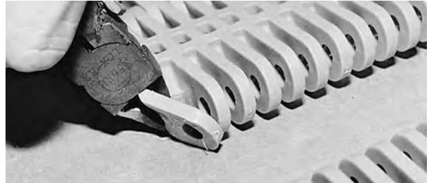
Şekil 52: En dıştaki bağlantıyı kesin
