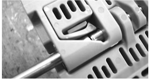
Şekil 100: Çubuğu, tutma unsurunu geçecek şekilde itme
