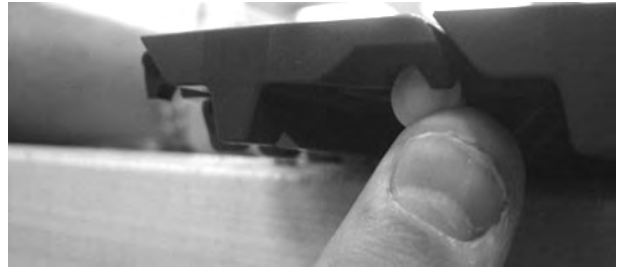
Şekil 70: Çubuğu, tutma unsurunu geçecek şekilde itme
