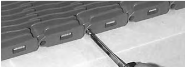
Şekil 50: Çubuğu banttan itin
