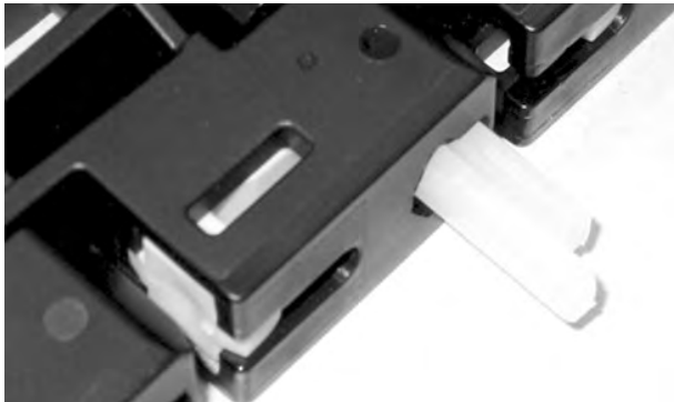
Şekil 186: Çubuğu menteşelerin içinden geçirin
