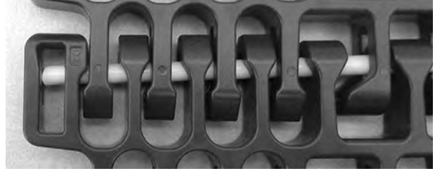
Şekil 320: Çubuğun tutma unsurunu geçtiğinden emin olun
