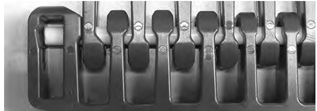
Şekil 337: Çubuğun tutma unsurunu geçtiğinden emin olun
