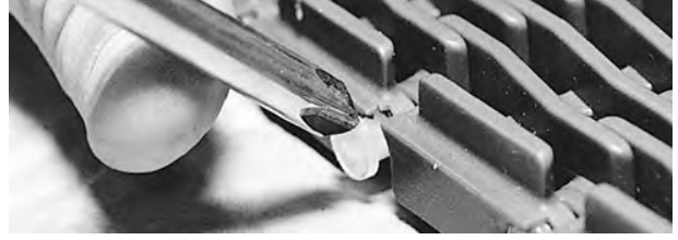
Şekil 107: Çubuğu bandın içine itin
