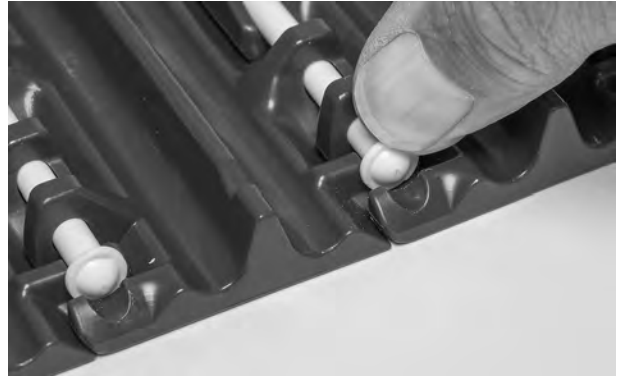
Şekil 94: Çubuğu, tutma unsurunu geçecek şekilde itin
