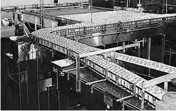
Şekil 23: Destekleri bant genişliği boyunca yerleştirin
