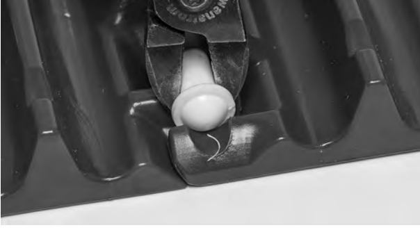
Şekil 96: Çubuk başını kesin
