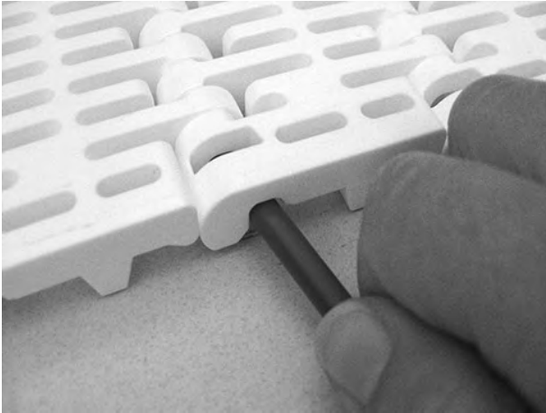
Şekil 80: Çubuğu bandın içine itin
