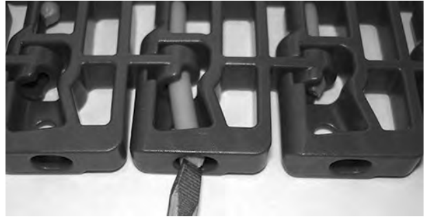
Şekil 120: Çubuğu, tutma unsurunu geçecek şekilde itme
