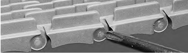
Şekil 29: Çubuk başının snap-lock'ı geçtiğinden emin olun
