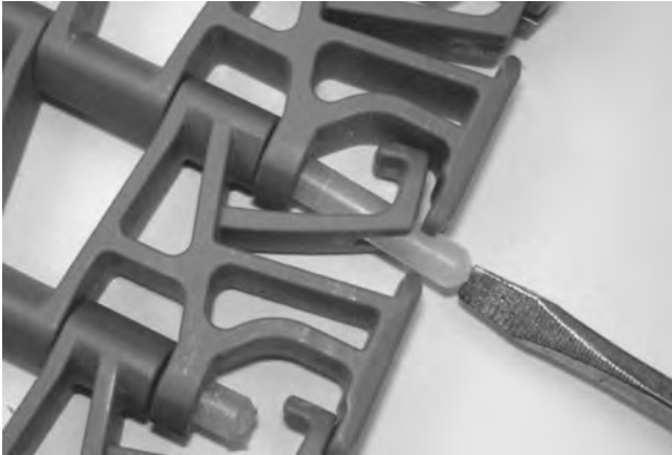
Şekil 252: Çubuğu, tutma unsurunu geçecek şekilde itme
