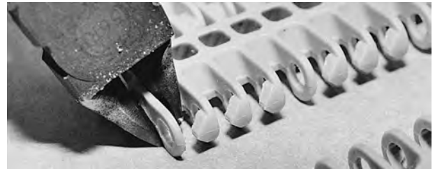
Şekil 32: En dıştaki bağlantıyı kesin
