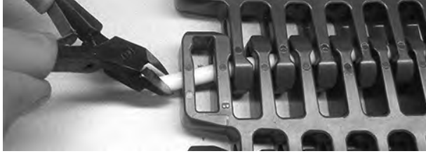
Şekil 339: Çubuğu banttan çekin
