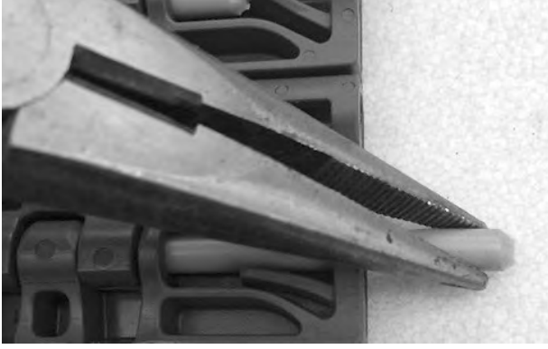
Şekil 132: Çubuğu banttan çekin
