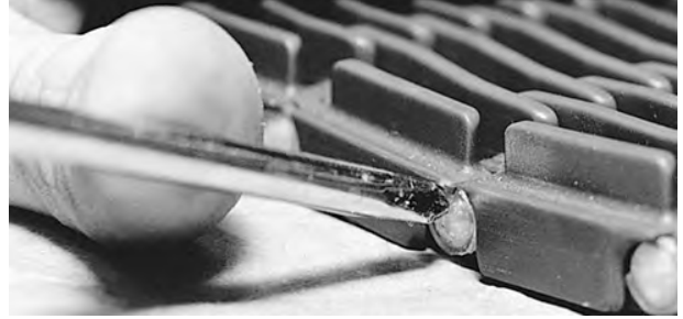
Şekil 108: Çubuğun snap-lock'ı geçtiğinden emin olun
