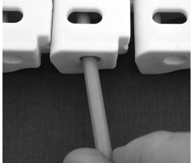
Şekil 291: Çubuğu banttan çekin
