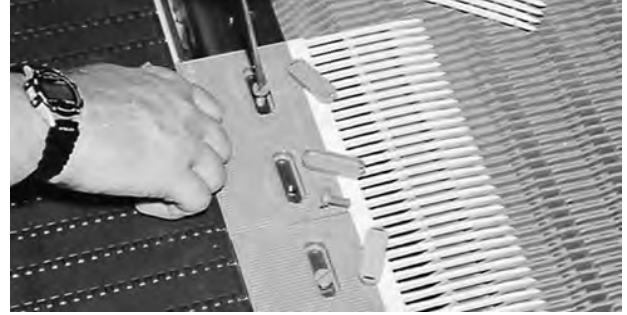
Şekil 24: Intralox plastik cıvataları kullanarak taraklı aktarma tavalarını takın
