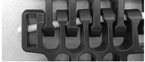
Şekil 319: Çubuğu, tutma unsurunu geçecek şekilde itme
