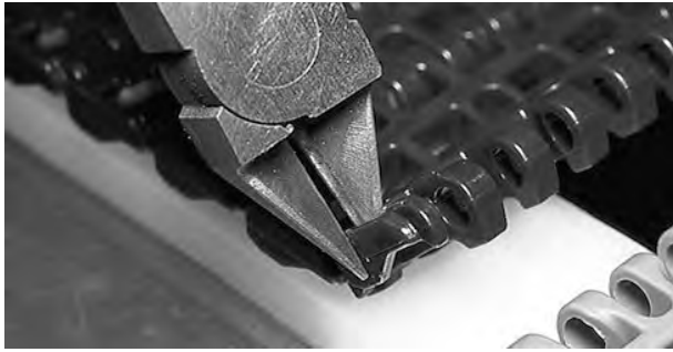
Şekil 151: Kenar elemanını kesin
