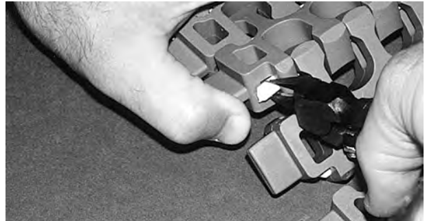
Şekil 278: Çubuğu tutma unsurunun üzerinde serbest bırakın
