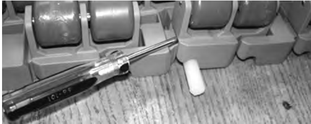
Şekil 196: Çubuğu banttan çekin
