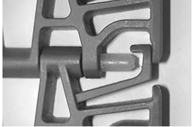
Şekil 253: Çubuğun tutma unsurunu geçtiğinden emin olun
