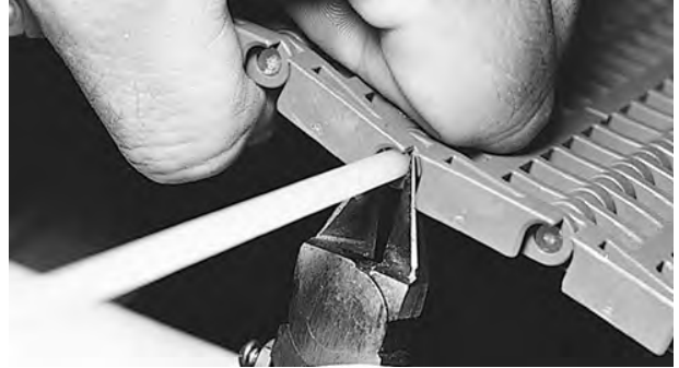
Şekil 109: Çubuğu bant kenarı ile düz şekilde kesin
