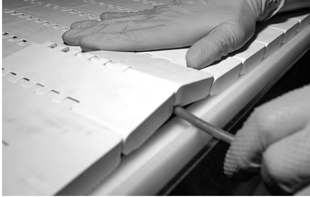
Şekil 89: Çubuğu hafifçe bükün ve menteşelerden geçirin
