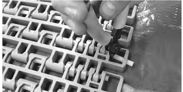
Şekil 345: Çubuğu banttın çekin
