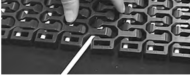
Şekil 309: Çubuğu menteşelerin içinden geçirin
