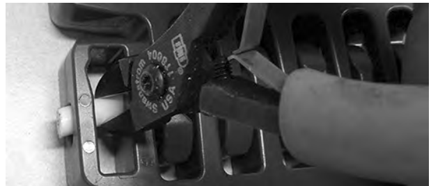
Şekil 338: Çubuğu yana itin ve kapalı deliği geçin
