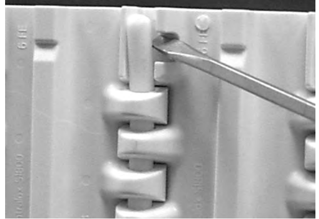
Şekil 207: Çubuğu tutma unsurunun üzerine kaldırın
