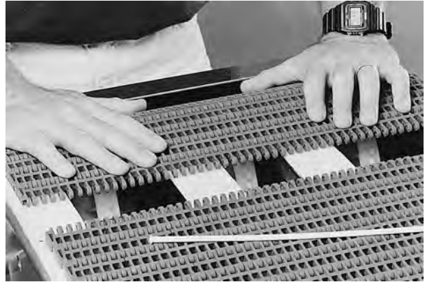
Şekil 19: Bant uçlarını birbirine itin
