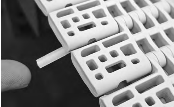
Şekil 125: Çubuğu, tam düz kenarın içine oturana kadar itin
