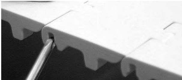
Şekil 205: Çubuğu tutma figürünü geçecek şekilde itin
