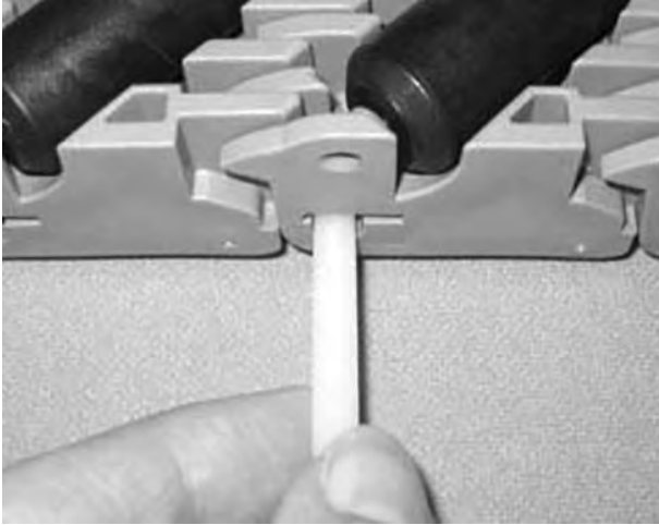
Şekil 231: Çubuğu menteşelerin içinden geçirin
