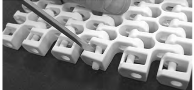
Şekil 295: Çubuğu, tutma unsurunun içerisine itin
