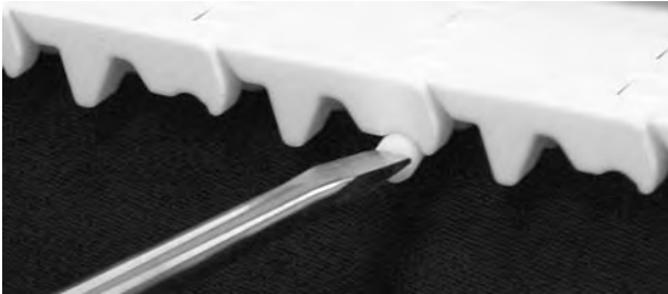
Şekil 175: Çubuğu, tutma unsurunu geçecek şekilde itme
