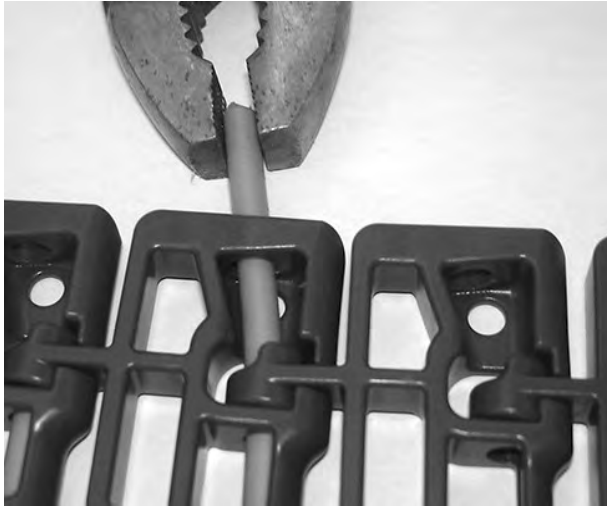
Şekil 123: Çubuğu banttan çekin
