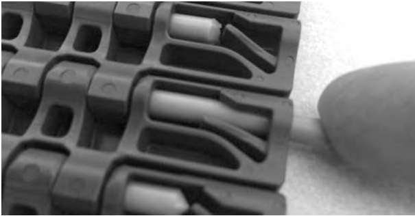
Şekil 128: Çubuğu menteşenin içinden geçirin
