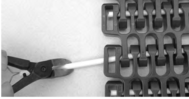
Şekil 322: Çubuğu banttan çekin
