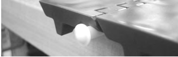
Şekil 68: Çubuğu menteşelerin içinden geçirin
