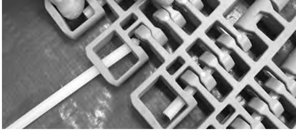
Şekil 342: Çubuğu menteşelerin içinden geçirin
