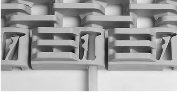
Şekil 85: Çubuğu bandın içine itin
