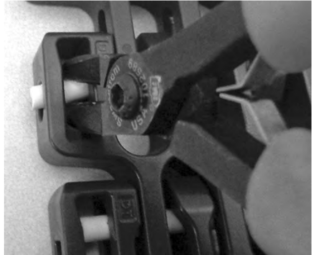
Şekil 321: Çubuğu yana itin ve deliği geçin
