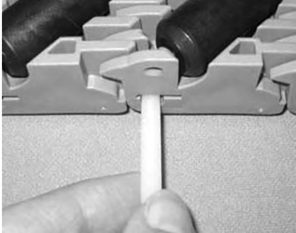
Şekil 225: Çubuğu menteşelerin içinden geçirin
