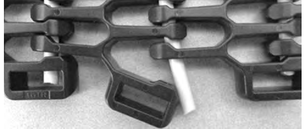
Şekil 330: Çubuğu bant kenarından itin
