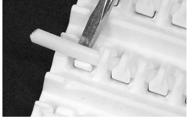
Şekil 177: Çubuğu tutma unsurunun üzerine kaldırın
