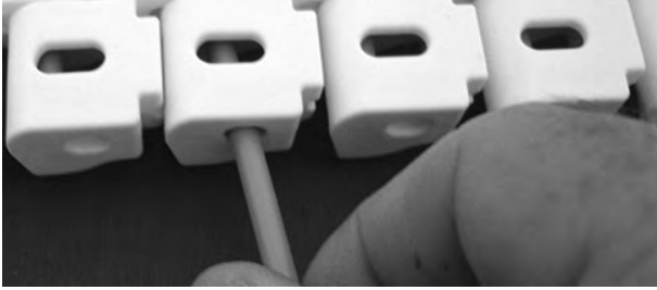
Şekil 287: Çubuğu menteşelerin içinden geçirin
