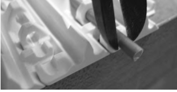
Şekil 184: Çubuğu banttın çekin
