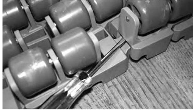
Şekil 193: Tornavidayı makaranın altına yerleştirin
