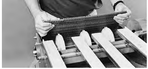
Şekil 17: Bandı geridönüşten besleyin
