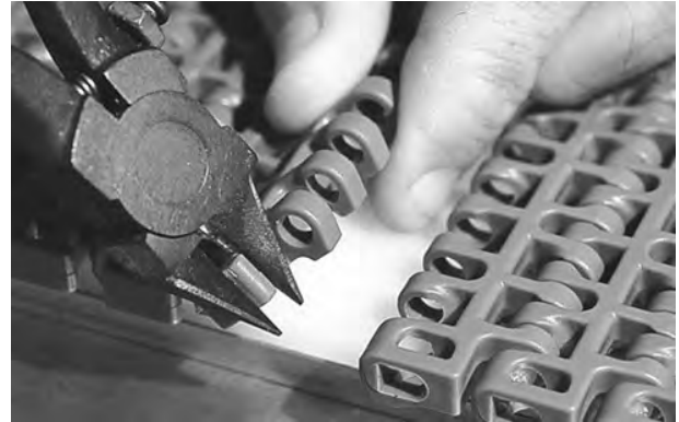
Şekil 153: Kenarı banttan kesin
