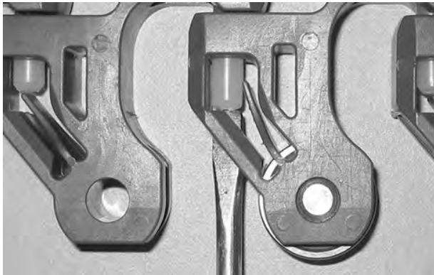
Şekil 283: Çubuğu, tutma unsurunu geçecek şekilde itme
