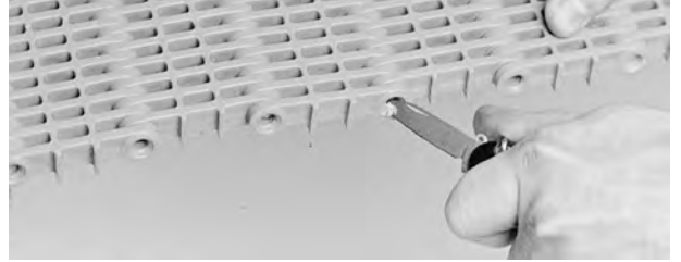
Şekil 37: Açık çubuk deliği
