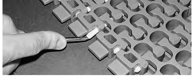
Şekil 276: Çubuğun tutma unsurunu geçtiğinden emin olun
