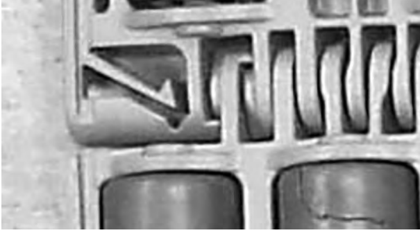
Şekil 224: Çubuğun tutma unsurunu geçtiğinden emin olun
