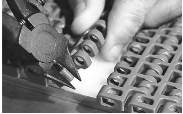
Şekil 143: Kenarı banttaki ucu kesin
