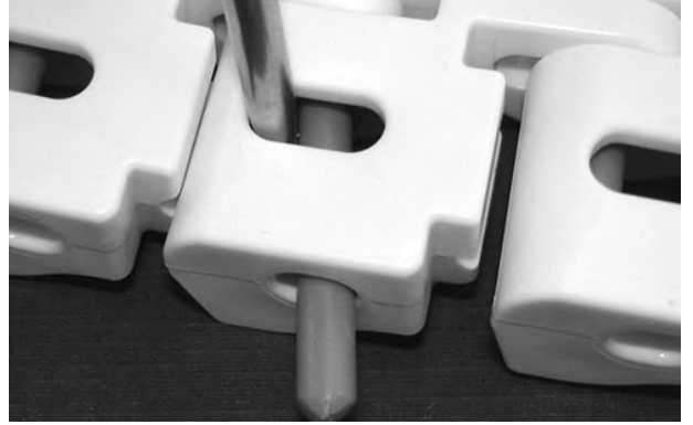
Şekil 290: Çubuğu, tutma unsurunun içerisine itin
