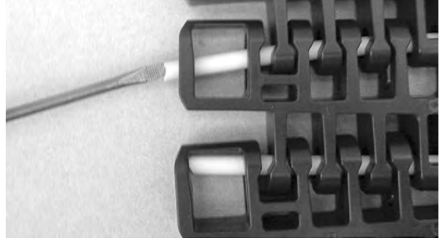
Şekil 360: Çubuğu, tutma unsurunu geçecek şekilde itme
