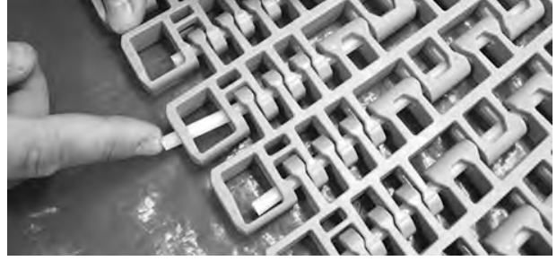
Şekil 343: Çubuğu, tutma unsurunu geçecek şekilde itme
