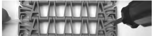
Şekil 255: Çubuğu banttan itin
