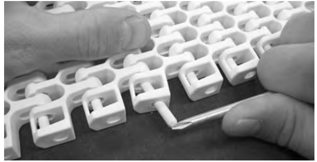
Şekil 293: Çubuğu, tutma unsurunu geçecek şekilde itme
