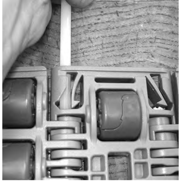
Şekil 222: Çubuğu banttan itin
