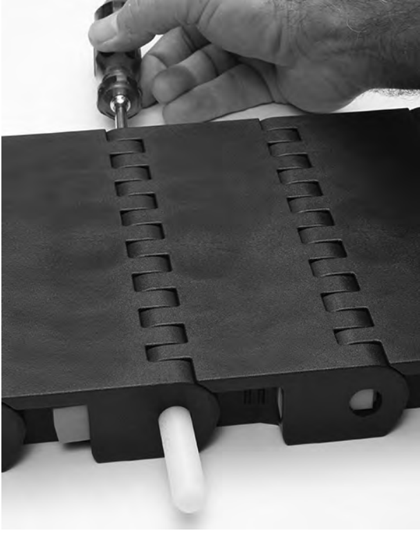
Şekil 264: Çubuğu banttan itin
