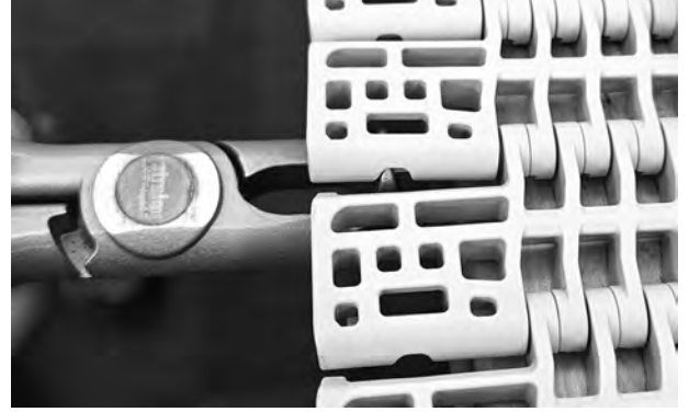
Şekil 126: Çubuğu tutmak için çubuk çıkarıcı kullanın
