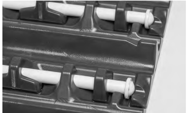
Şekil 95: Çubuğun tutma unsurunu geçtiğinden emin olun
