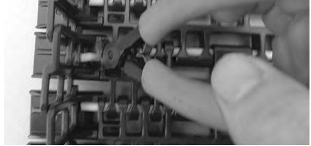
Şekil 372: Çubuğu, tutma unsurunu geçecek şekilde itme
