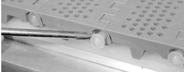
Şekil 64: Çubuğu bandın içine itin
