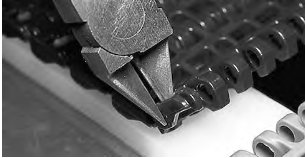
Şekil 141: Kenarın yarısını kesin
