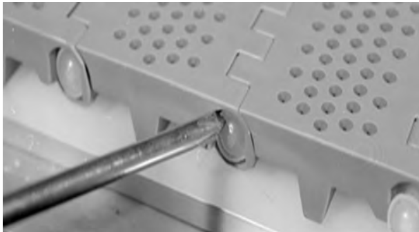
Şekil 65: Çubuk başının snap-lock'ı geçtiğinden emin olun
