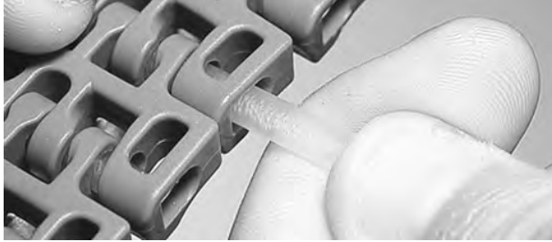
Şekil 145: Çubuğu menteşelerin içinden geçirin
