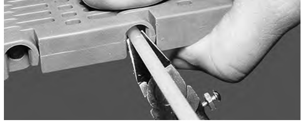
Şekil 45: Çubuğu bant kenarı ile düz şekilde kesin
