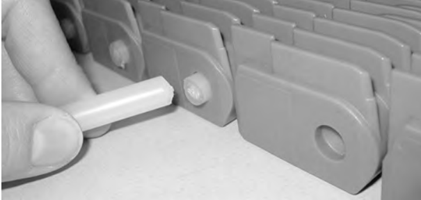
Şekil 217: Çubuğu Shuttleplug'ı geçecek şekilde itin
