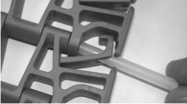
Şekil 251: Çubuğu menteşelerin içinden geçirin
