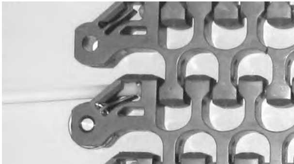
Şekil 304: Çubuğu banttan çekin
