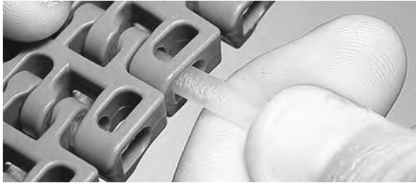
Şekil 136: Çubuğu menteşelerin içinden geçirin
