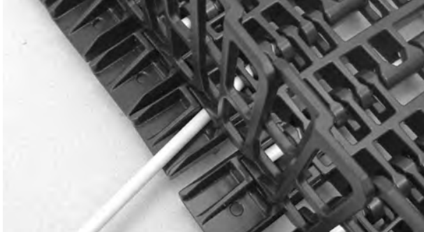
Şekil 369: Çubuğu menteşelerin içinden geçirin
