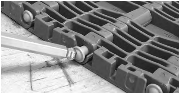
Şekil 272: Çubukcuğu tutma unsurunu geçecek şekilde itin
