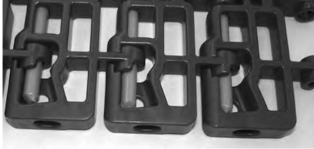
Şekil 113: Çubuk, düz kenara doğru uzar
