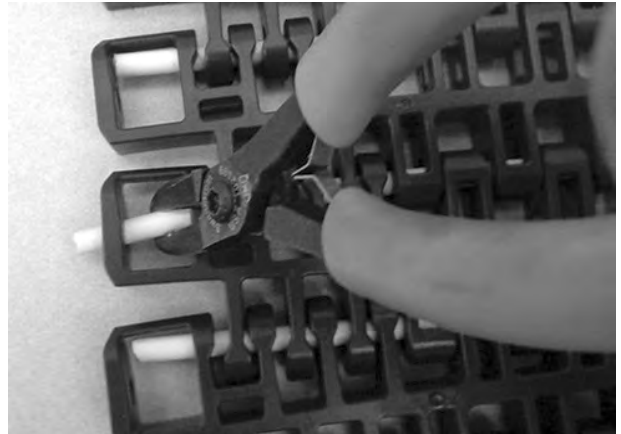
Şekil 362: Çubuğu, tutma unsurunu geçecek şekilde itme
