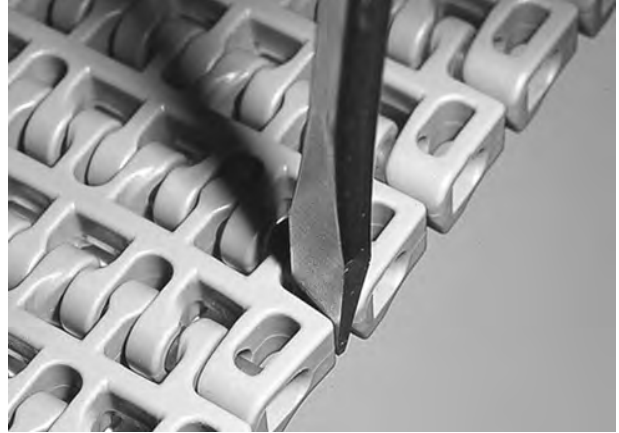
Şekil 139: Çubuğu, tutma unsurunu geçecek şekilde itme
