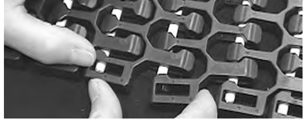
Şekil 312: Çubuğu bant kenarından itin, düz kenarı çubuk üzerine oturtun
