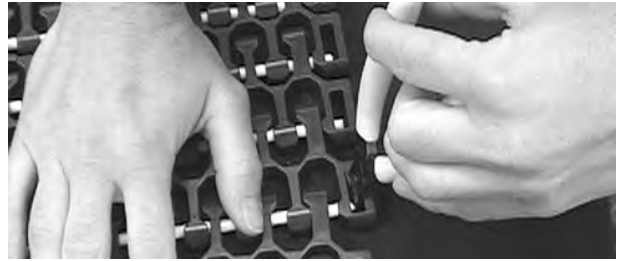
Şekil 314: Çubuğu bandın içine itin
