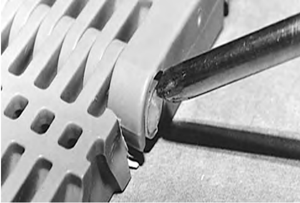
Şekil 54: Çubuğu, tutma unsurunu geçecek şekilde itin
