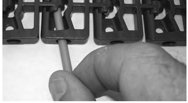
Şekil 119: Çubuğu menteşelerin içinden geçirin
