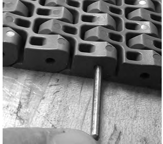
Şekil 274: Çubuğu ve çubukcuğu banttı çıkarmak için
