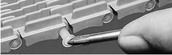
Şekil 28: Çubuğu bandın içine itin
