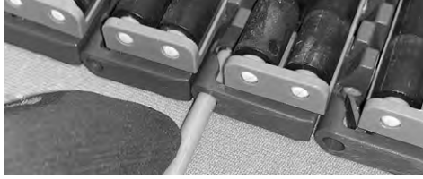
Şekil 247: Çubuğu menteşelerin içinden geçirin
