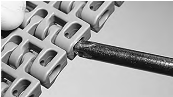
Şekil 137: Çubuğu, tutma unsurunu geçecek şekilde itme
