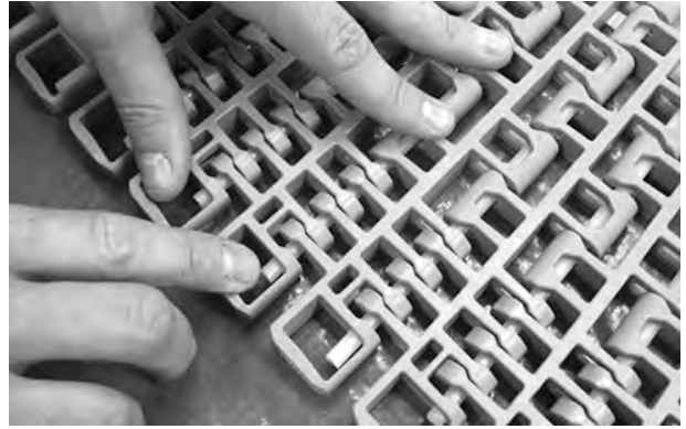
Şekil 344: Çubuğun tutma unsurunu geçtiğinden emin olun
