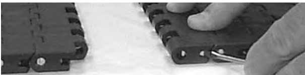
Şekil 161: Slidelox'u kapatmak için tornavida kullanın
