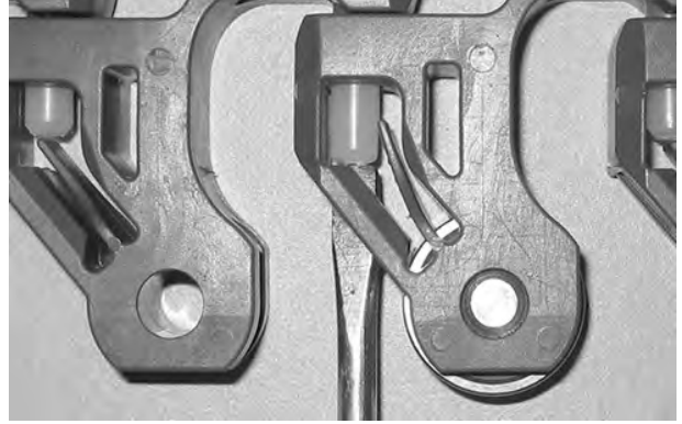
Şekil 305: Çubuğu, tutma unsurunu geçecek şekilde itme
