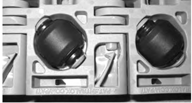
Şekil 227: Çubuğun tutma unsurunu geçtiğinden emin olun
