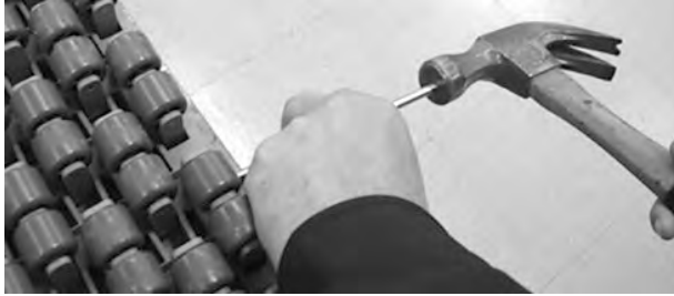
Şekil 195: Çubuğu banttan itin
