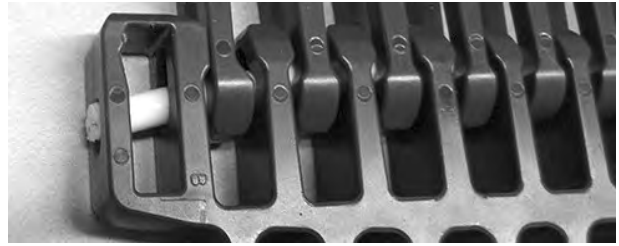
Şekil 336: Çubuğu menteşelerin içinden geçirin
