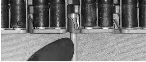
Şekil 248: Çubuğu, tutma unsurunu geçecek şekilde itin
