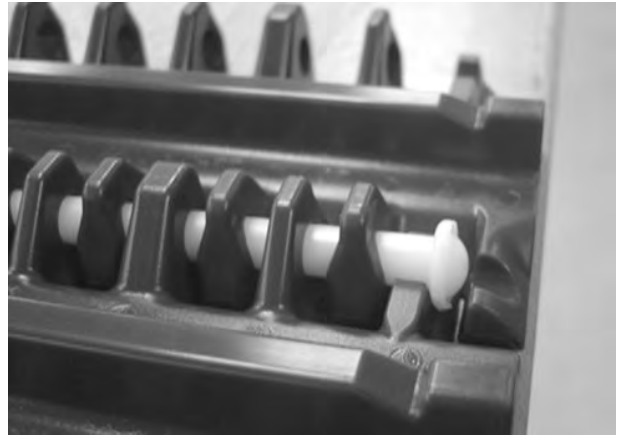
Şekil 71: Çubuğun tutma unsurunu geçtiğinden emin olun
