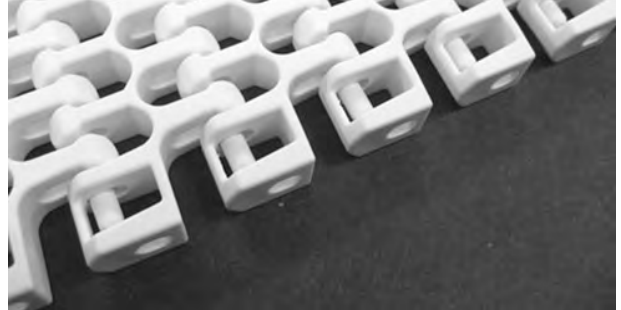
Şekil 294: Çubuğun tutma unsurunu geçtiğinden emin olun
