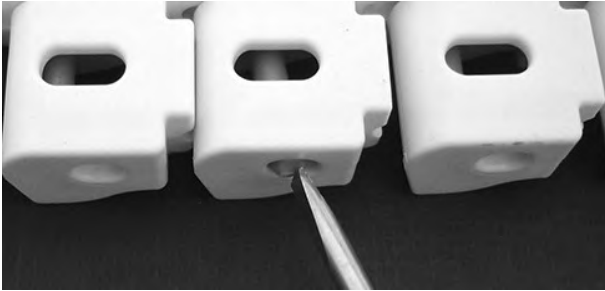
Şekil 288: Çubuğu, tutma unsurunu geçecek şekilde itme
