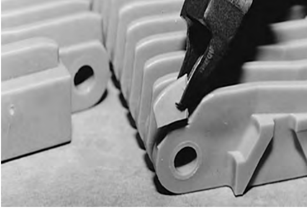
Şekil 53: En dıştaki nervürü kesin
