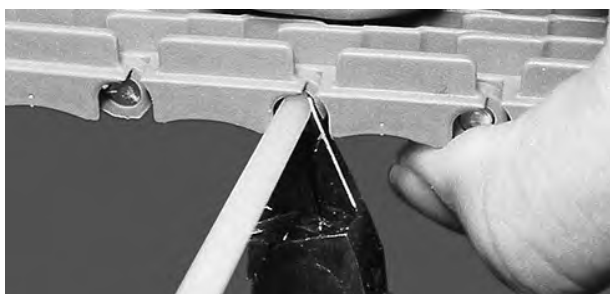
Figure 30: Coupez l'extrémité de l'axe en alignement avec le bord du tapis
