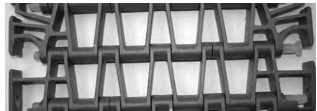
Figure 260: Vérifiez que l'axe est inséré au-delà du système de rétention
