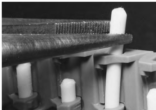
Figure 150: Retrait de l'axe du tapis
