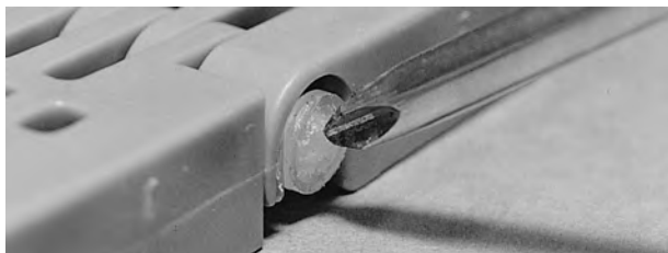
Figure 44: Vérifiez que la tête de l'axe va au-delà du clip d'arrêt
