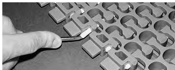
Figure 276: Vérifiez que l'axe est inséré au-delà du système de rétention
