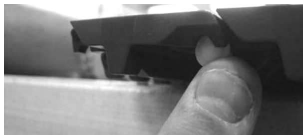
Figure 70: insérez l'axe dans le système de rétention
