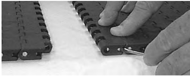
Figure 163: Fermez le Slidelox
