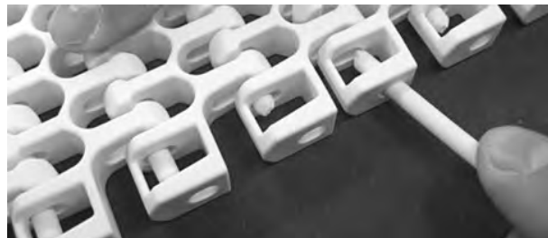
Figure 292: Insérez l'axe à travers les charnières
