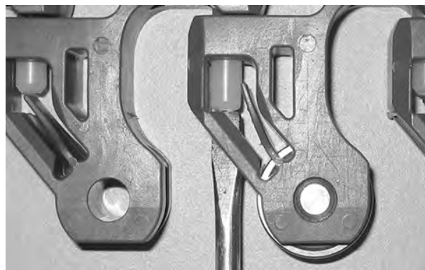
Figure 283: insérez l'axe dans le système de rétention
