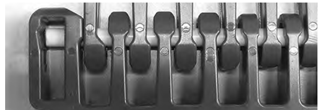
Figure 337: Vérifiez que l'axe est inséré au-delà du système de rétention
