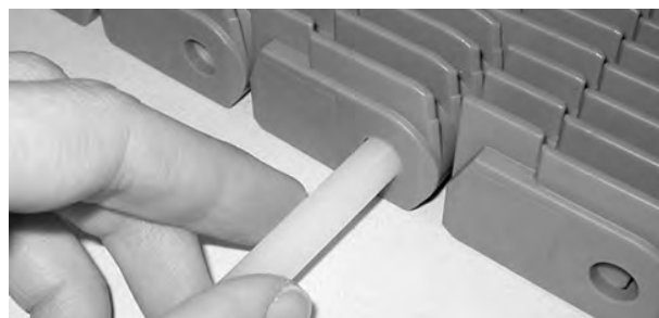
Figure 219: Retrait de l'axe du tapis
