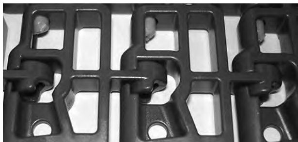
Figure 112: Les axes se déplacent à l'intérieur du bord lisse
