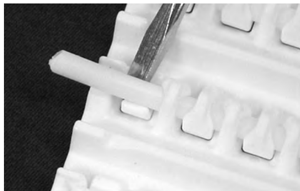
Figure 177: Soulevez l'axe au-dessus du système de rétention
