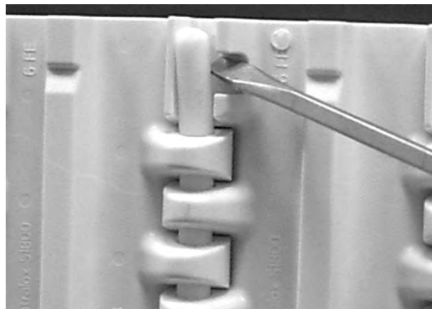
Figure 207: Soulevez l'axe au-dessus du système de rétention
