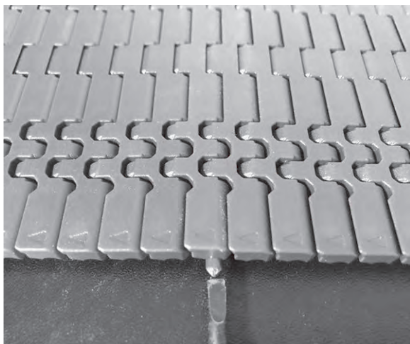
Figure 60: insérez l'axe dans le système de rétention
