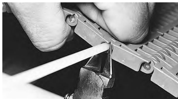
Figure 109: Coupez l'extrémité de l'axe en alignement avec le bord du tapis
