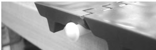
Figure 68: Insérez l'axe à travers les charnières
