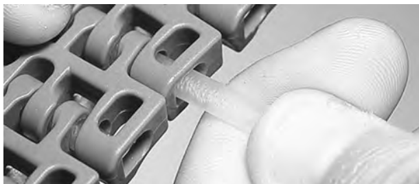
Figure 136: Insertion de l'axe à travers les charnières
