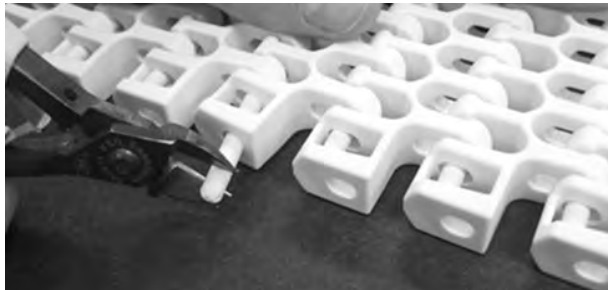
Figure 296: Retrait de l'axe du tapis
