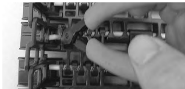
Figure 372: insérez l'axe dans le système de rétention
