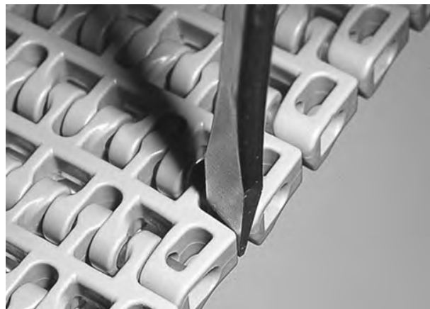
Figure 139: insérez l'axe dans le système de rétention
