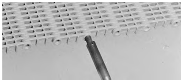
Figure 36: Fermez le trou d'axe
