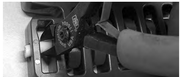
Figure 338: Enfoncez l'axe de biais et au-delà du trou bloqué
