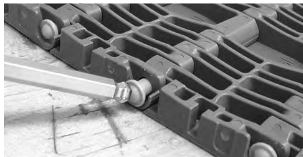
Figure 272: Enfoncez le petit axe au-delà du système de rétention
