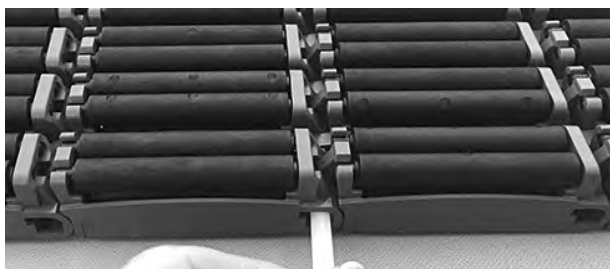
Figure 241: Insérez l'axe à travers les charnières
