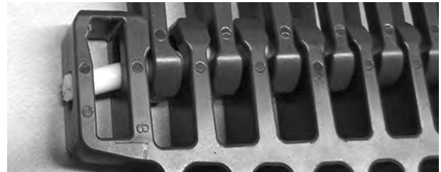
Figure 336: Insérez l'axe à travers les charnières
