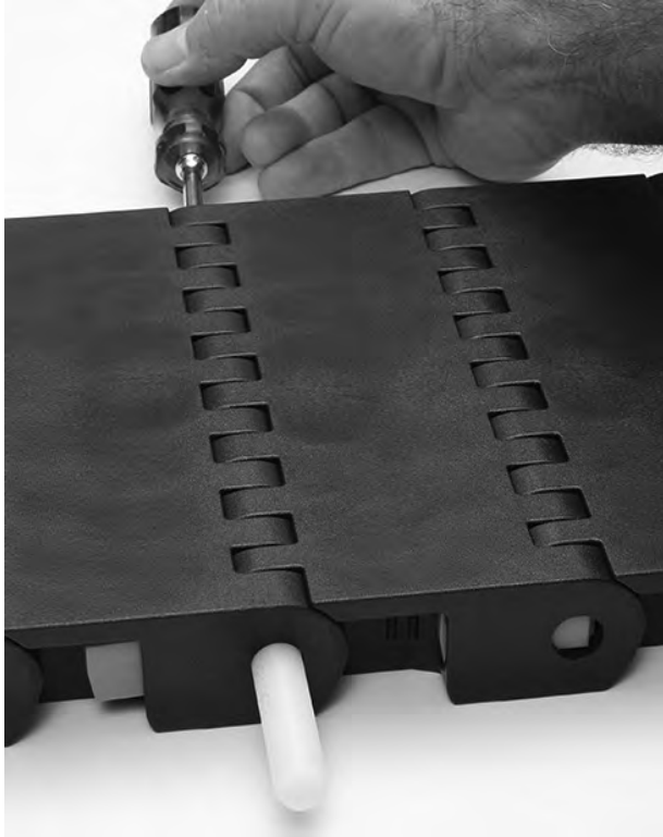
Figure 264: Poussez l'axe hors du tapis
