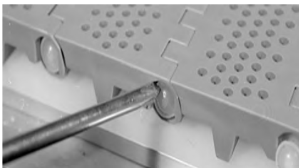
Figure 65: Vérifiez que la tête de l'axe va au-delà du clip d'arrêt
