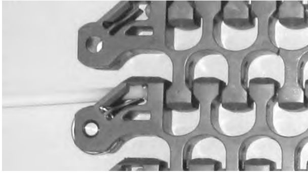
Figure 286: Poussez l'axe hors du tapis
