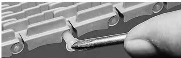
Figure 28: Enfoncez l'axe dans le tapis
