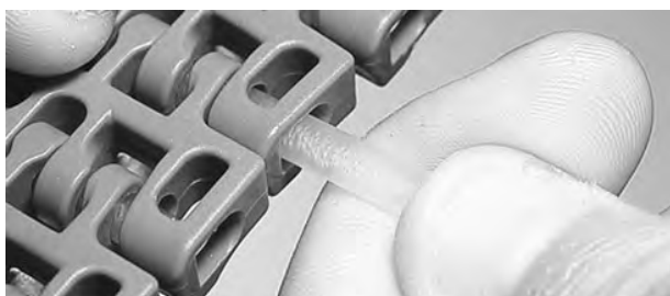
Figure 145: Insérez l'axe à travers les charnières
