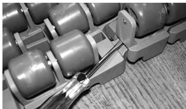
Figure 193: Introduisez le tournevis sous le rouleau
