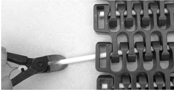
Figure 322: Retrait de l'axe du tapis
