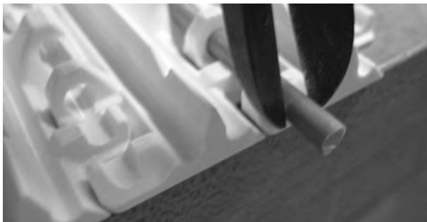
Figure 184: Retrait de l'axe du tapis
