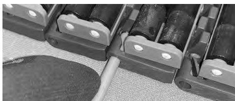
Figure 247: Insérez l'axe à travers les charnières
