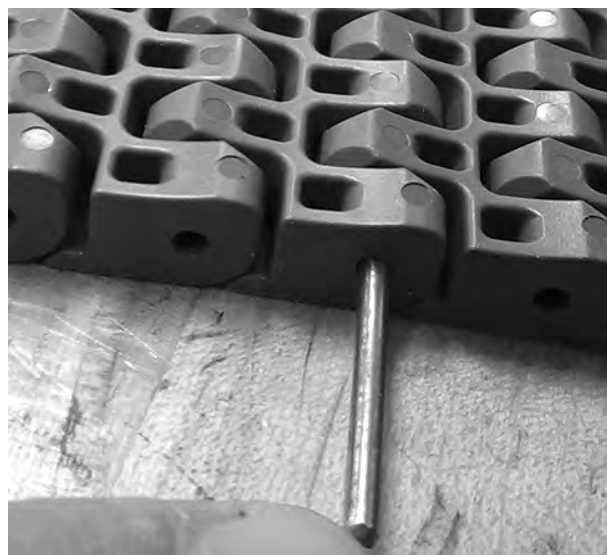
Figure 274: Poussez l'axe et le petit axe hors du tapis
