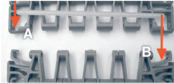
A Section de tapis d'origine B Nouvelle section de tapis
