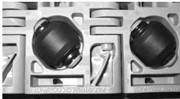
Figure 227: Vérifiez que l'axe est inséré au-delà du système de rétention
