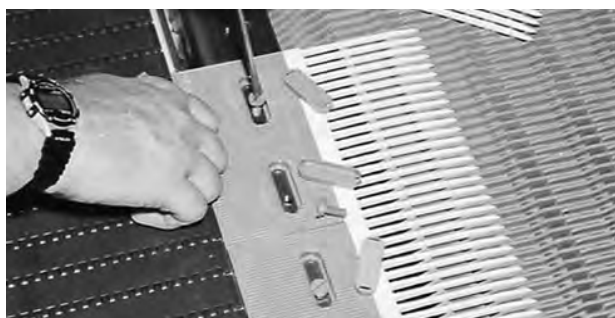
Figure 24: Installez les peignes de transfert à l'aide de boulons en plastique Intralox
