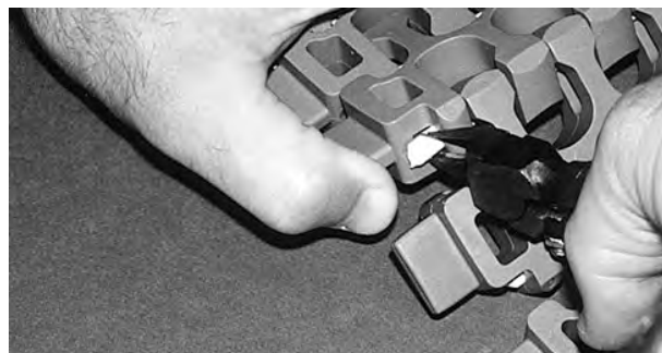
Figure 278: Axe libre de la fonction de rétention
