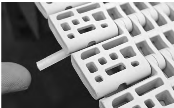
Figure 125: Poussez l'axe jusqu'à ce qu'il s'enclenche dans le bord lisse
