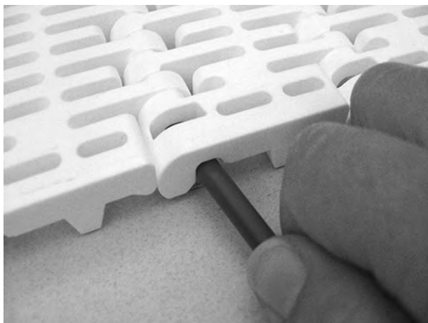
Figure 80: Enfoncez l'axe dans le tapis
