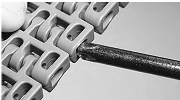
Figure 137: insérez l'axe dans le système de rétention
