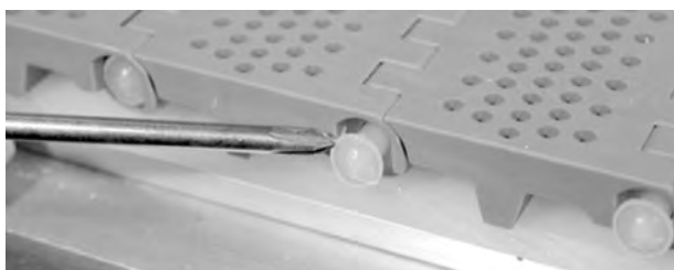
Figure 64: Enfoncez l'axe dans le tapis
