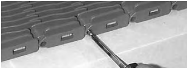
Figure 50: Pousser l'axe hors du tapis
