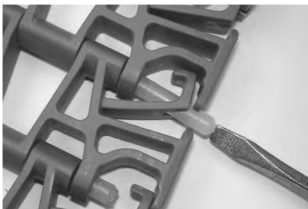
Figure 252: insérez l'axe dans le système de rétention
