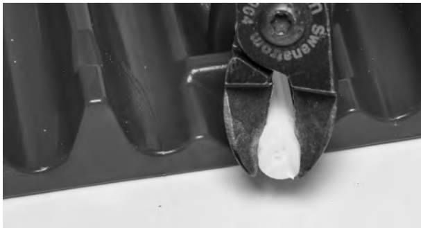
Figure 97: Retrait de l'axe du tapis
