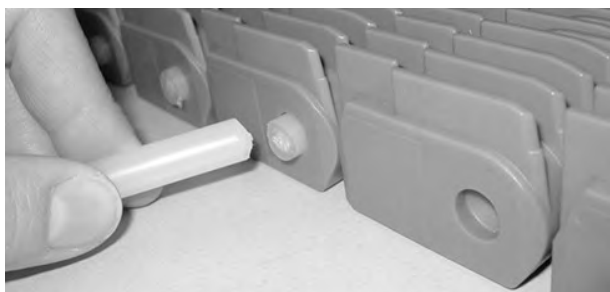
Figure 217: Poussez l'axe au-delà du Shuttleplug
