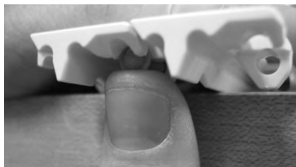
Figure 181: insérez l'axe dans le système de rétention
