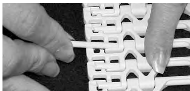
Figure 170: Insertion de l'axe à travers les charnières
