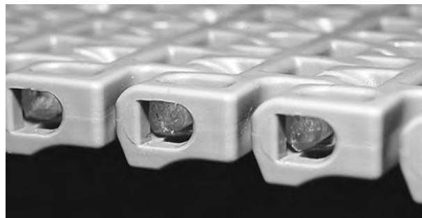
Figure 138: Vérifiez que l'axe est inséré au-delà du système de rétention
