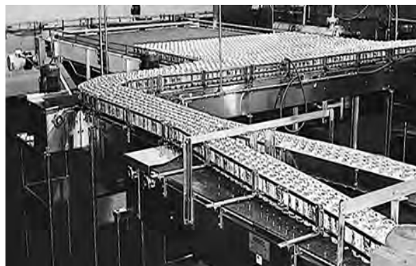
Figure 23: Placez des supports sur toute la largeur du tapis
