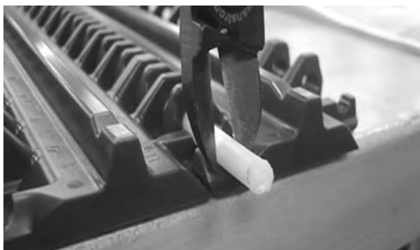
Figure 73: Retrait de l'axe du tapis
