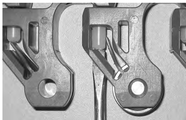
Figure 305: insérez l'axe dans le système de rétention
