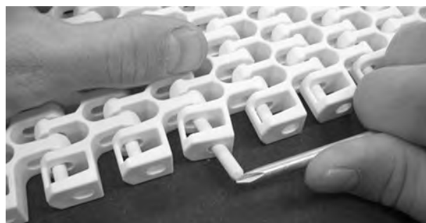
Figure 293: insérez l'axe dans le système de rétention
