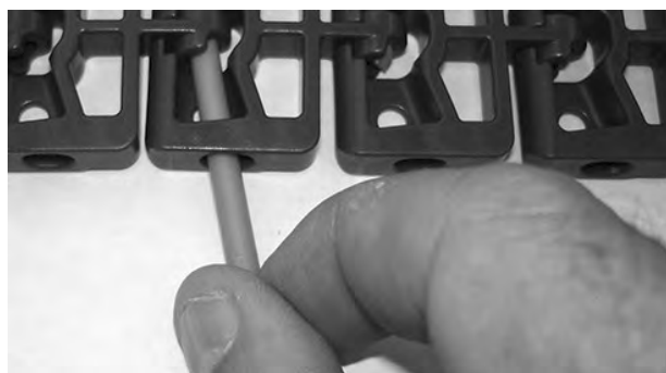
Figure 119: Insérez l'axe à travers les charnières
