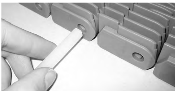
Figure 216: Insérez l'axe à travers les charnières
