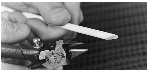
Figure 20: Coupez l'axe à l'angle adéquat
