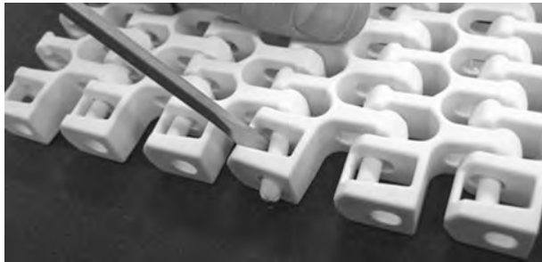
Figure 295: Poussez l'axe dans le système de rétention
