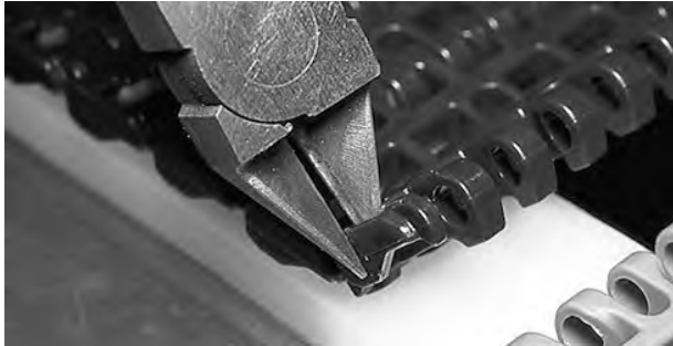
Figure 141: Coupez la moitié de l'élément latéral
