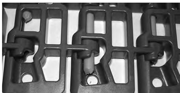
Figure 121: Assurez-vous que l'axe est complètement inséré
