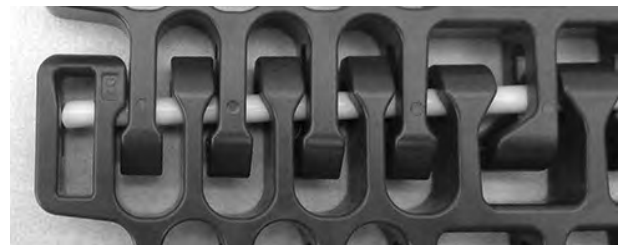
Figure 320: Vérifiez que l'axe est inséré au-delà du système de rétention
