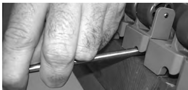
Figure 194: Insérez l'axe en acier dans la charnière
