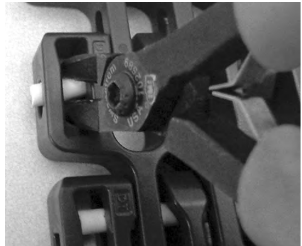
Figure 321: Enfoncez l'axe de biais et au-delà du trou
