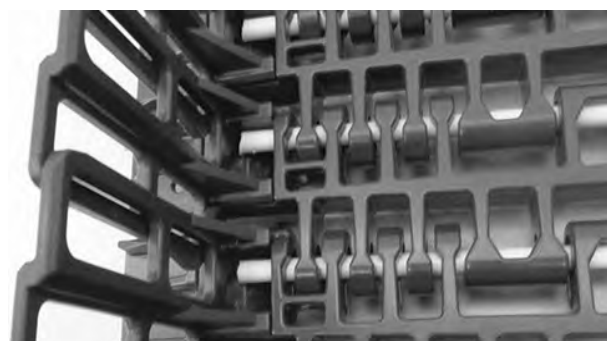
Figure 357: Vérifiez que l'axe est inséré au-delà du système de rétention
