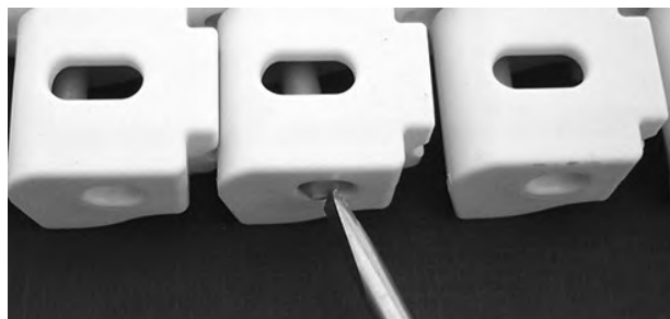
Figure 288: insérez l'axe dans le système de rétention
