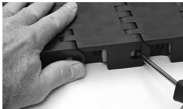
Figure 267: Ouvrez le Slidelox
