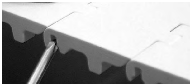
Figure 205: Insérez l'axe au-delà du système de rétention
