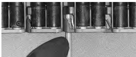
Figure 248: Insérez l'axe dans le système de rétention
