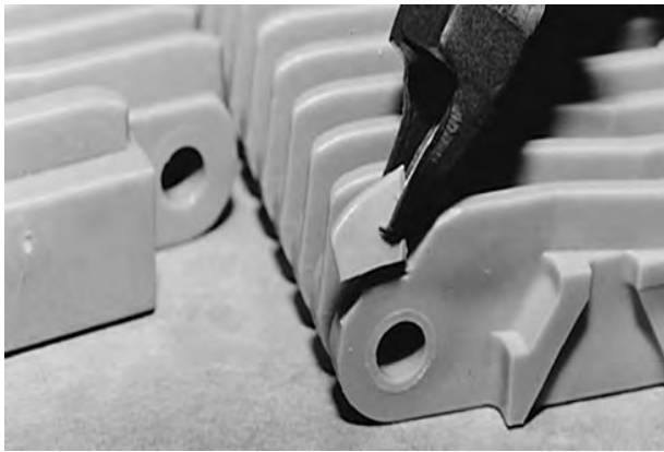
Figure 53: Coupez la nervure extérieure
