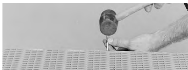
Figure 38: Poussez l'axe hors du tapis
