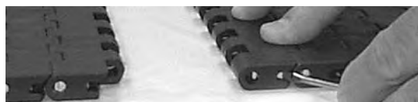
Figure 161: Utilisez un tournevis pour fermer le Slidelox
