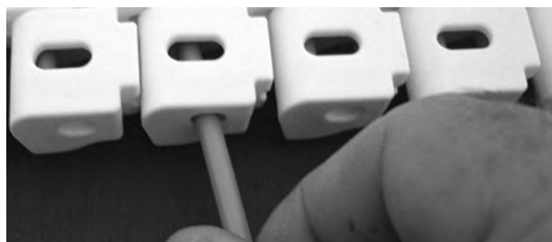
Figure 287: Insérez l'axe à travers les charnières
