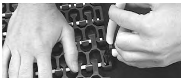
Figure 314: Enfoncez l'axe dans le tapis
