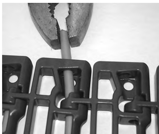
Figure 123: Retrait de l'axe du tapis
