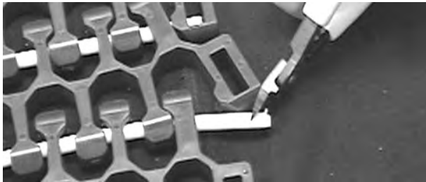
Figure 317: Retrait de l'axe du tapis
