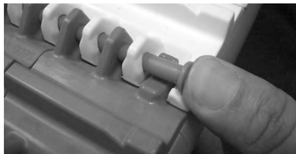
Figure 78: insérez l'axe dans le système de rétention
