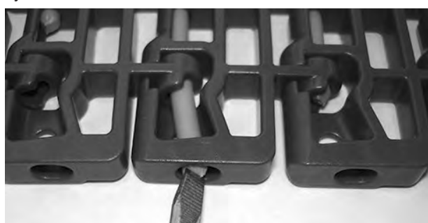
Figure 120: insérez l'axe dans le système de rétention
