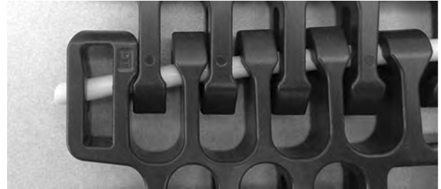
Figure 319: insérez l'axe dans le système de rétention
