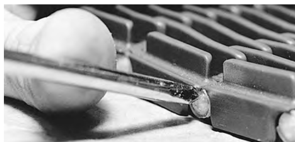
Figure 108: Vérifiez que l'axe va au-delà du clip d'arrêt
