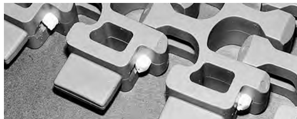
Figure 277: Assurez-vous que l'axe est complètement inséré
