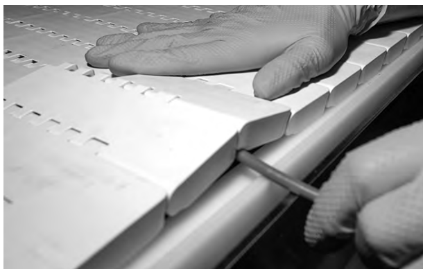
Figure 89: Pliez légèrement l'axe et insérez-le dans les charnières
