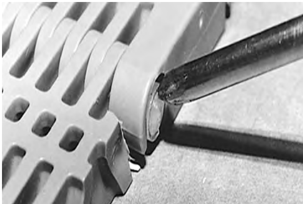
Figure 54: Poussez la tête de l'axe au-delà du système de rétention
