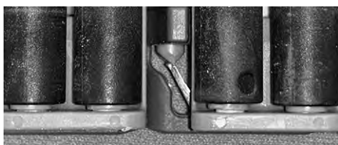
Figure 249: Vérifiez que l'axe est inséré au-delà du système de rétention
