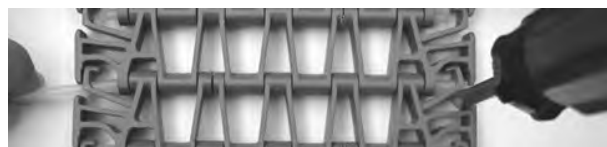
Figure 255: Poussez l'axe hors du tapis
