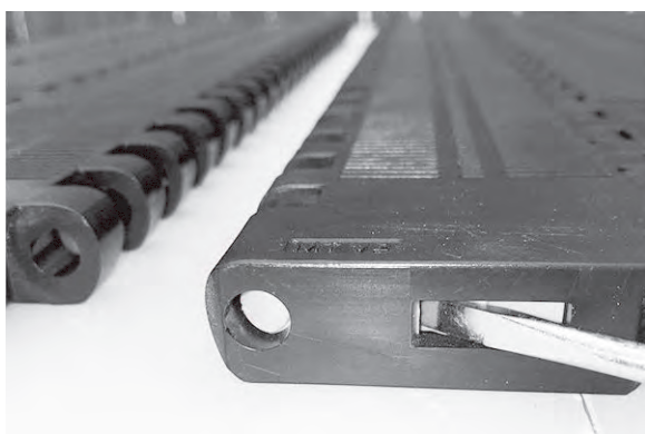
Figure 210: Utilisez un tournevis pour fermer le Slidelox
