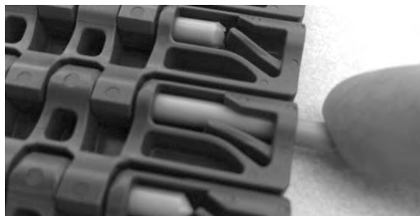
Figure 128: Insérez l'axe à travers les charnières
