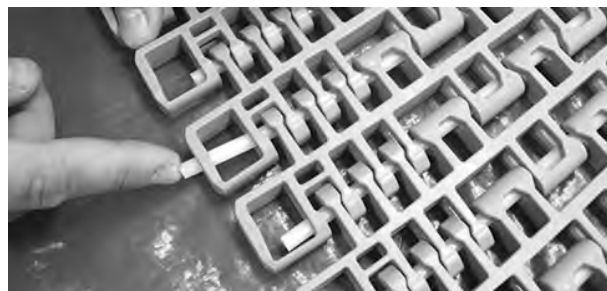
Figure 343: insérez l'axe dans le système de rétention
