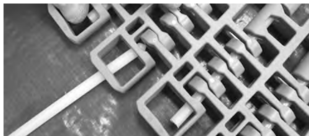
Figure 342: Insérez l'axe à travers les charnières
