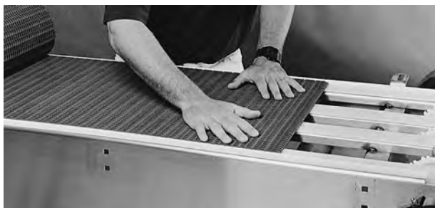
Figure 14: Installez le tapis en partant de l'extrémité d'entraînement
