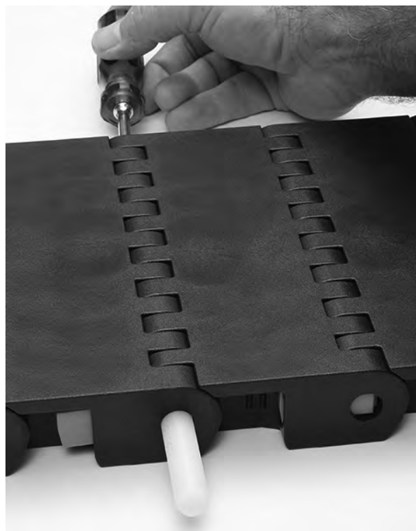
Figure 268: Poussez l'axe hors du tapis
