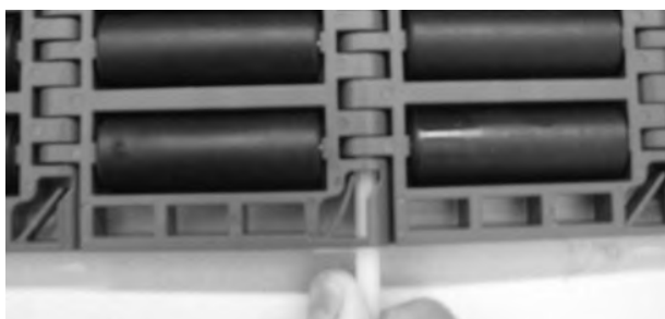
Figure 237: Insertion de l'axe à travers les charnières
