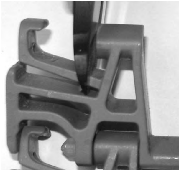
Figure 257: Coupez le système de rétention
