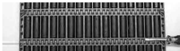
Figure 240: Poussez l'axe hors du tapis
