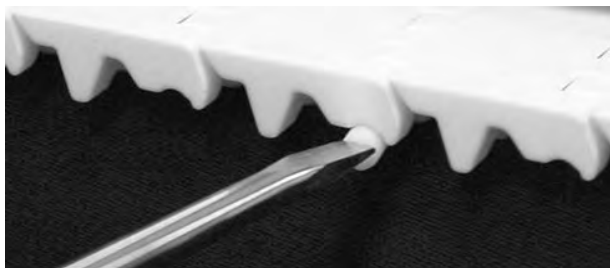
Figure 175: insérez l'axe dans le système de rétention
