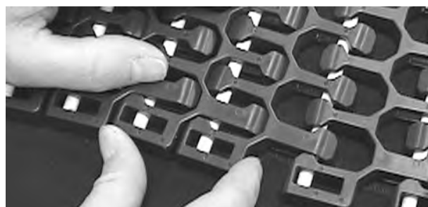
Figure 313: Assurez-vous que l'axe est complètement inséré
