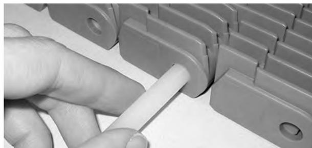
**Figura 219:** Estrazione del perno dal nastro
