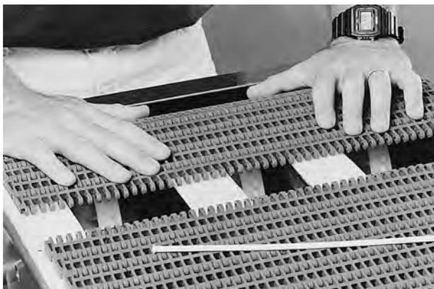
**Figura 19:** Avvicinare le estremità del nastro
