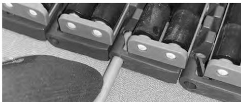
**Figura 247:** Inserire il perno nelle cerniere
