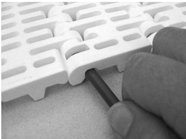
**Figura 80:** Spingere il perno nel nastro
