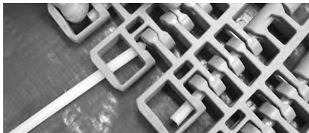
**Figura 342:** Inserire il perno nelle cerniere
