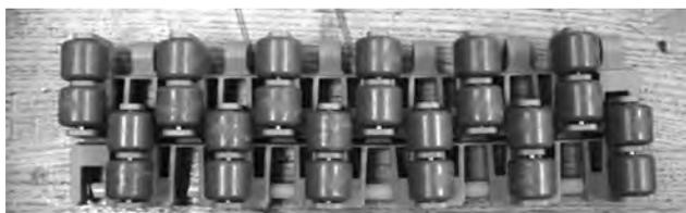
Figura 190: Montaggio in incrementi di due file
