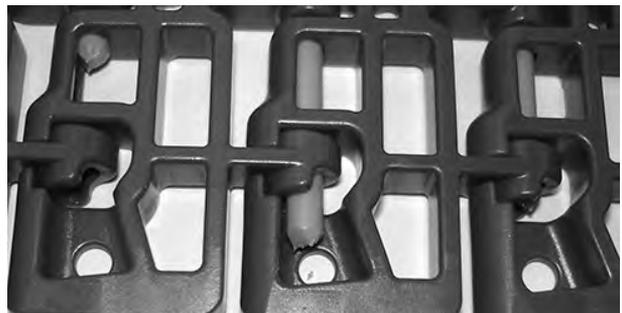
**Figura 121:** Assicurarsi che il perno sia inserito completamente
