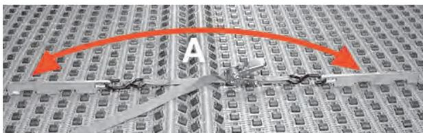
A Sistemi di tensionamento dei nastri
