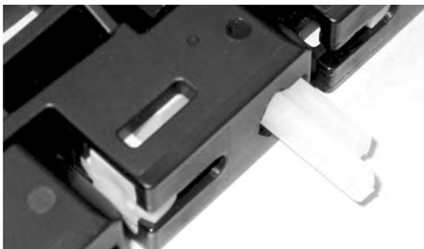
**Figura 186:** Inserire il perno nelle cerniere
