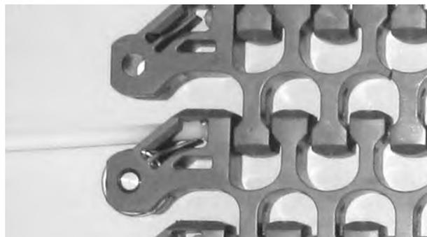
Figura 304: Estrazione del perno dal nastro
