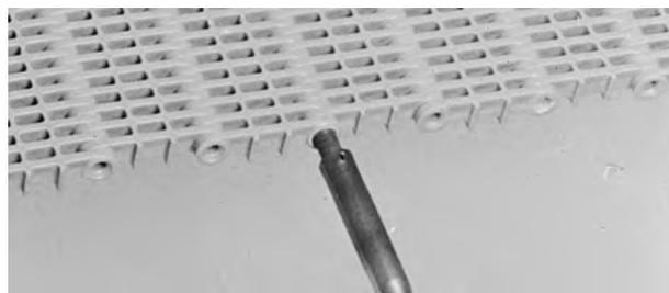
Figura 36: Chiudere il foro del perno
