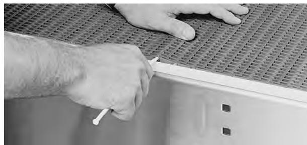
**Figura 21:** Inserimento del perno
