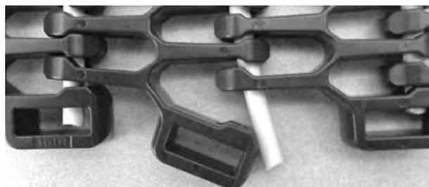
**Figura 330:** Spingere il perno oltre il bordo del nastro
