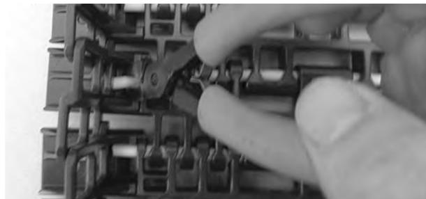
**Figura 358:** Estrazione del perno dal nastro
