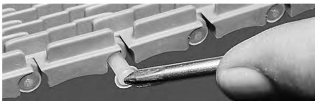
Figura 28: Spingere il perno nel nastro
