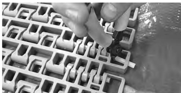
**Figura 345:** Estrazione del perno dal nastro
