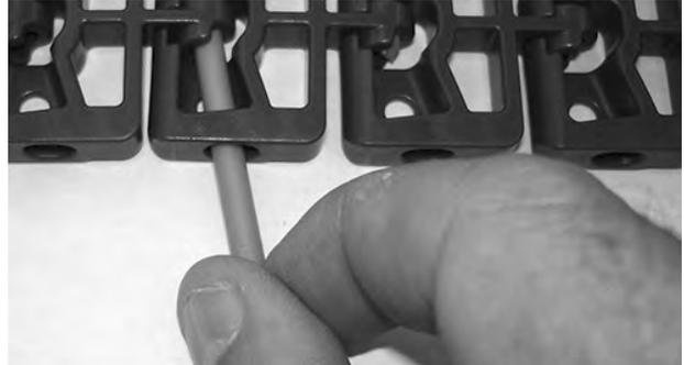
**Figura 119:** Inserire il perno nelle cerniere
