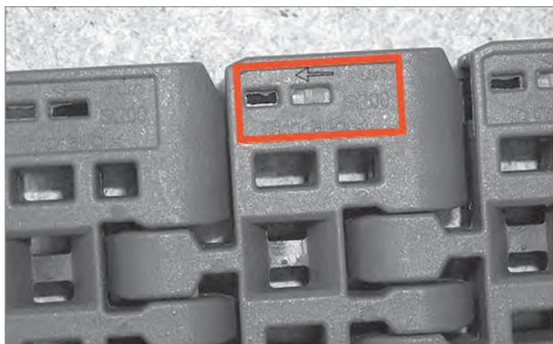
Figura 155: Direzione di scorrimento del nastro
