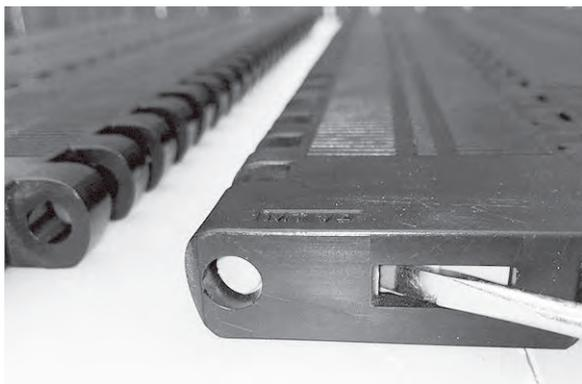
Figura 210: Utilizzare un cacciavite per chiudere lo Slidelox
