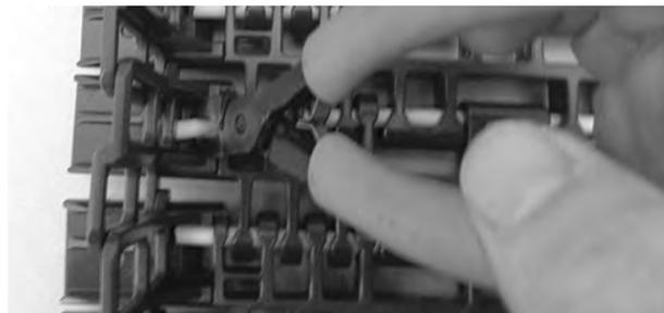
**Figura 372:** Spingere il perno oltre il dispositivo di ritenzione
