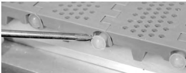
**Figura 64:** Spingere il perno nel nastro
