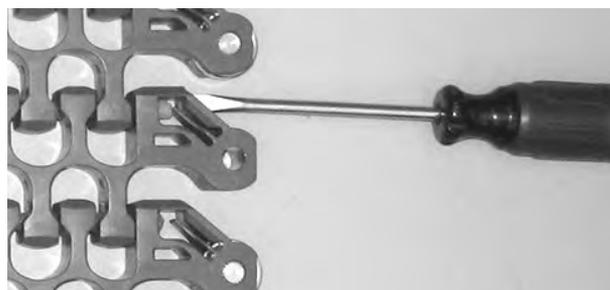
Figura 285: Aprire il dispositivo di ritenzione
