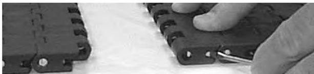
Figura 161: Utilizzare un cacciavite per chiudere lo Slidelox
