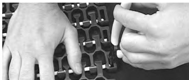
**Figura 314:** Spingere il perno nel nastro
