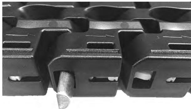
**Figura 200:** Inserimento del perno
