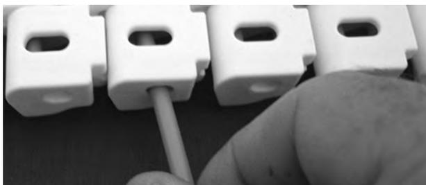
**Figura 287:** Inserire il perno nelle cerniere
