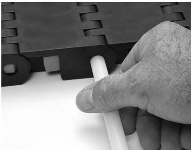
**Figura 266:** Inserimento del perno
