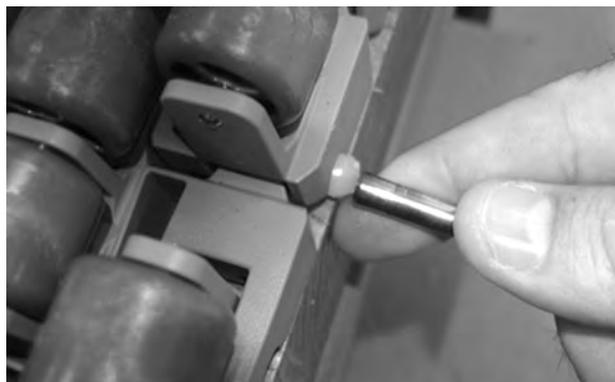
Figura 191: Spingere il perno oltre il dispositivo di ritenzione
