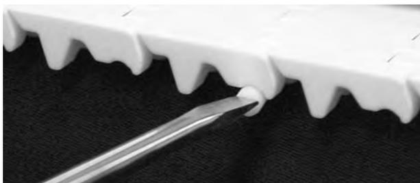
**Figura 175:** Spingere il perno oltre il dispositivo di ritenzione
