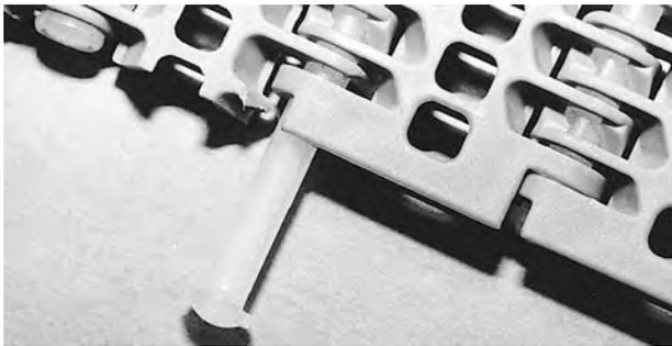
**Figura 34:** Inserimento del perno
