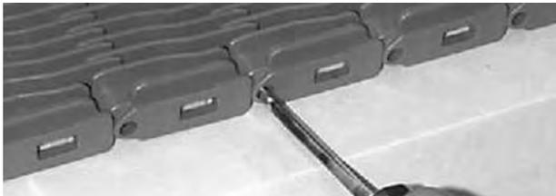
**Figura 50:** Allontanare il perno dal nastro
