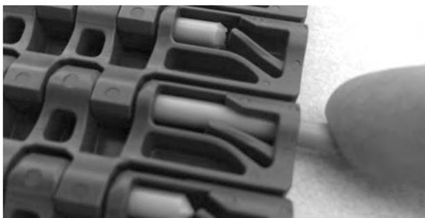
**Figura 128:** Inserire il perno nella cerniera
