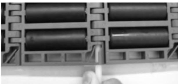
**Figura 237:** Inserire il perno nelle cerniere
