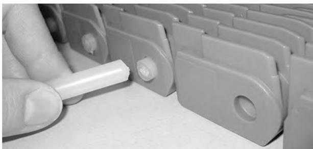
**Figura 217:** Spingere il perno oltre lo Shuttleplug
