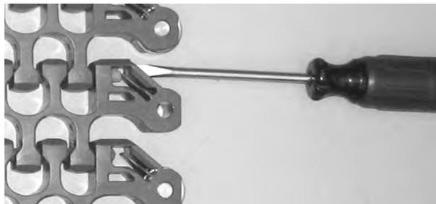
Figura 303: Aprire il dispositivo di ritenzione
