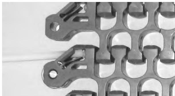
Figura 286: Allontanare il perno dal nastro
