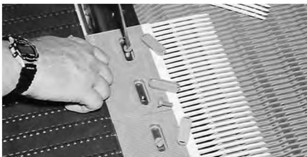
**Figura 24:** Installare i pettini di trasferimento utilizzando i bulloni in plastica Intralox
