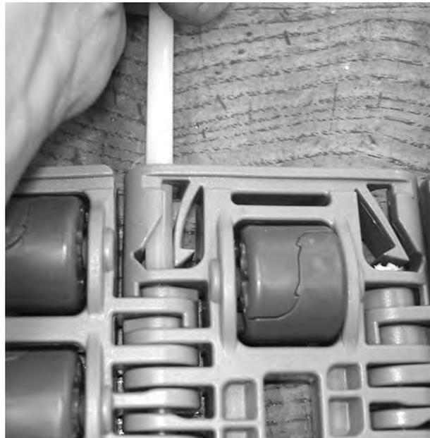
Figura 222: Allontanare il perno dal nastro
