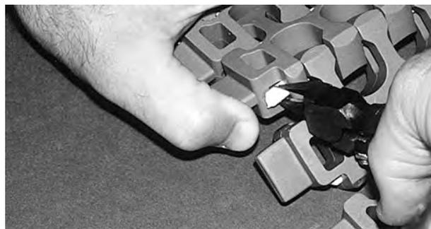
Figura 278: Liberare il perno dal dispositivo di ritenzione
