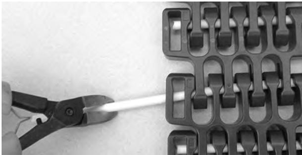
**Figura 322:** Estrazione del perno dal nastro
