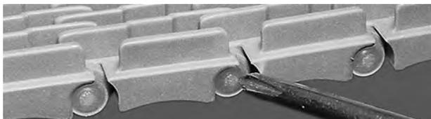
Figura 29: Assicurarsi che la testa del perno superi il dispositivo di ritenzione a scatto
