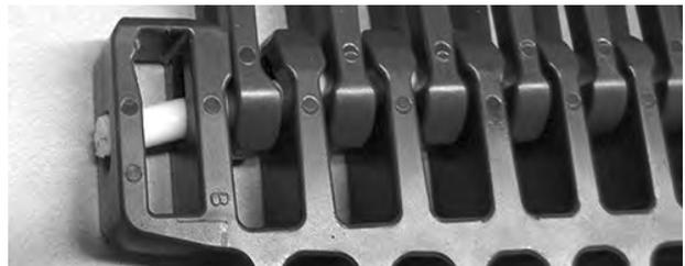
**Figura 336:** Inserire il perno nelle cerniere
