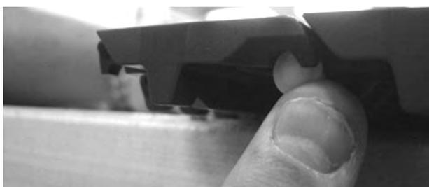
**Figura 70:** Spingere il perno oltre il dispositivo di ritenzione
