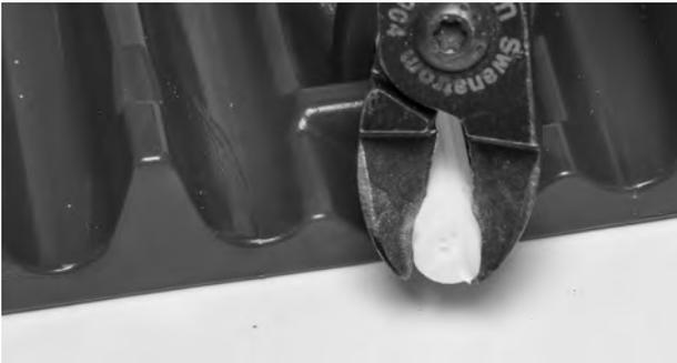
**Figura 97:** Estrazione del perno dal nastro
