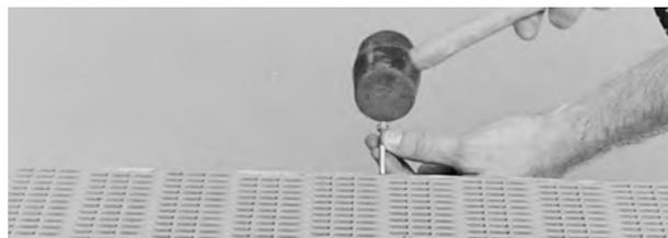
Figura 38: Allontanare il perno dal nastro
