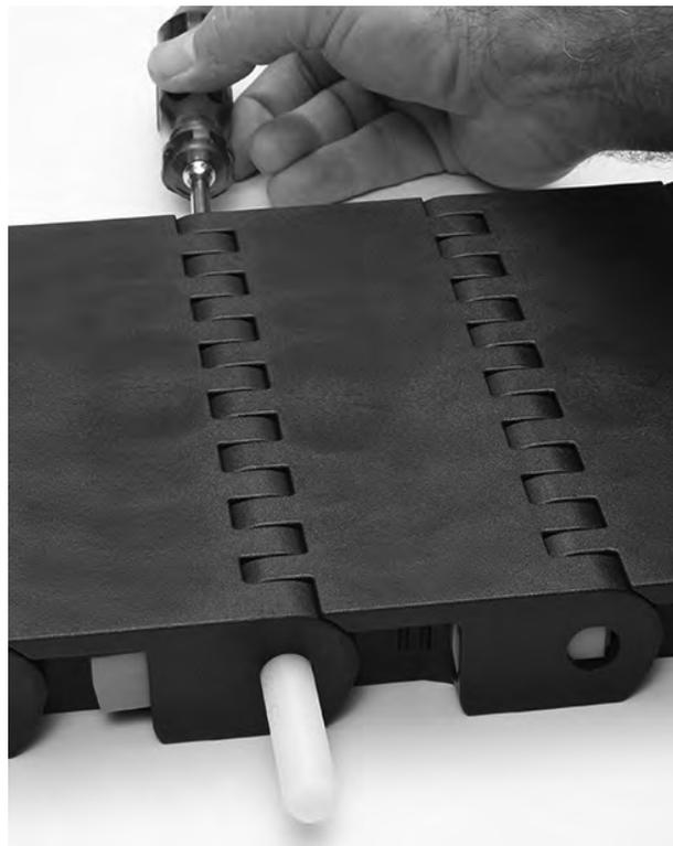
**Figura 268:** Allontanare il perno dal nastro
