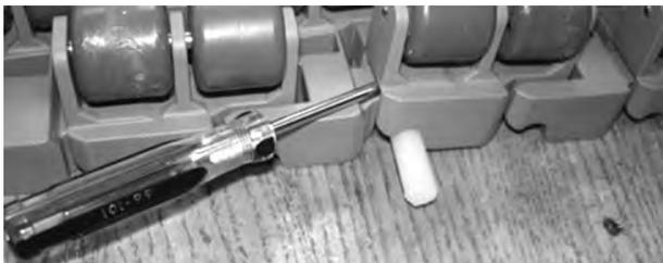
**Figura 196:** Estrazione del perno dal nastro
