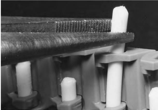
**Figura 150:** Estrazione del perno dal nastro
