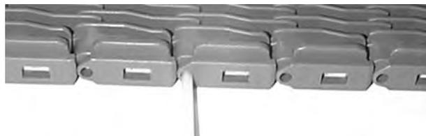
**Figura 47:** Inserimento del perno
