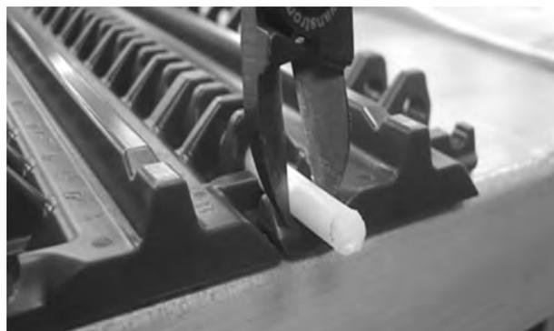
**Figura 73:** Estrazione del perno dal nastro
