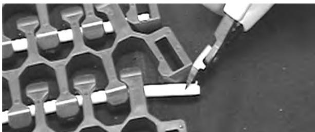
**Figura 317:** Estrazione del perno dal nastro
