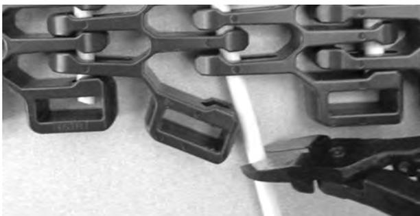
**Figura 334:** Estrazione del perno dal nastro
