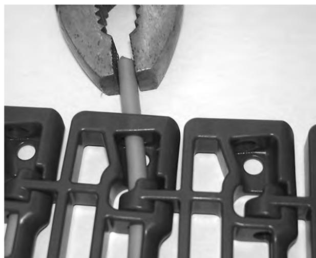
**Figura 123:** Estrazione del perno dal nastro
