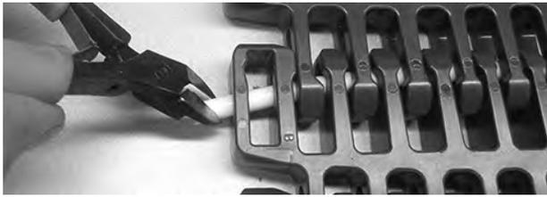
**Figura 339:** Estrazione del perno dal nastro
