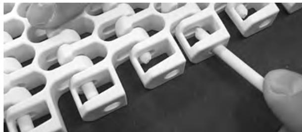
**Figura 292:** Inserire il perno nelle cerniere
