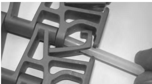
**Figura 251:** Inserire il perno nelle cerniere
