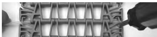
**Figura 255:** Allontanare il perno dal nastro
