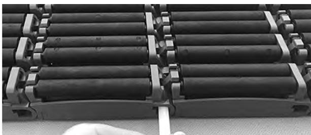
**Figura 241:** Inserire il perno nelle cerniere
