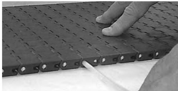
Figura 162: Inserimento del perno
