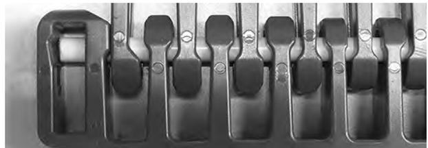
**Figura 337:** Assicurarsi che il perno sia inserito oltre il dispositivo di ritenzione
