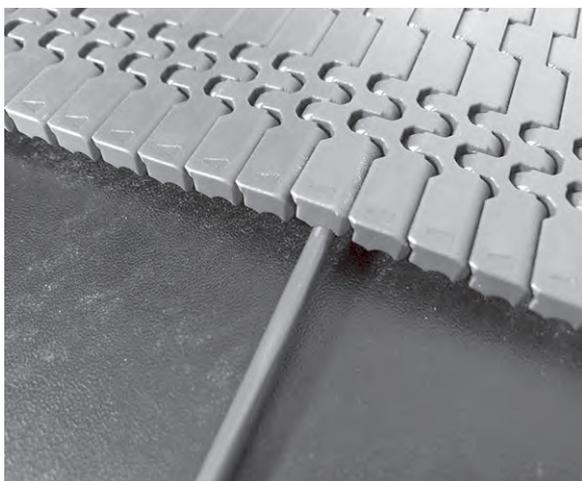
**Figura 59:** Inserimento del perno
