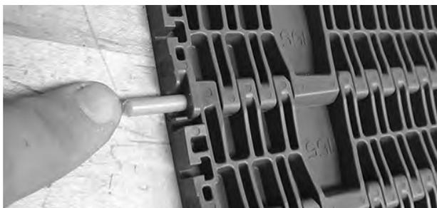
**Figura 271:** Inserimento del perno
