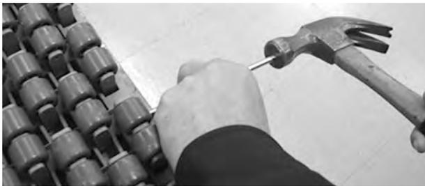
**Figura 195:** Allontanare il perno dal nastro
