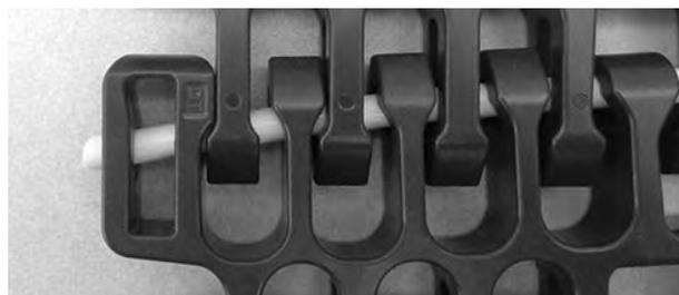
**Figura 319:** Spingere il perno oltre il dispositivo di ritenzione
