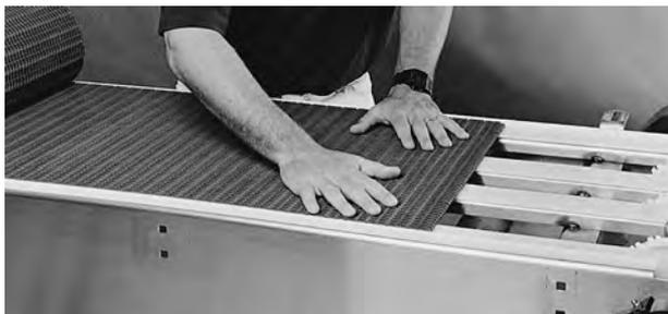
**Figura 14:** Far scorrere il nastro dall'estremità di azionamento
