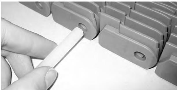
**Figura 216:** Inserire il perno nelle cerniere
