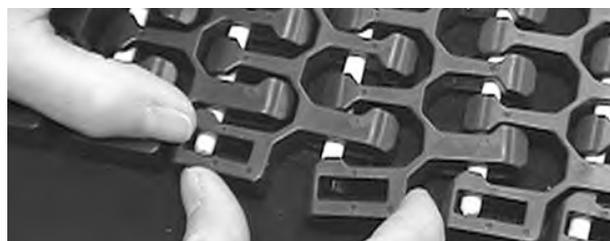
**Figura 312:** Spingere il perno oltre il bordo del nastro, far scattare il bordo a filo oltre il perno
