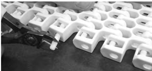
**Figura 296:** Estrazione del perno dal nastro
