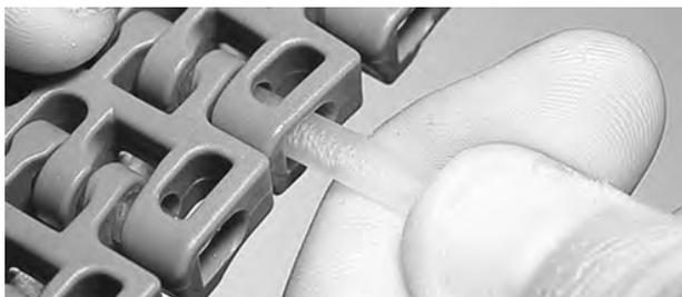
**Figura 145:** Inserire il perno nelle cerniere
