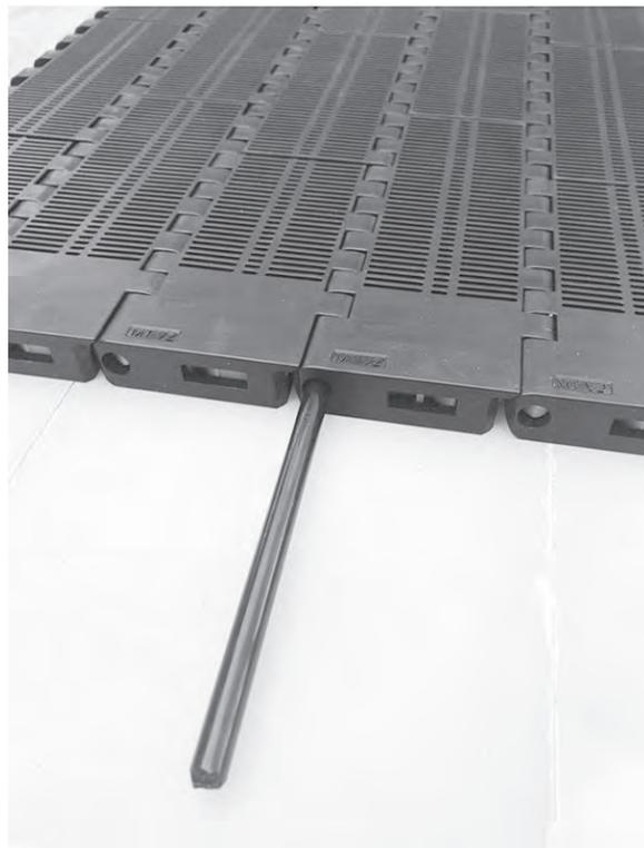
Figura 211: Inserimento del perno
