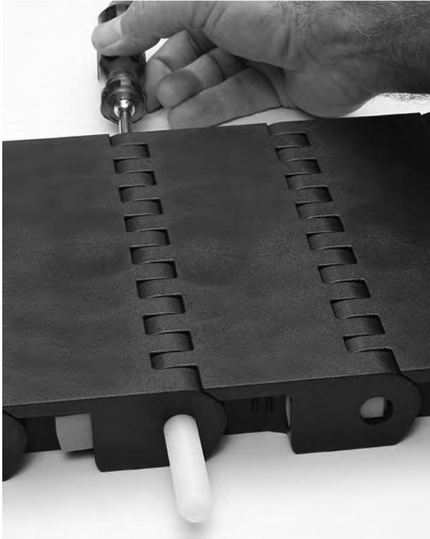
**Figura 264:** Allontanare il perno dal nastro
