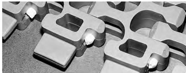
Figura 277: Assicurarsi che il perno sia inserito completamente
