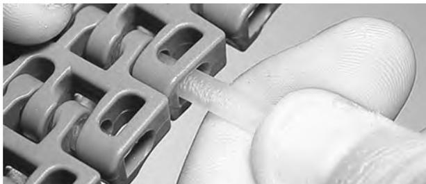
**Figura 136:** Inserire il perno nelle cerniere
