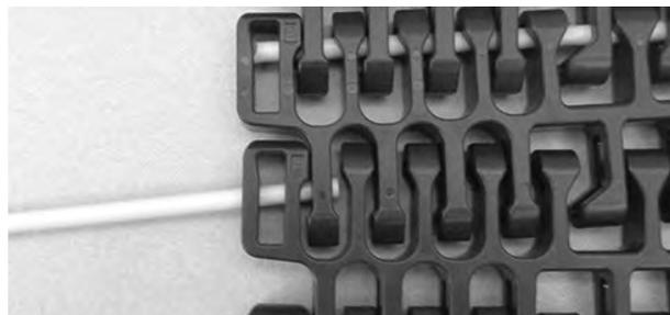
**Figura 318:** Inserimento del perno
