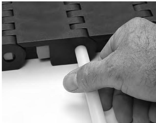
**Figura 263:** Inserimento del perno
