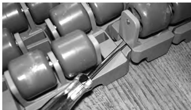
Figura 193: Inserire il cacciavite sotto il rullo
